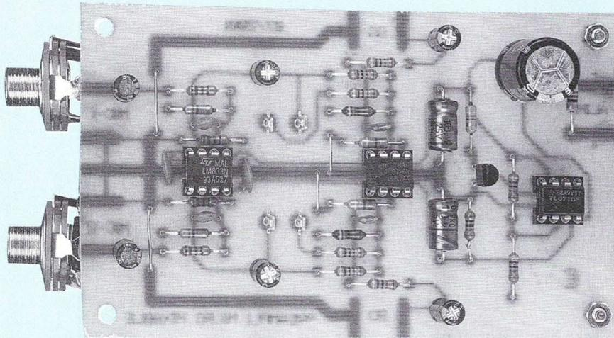
Les appareils audio du commerce sont rarement munis d'une entrée micro dynamique, ce qui fait que l'on ne peut guère utiliser un microphone si l'on ne dispose pas d'une table de mixage. En reliant le module que nous allons décrire ici sur une entrée haut niveau de votre installation audio, vous disposerez de deux entrées micros.
