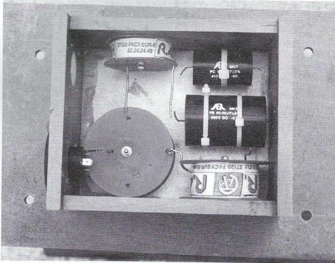
Photo 2 : filtre complet et câblé
