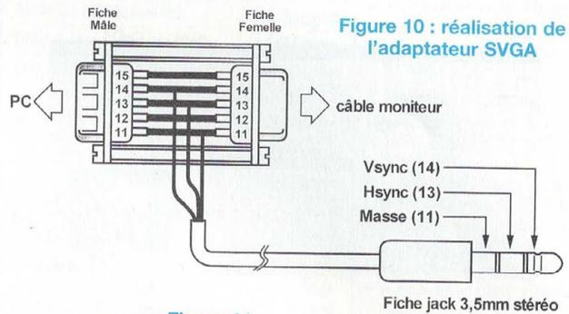
Figure 10 : réalisation de l'adaptateur SVGA
