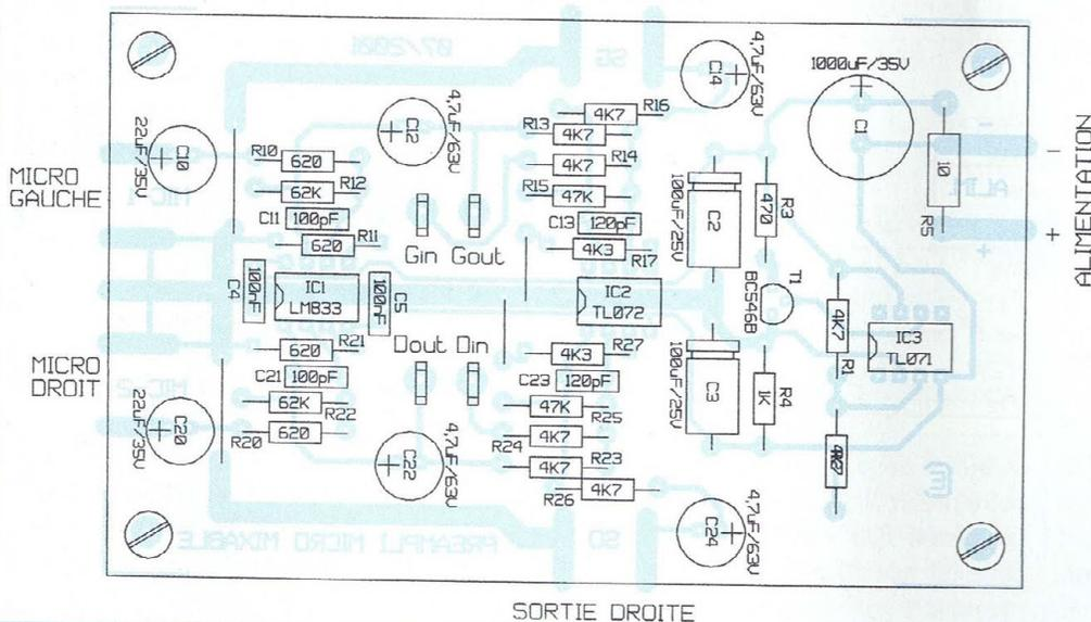
L'implantation des composants fait l'objet de la figure 3. On commencera de préférence par placer et souder les trois supports de circuits intégrés, puis les résistances et les straps, au nombre de quatre. On implantera ensuite les condensateurs, en respectant leur orientation pour les chimiques. On finira par le transistor T1, et le condensateur C1.
