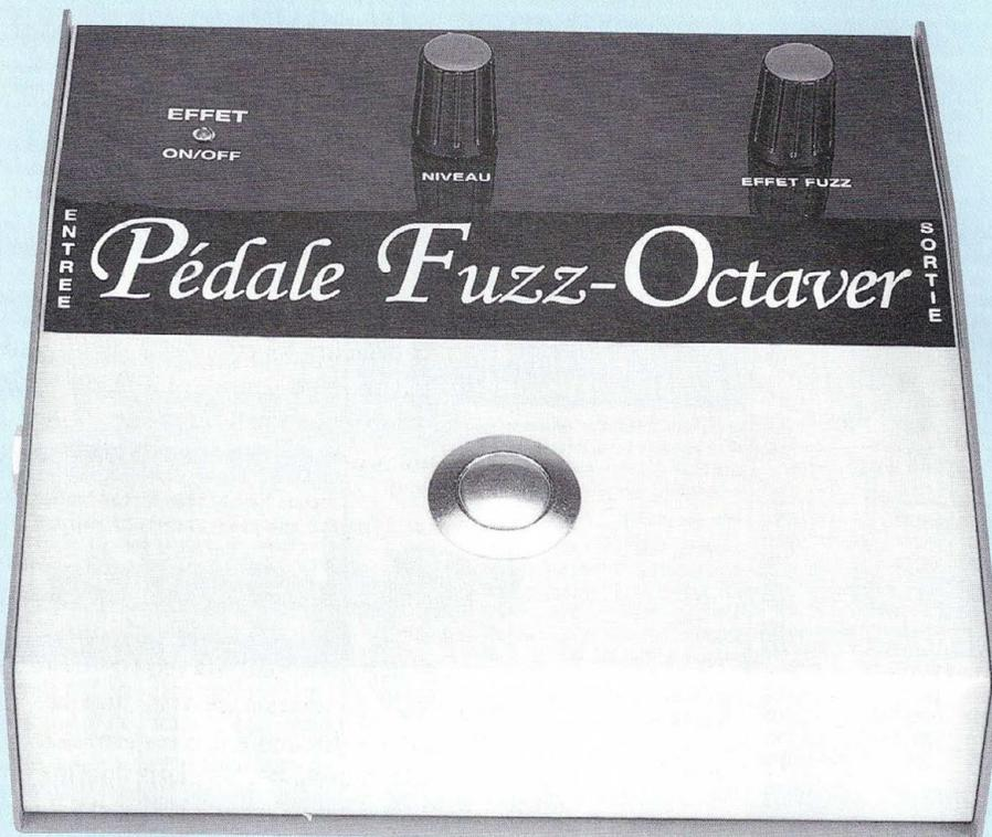
Le numéro 165 de Led vous proposait une pédale Overdrive, dont la saturation était progressive. Cette fois, nous nous adressons aux adeptes de la saturation massive, avec une réalisation résolument orientée «hard rock». Avec le gain au maximum, la distorsion pourra atteindre une profondeur assurant aux accords à deux cordes un son suffisamment gras. Le doubleur de fréquence, plutôt destiné aux accords bloqués, garantit un son très riche en harmoniques.
