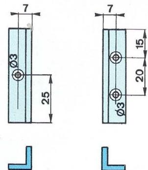
Les trois forages à  $\varnothing 3$  mm vont permettre d'y fixer une équerre en «L» de 12x12 mm de côté pour 230 mm de long. La **figure 7** précise le travail à effectuer. Bien respecter la position des «L».
