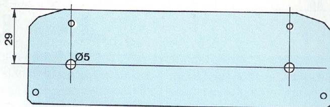
Disons simplement qu'il suffit de tracer une ligne centrale de bas en haut à l'intérieur du dissipateur et que la fixation du premier boîtier se fait à 30 mm du bas. A partir de cette distance, on peut définir avec le mica les 3 autres forages. Le deuxième boîtier est fixé à 90 mm du bas, le mica aide ensuite au repérage des 3 autres forages.
