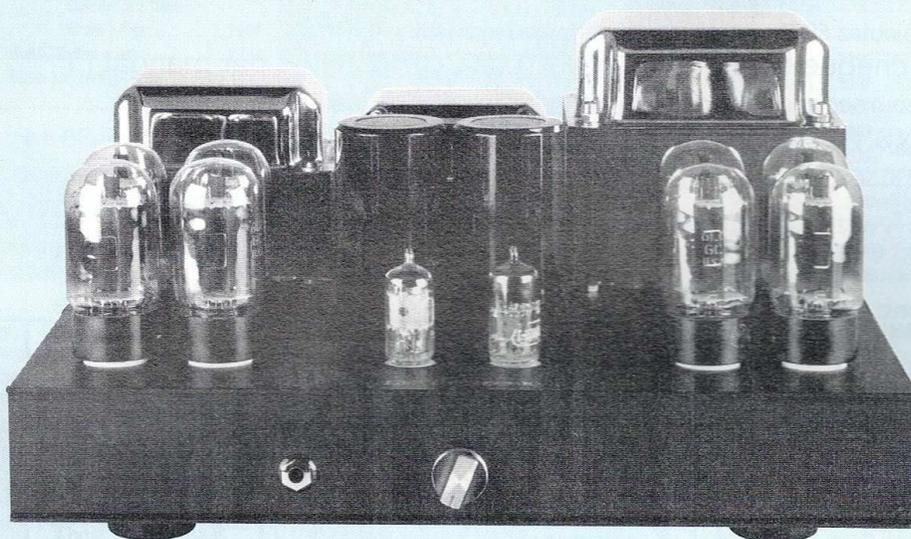
Le bloc de puissance que nous vous proposons de construire peut tout aussi bien driver une enceinte Hi-Fi qu'une enceinte de sonorisation. A une telle puissance, il ne faut plus songer à polariser les grilles des tubes de sortie en chargeant leurs cathodes par des réseaux R-C. Une polarisation négative directe des grilles s'impose, ce qui fait descendre la consommation au repos et évite ainsi aux transformateurs (alimentation et sortie) de se transformer en plaques chauffantes.
