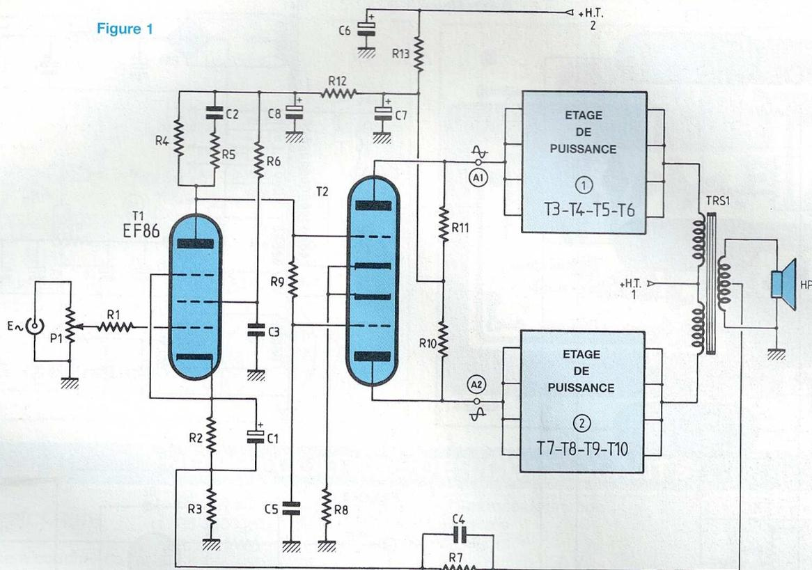
Le réseau R2/C1 est connecté à la masse au travers d'une résistance de faible valeur R3. C'est aux bornes de R3 qu'est reliée la cellule de contre-réaction R7/C4. Côté haute tension, l'EF86 est alimentée au travers d'une cellule de filtrage en  $\pi$  composée des éléments C7/R12/C8. Le grand gain en tension de cet étage d'entrée nous oblige à être très prudent afin de neutraliser tout bruit parasite (souffle, ronflette...).
