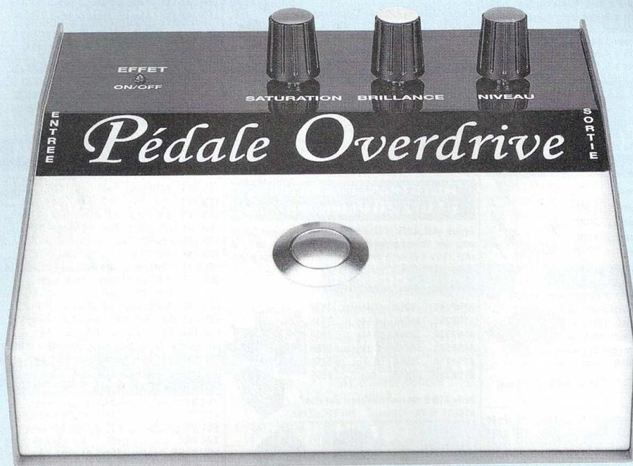
L'OVERDRIVE génère un son qui n'est pas sans rappeler la saturation progressive délivrée par les amplificateurs à lampes. L'effet est donc différent de l'écrêtage qui est obtenu avec les pédales de distorsion classiques, ou encore de la saturation brute et massive des pédales du genre «Heavy-métal». Un réglage de tonalité garantit une saturation homogène à toutes les fréquences et un son riche en harmoniques.
