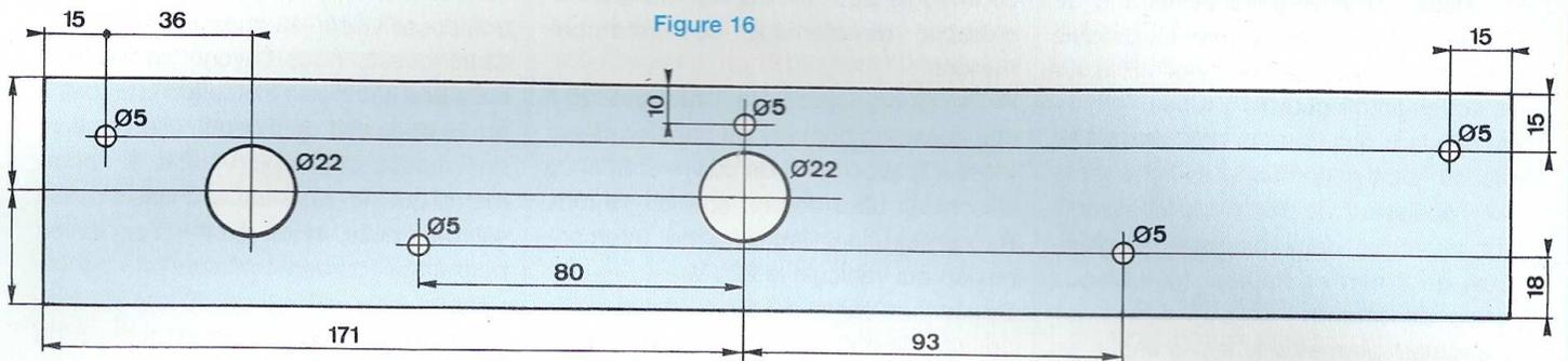
Les 4 forages à  $\varnothing 3$  sont à prévoir pour des vis à tête fraisée
