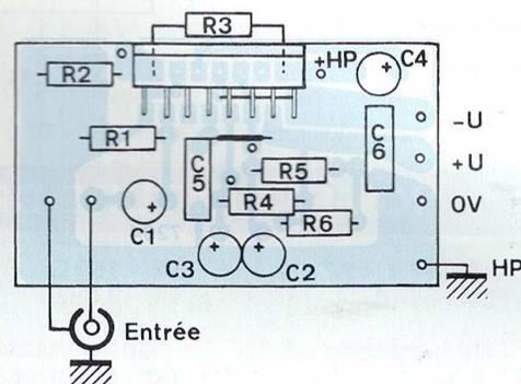
Son boîtier Multiwatt 15 est plus délicat à travailler au niveau implantation que celui du TDA1514 (15 broches en quinconce). Il peut fonctionner dans une plage de tensions allant de  $\pm 10$  V à  $\pm 40$  V.
