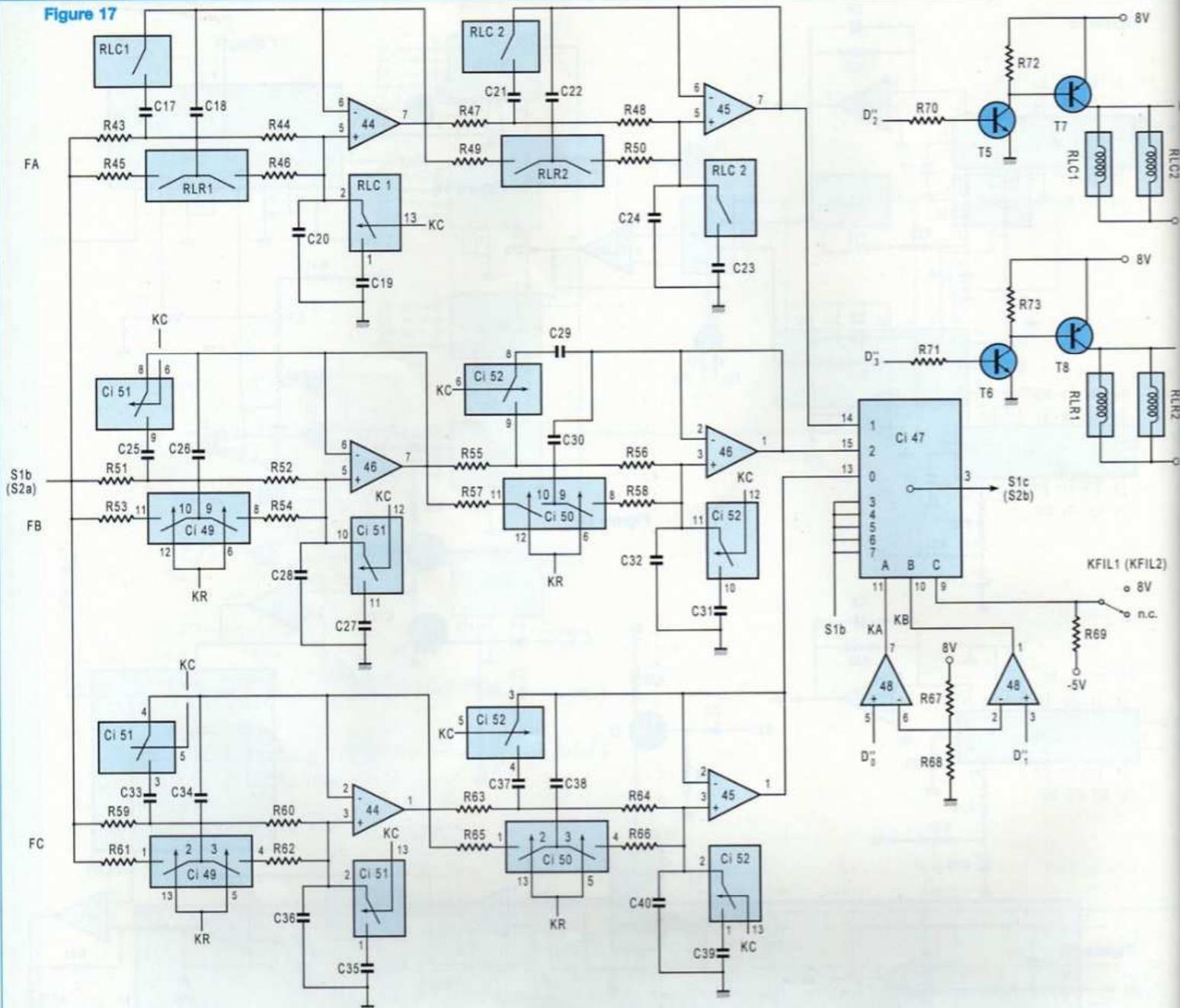
un courant de sortie borne 4 égal à :  $I_0 n / 256$ . Sur la figure,  $n = 156$ . On utilise donc trois DAC08, selon la figure 13. Les courants d'entrée sont obtenus à partir du 5 V avec un filtrage sévère indispensable. Les courants de sortie sont convertis en tensions avec des AOP, et un filtrage léger pour les commutations. Les sorties obtenues, positives, sont S1a, S2a, et V0. S1b reproduit S1a en fréquences fixes,
