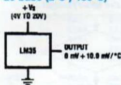
Figure 3b : montage assurant la pleine échelle de mesure
