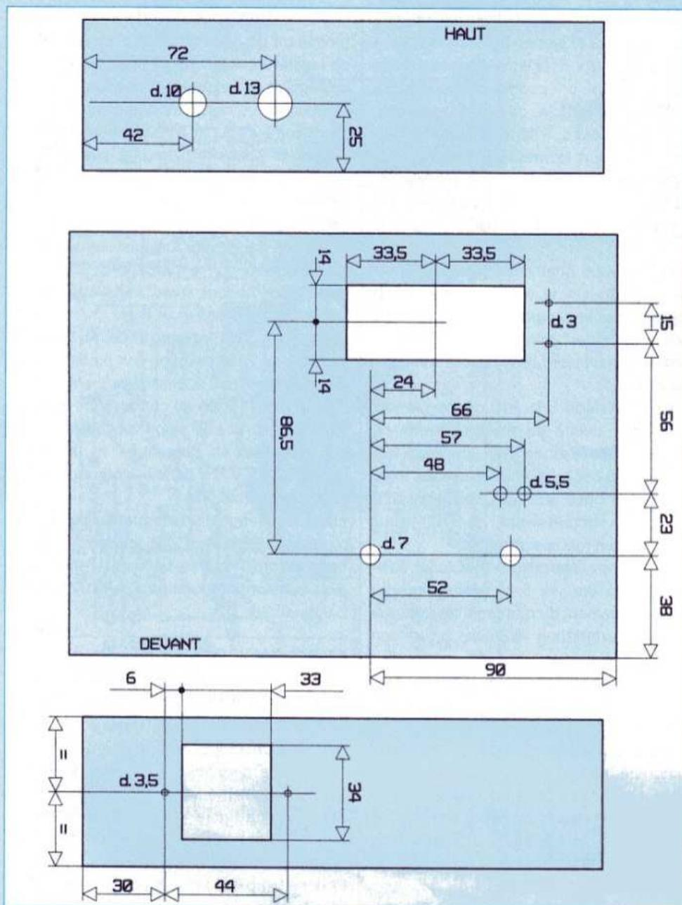
de 5,5 mm juste au dessus des vis de réglages des deux potentiomètres. La fenêtre sera mise en place et «soudée» par derrière (en faisant fondre le plastique à l'aide d'un fer à souder). Le filtre de plexiglass rouge sera ensuite collé par quelques points de cyanolite. On installera alors la carte qui sera fixée d'un côté par les inverseurs S1 et S2, et de l'autre par les tiges filetées livrées avec la fenêtre.
