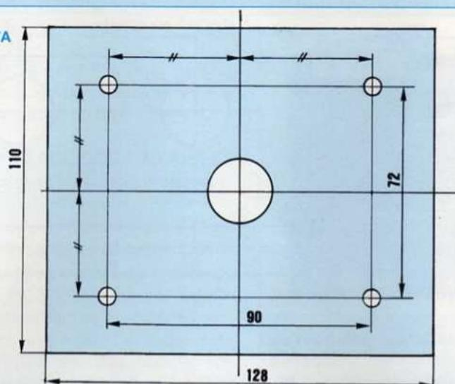
de puissance de cathodes des 845. Si tous les trous coïncident, signe d'un travail de précision, bloquer les 4 vis, sinon agrandir.
