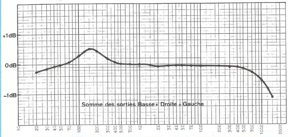
pement des trois filtres : celui des basses «monte» à 185,6 Hz alors que les deux autres «descendent» à 162,6 Hz et à 172,7 Hz.
