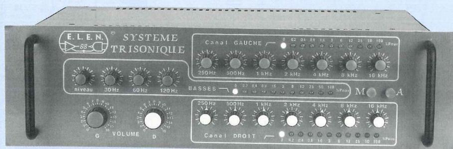
**C**ette réalisation se compose d'un amplificateur triphonique intégrant 3 modules de puissance, dont un spécialement pour les basses, les filtres actifs associés, un égaliseur octave par octave ainsi qu'un vu-mètre de précision à Leds, un caisson de basses et deux enceintes satellites. L'accent a été mis sur la fiabilité et la robustesse (l'amplificateur s'arrête automatiquement en cas de surcharges) et l'ensemble a déjà largement fait ses preuves des nuits entières sans aucune défaillance.
