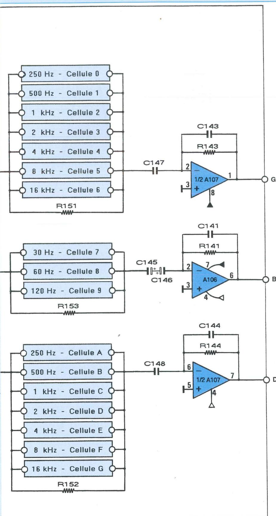
opère sur trois fréquences distantes chacune d'une octave : 30 Hz, 60 Hz et 120 Hz. Les cellules qui le composent, détaillées en haut à gauche de la figure 2 ne diffèrent que par la valeur des condensateurs. Ces condensateurs, dont la valeur doit être précise, sont constitués par des ensembles de deux éléments mis en parallèle ou en série suivant la cellule. Le petit tableau indique les numéros de broches des amplis-op. utilisés.
