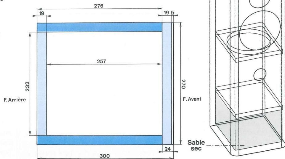
neaux destinés à être vissés (voir figure 5). L'assemblage des panneaux est indiqué en figure 6. Il est effectué en encollant largement les chants à l'aide d'une colle blanche et en utilisant des vis type VBA 4 x 40.
