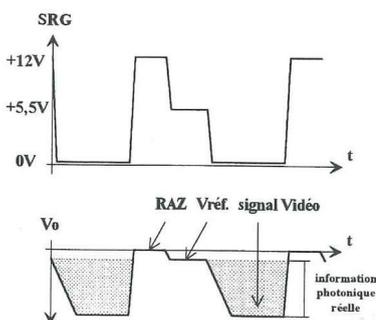
figure 8. Il reste donc 324 pixels photosensibles sur chaque ligne de la zone image, suivis d'un pixel inactif utilisé en barrière de potentiel. La dernière ligne active de la matrice est
