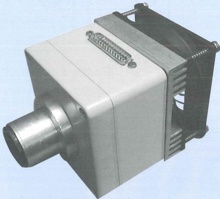
**E**ffectivement, notre caméra ne sera pas autonome, car pilotée obligatoirement par ordinateur. En outre, la cadence des images dépendra de la solution utilisée pour interfacier la caméra avec le PC. A titre d'exemple, on obtiendra environ une image par seconde pour un TC255 connecté au port imprimante, comme l'indique le **tableau 1** qui permet de comparer diverses possibilités. Le goulot d'étranglement est matérialisé par le port ISA du PC qui ne permet pas une cadence éle-
