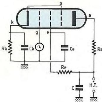
a) A un potentiel positif voisin de celui de l'anode, il accélère les électrons émis par la cathode.
