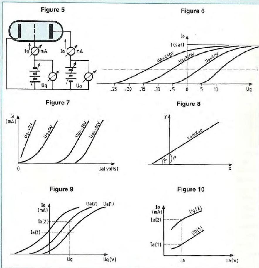
$U_g$  = potentiel de la grille par rapport au potentiel de la cathode (en volts). Voir fig 5.
