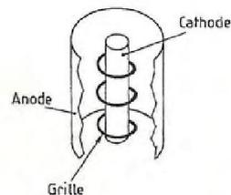
lampe vide d'air, dans laquelle nous disposons une cathode, dans son axe, entourée d'une **anode** (ou plaque). Nous insérons un Milli-ampèremètre dans le circuit d'alimentation variable anode/cathode, selon le dessin fig 2, (tension variable de 0 V à 250 V).
