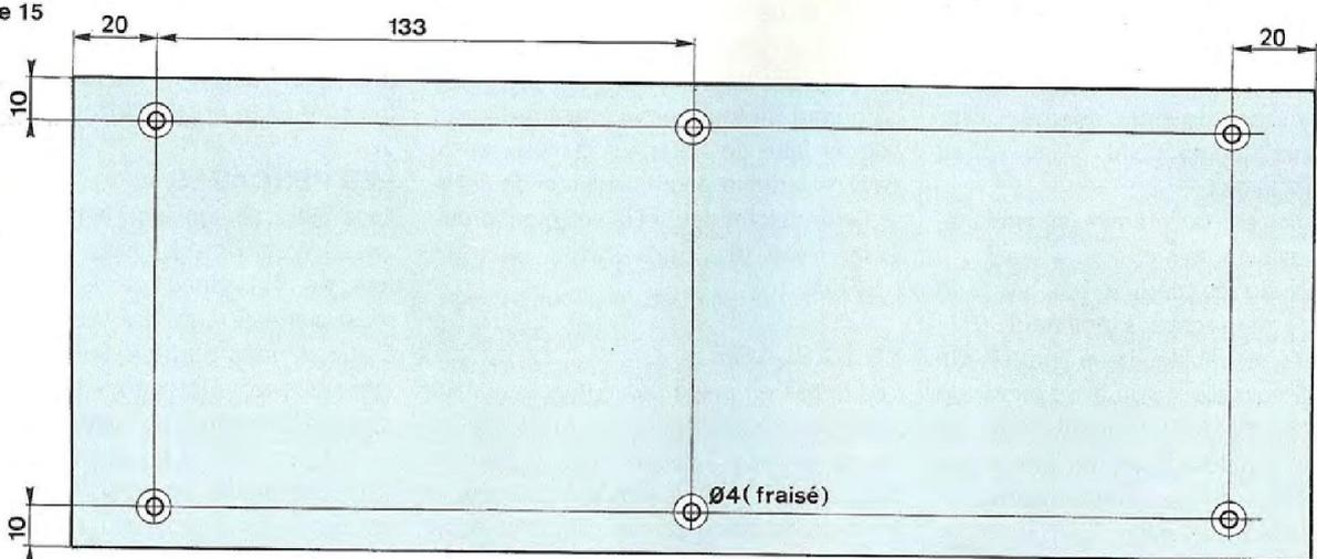
Les perçages doivent, quant à eux, être menés avec un foret de  $\varnothing 2,5$  mm sur une profondeur de 10 mm. Après cela, introduire une goutte d'huile dans chacun d'eux et tarauder ces quatre trous à  $\varnothing 3$  mm. De cette manière, le travail de
