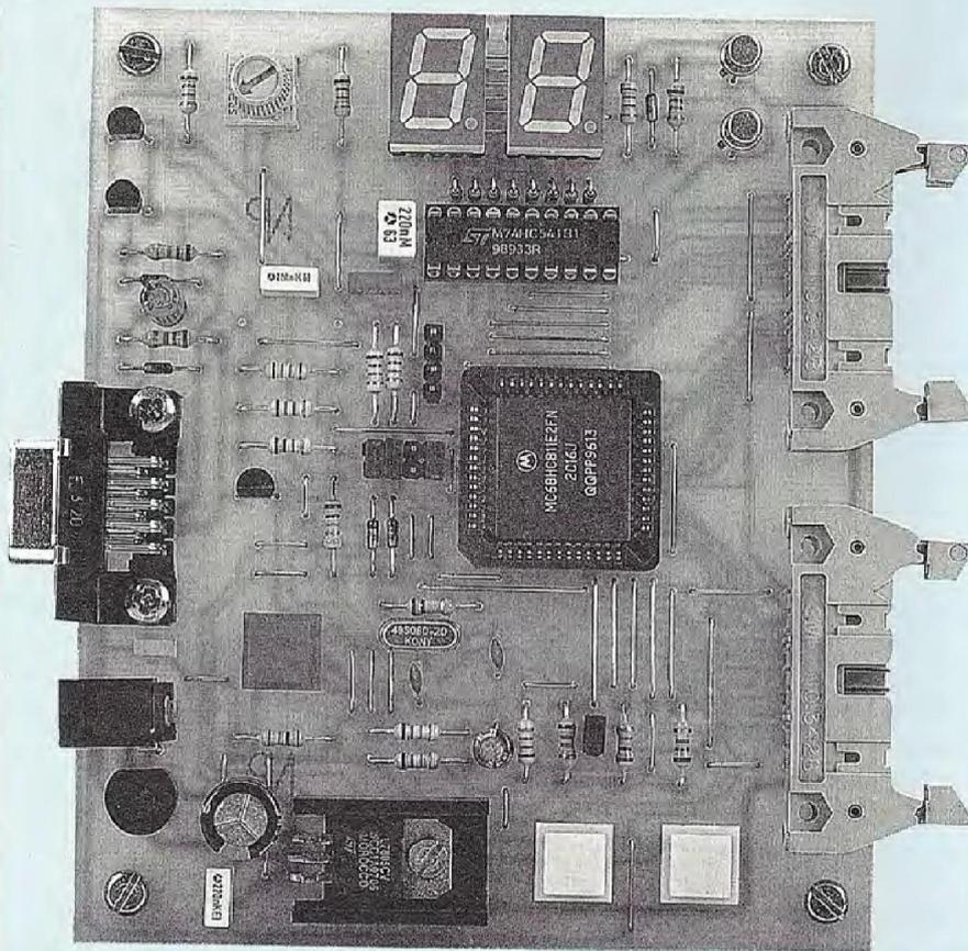
**A**ssocié à un microcontrôleur du type 68HC811E2 (doté de 2 Ko d'EEPROM), le kit de développement a donc intérêt à être équipé d'un module LCD. Le port d'extension doté des ports A et B permettra d'effectuer une connexion autonome avec l'afficheur,
