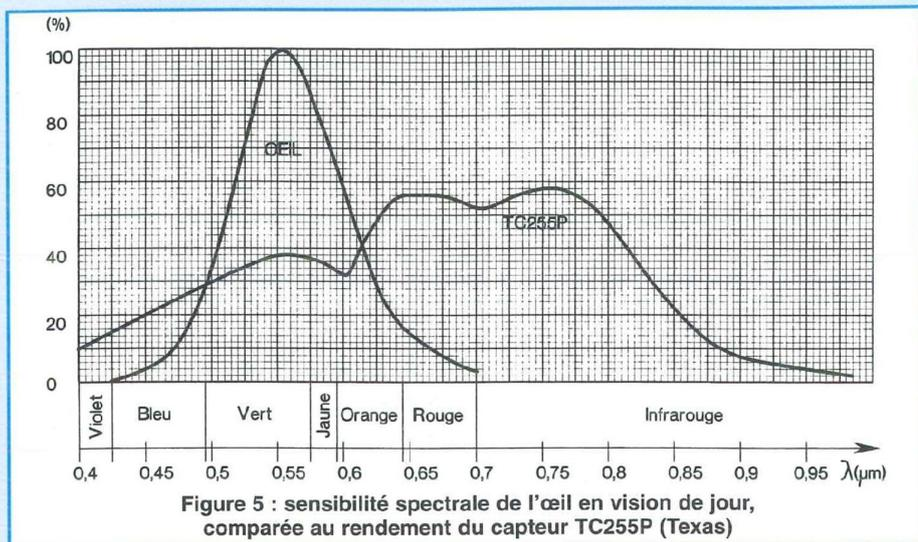
ment de la longueur d'onde des photons incidents, et évolue entre 10 % et 60 % pour la plupart des détecteurs CCD, avec le rendement maximal centré autour de 700 nm (cette longueur d'onde correspond au rouge, comme l'indique le diagramme de la figure 5). Toutefois, ce paramètre est à comparer avec le rendement quantique des films photographiques, qui est compris entre 2 % et 5 % dans le meilleur des cas.
