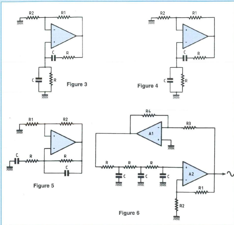
Par contre, le montage de la figure 5, également interprété en atténuateur apériodique de gain 2/3 et ampli sélectif, fonctionne très bien. L'ampoule à incandescence doit être R2.
