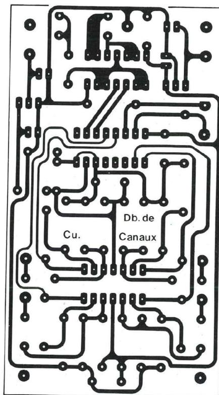
Fig. 4 : Implantation et tracé des pistes.
