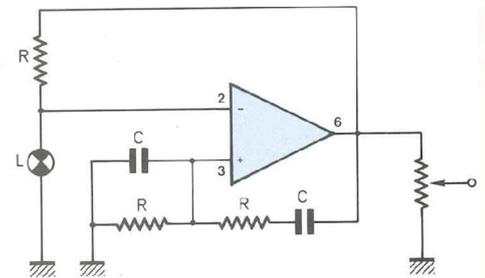
**Fig. 2 :** Mise en application du cours n° 13 de M. Matoré sur les quadripôles sélectifs. La lampe L permet d'obtenir une tension de sortie constante en amplitude en constituant un dispositif de C.A.G.
