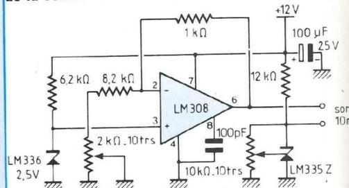
Fig. 12 : Circuit thermométrique à sortie Celsius. Sortie flottante.
