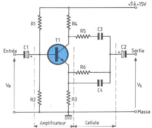
Fig. 2 : Schéma structural du filtre réjecteur.
