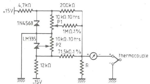
Fig. 17 : Thermocouple référencé par rapport à la masse.
