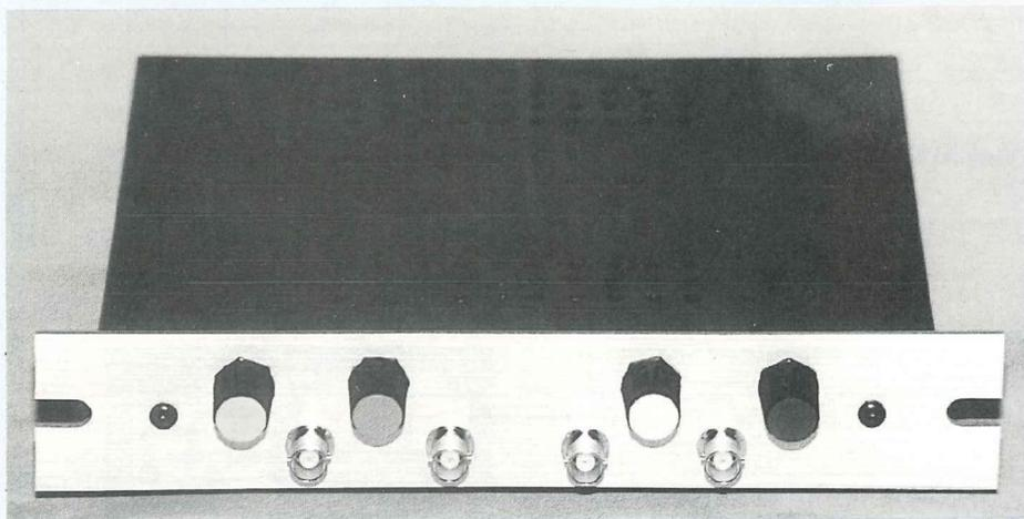
Prévu initialement pour être utilisé avec Audiolab 06, le doubleur de canaux permet de visualiser simultanément 2 signaux sur un oscilloscope monocourbe et 4 signaux sur un oscilloscope double-trace.
