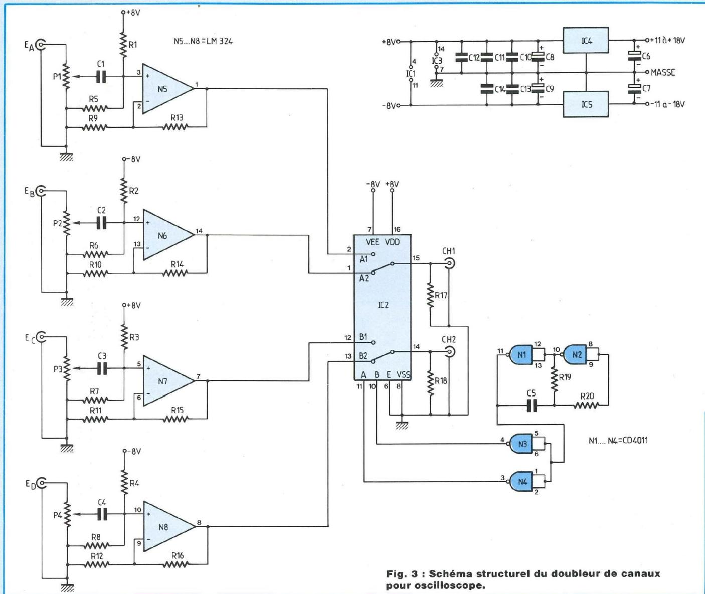
Fig. 3 : Schéma structurel du doubleur de canaux pour oscilloscope.
