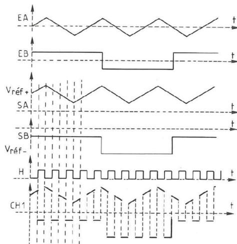
Fig. 2 : Chronogrammes de fonctionnement d'un canal.
