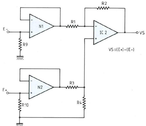
**Fig. 6 : Schéma structurel du soustracteur de mesure.**
