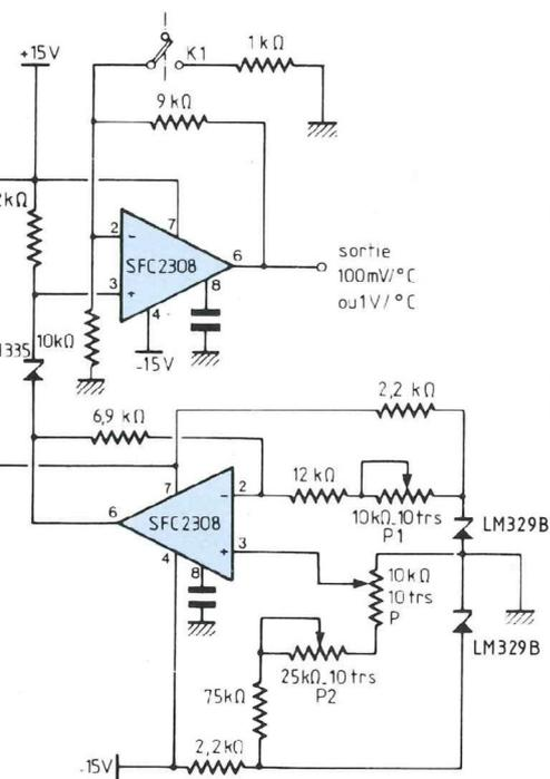
Fig. 22 : Circuit à offset variable, sortie Celsius.
