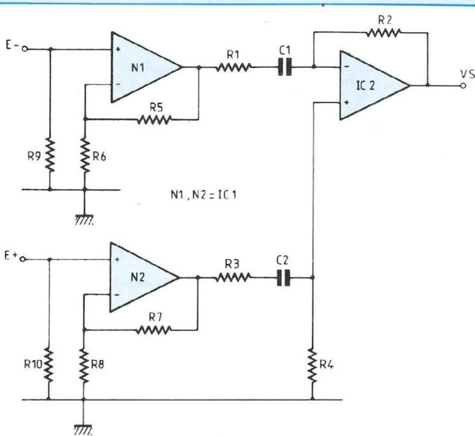
Fig. 2 : Schéma structurel du préamplificateur différentiel.
