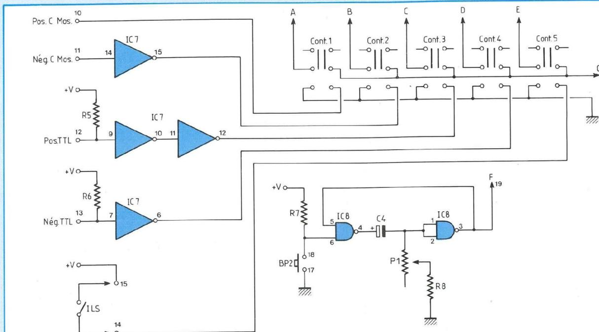
Fig. 3 : Schéma de principe : circuit contacteurs.
