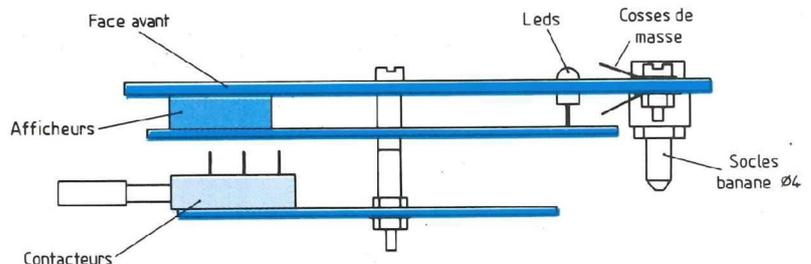
Fig. 13 : Montage des circuits sur la face avant.
