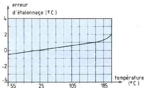
**Fig. 4 : Erreur d'étalonnage en fonction de la température.**
