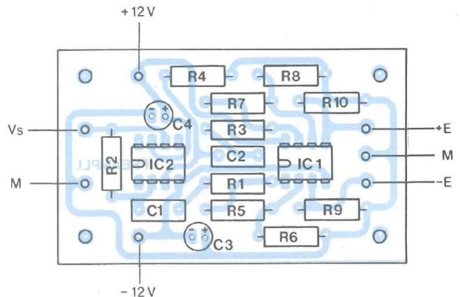
Fig. 4 : Implantation et tracé des pistes du préampli.
