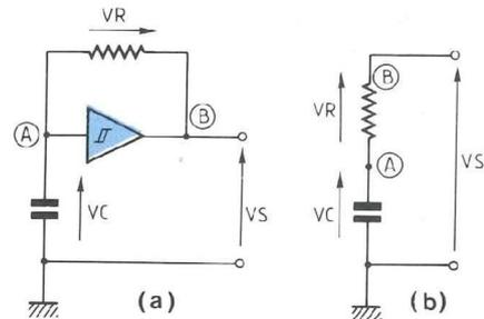
Fig. 8 : Astable à 1 porte trigger.
