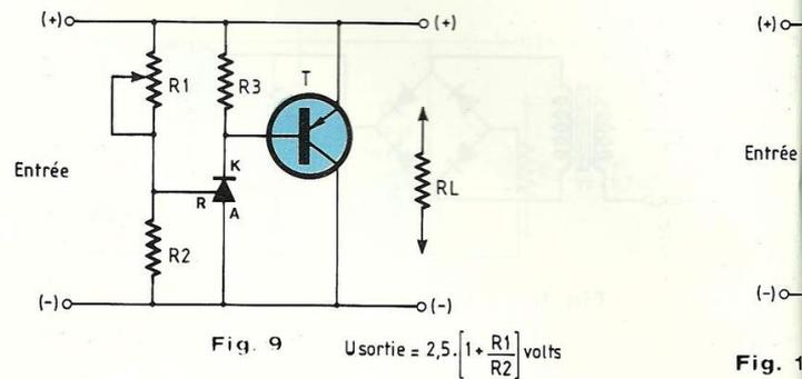
La tension de commande (de 2,5 volts) est conditionnée à l'aide d'un pont diviseur (R1, R2) et ce pont diviseur fixe la tension sortie stabilisée du régulateur shunt...
