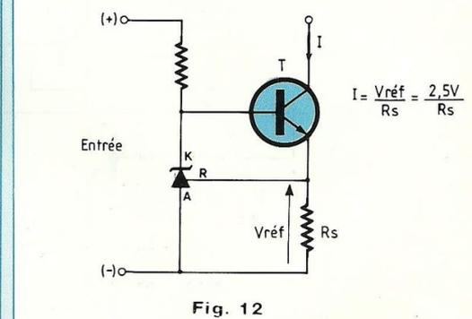
la conduction du transistor ballast T lorsque l'intensité du courant délivré crée, dans la résistance Rp, la chute de tension des 2,5 volts de la tension de référence...
