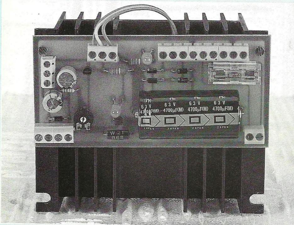
Les propriétés de la diode de Zener programmable, ou régulateur de tension shunt ajustable, connaissent d'intéressantes applications. En voici une, sous la forme d'une alimentation stabilisée, de tension variable, très performante, au prix de revient particulièrement avantageux.
