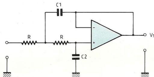
**Fig. 2B : Filtre passe-bas à f<sub>c</sub> fixe.**
