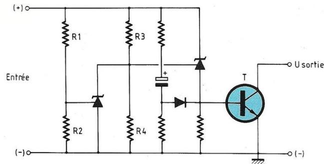
Fig. 11 Test conducteur pour seuil inférieur < U<sub>Entrée</sub> < seuil supérieur
