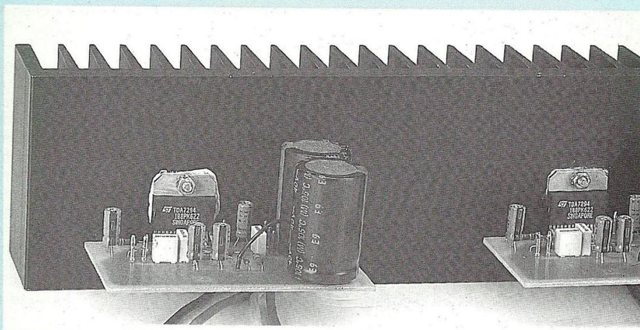
Le TDA7294 est un circuit intégré de puissance encapsulé dans un boîtier multiwatt 15 (15 broches) mis au point récemment par SGS-THOMSON pour des utilisations en tant que : amplificateurs audio Hi-Fi en classe A.B, enceintes amplifiées, sections basse-fréquence des téléviseurs haut de gamme.
