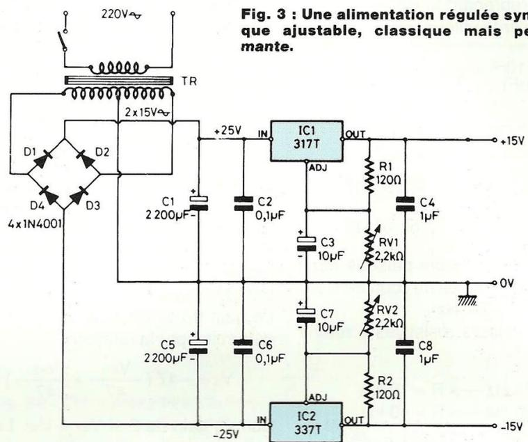
Fig. 3 : Une alimentation régulée symétrique ajustable, classique mais performante.
