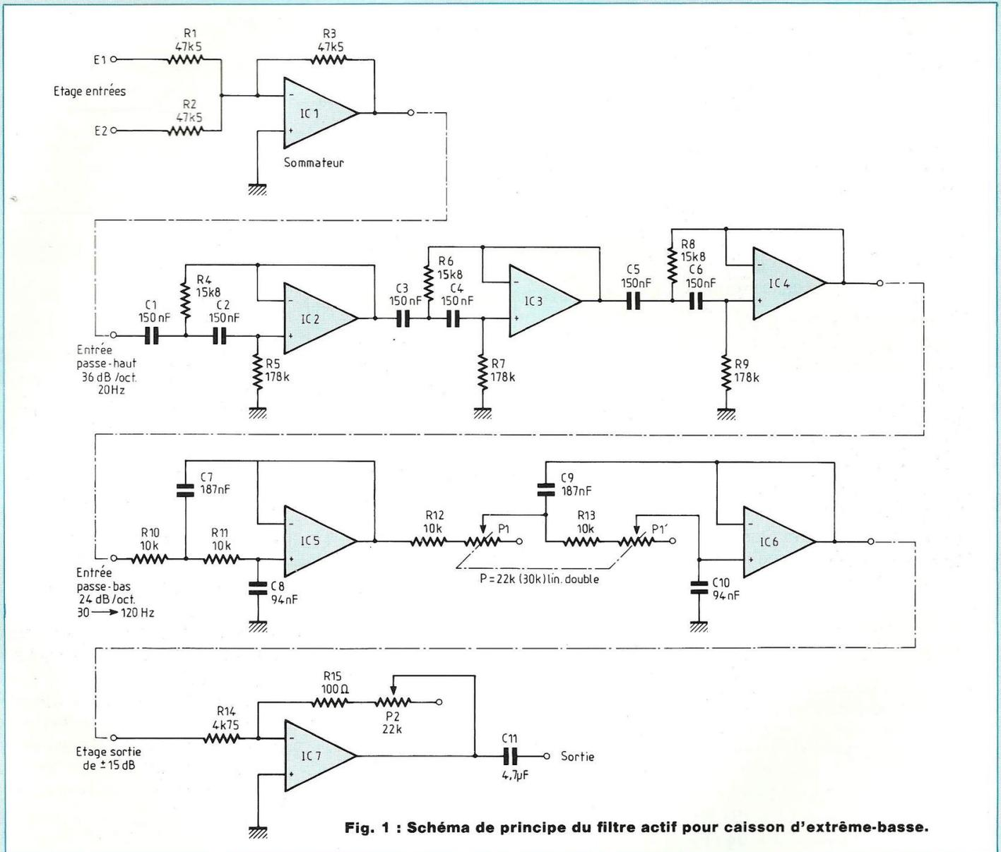
Fig. 1 : Schéma de principe du filtre actif pour caisson d'extrême-basse.
