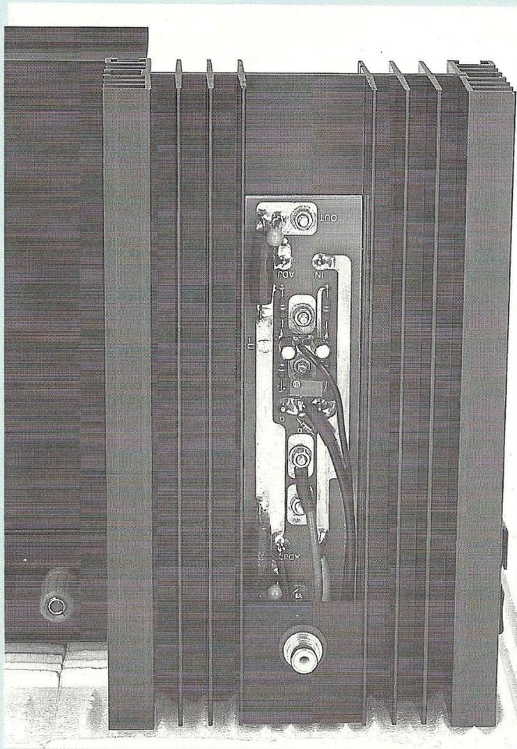
figurent pas sur le capot du coffret ESM pour une question de concordance des trous dans les deux plaques. Il suffit simplement de visser le coffret IDDM au capot ESM (vis centrales de  $\varnothing$  3 mm) et avec un crayon papier de repérer les 4 trous dans le capot. On obtient ainsi une excellente précision après perçages.
