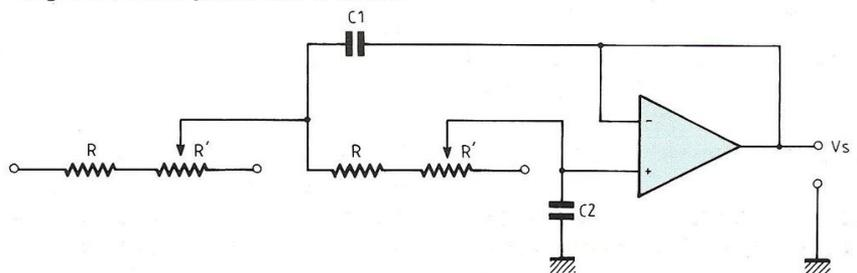
**Fig. 2C : Filtre passe-bas à f<sub>c</sub> variable.**
