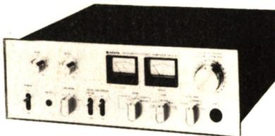
• Ampli stéréo SANYO DCA 611, puissance 2x65 watts, 2 vu-mètres contrôle, double monitoring. Filtres. Loudness. Sortie 2 ou 4 enceintes.
