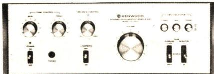
• Ampli stéréo KENWOOD KA 3700, puissance 2x25 watts. 3 entrées : Tape/Phono/Tuner. Filtrés. Loudness. Sorties 2 ou 4 enceintes.
