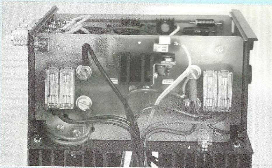
l'alimentation stabilisée à +20 V à partir du potentiel présent aux bornes du condensateur de 22 000  $\mu$ F et voisin de 50 V (valeur liée au secteur EDF, variable de 215 à 240 V).
