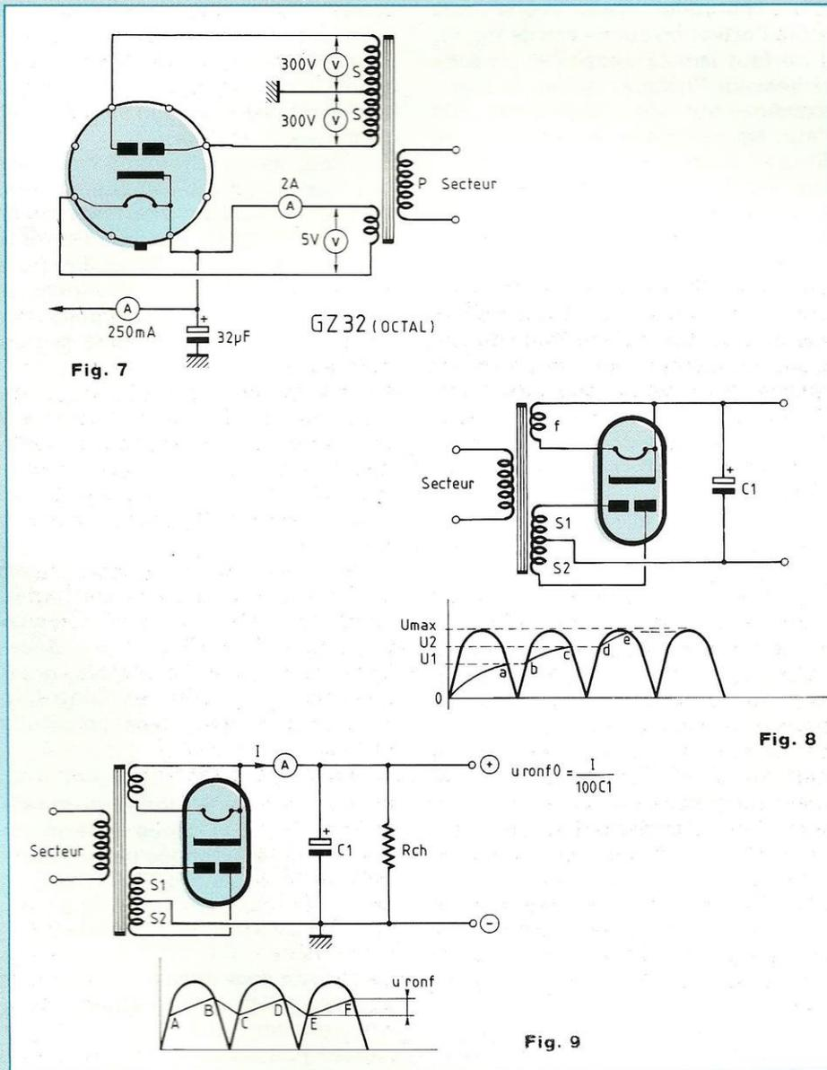
par leur intermédiaire. Le transformateur est en effet le générateur du système, il possède sa propre impédance (résistance) interne et la diode, alimentée par le transformateur, en est le récepteur, qui possède, lui aussi, sa propre résistance interne. Tout ce petit monde obéit aux lois du dipôle...
