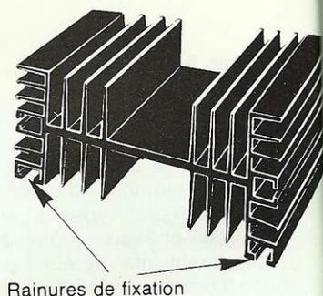
**Fig. 7 : Profilé utilisé sur une longueur de 200 mm.**
