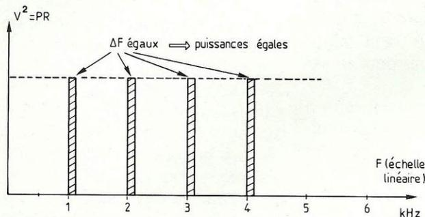
Le bruit thermique est donc un bruit blanc, de puissance également répartie dans toutes les bandes de fréquences de même largeur  $\Delta F$ . Notre générateur de bruit blanc utilise une diode zener qui, convenablement polarisée, fournit une tension efficace de bruit de l'ordre de la centaine de microvolts. Il exige, évidemment, une très forte amplification, comme nous le verrons plus loin.
