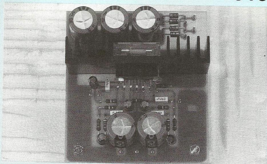
Les applications sont nombreuses pour ce module de puissance stéréophonique compact : petit amplificateur pour chaîne Hi-Fi, autoradio, baladeur, écoute au casque... C'est d'ailleurs pour remplacer l'étage de puissance d'une mini chaîne intégrée dont la vie s'est terminée dans un nuage de fumée, qu'il a été étudié, celui-ci étant doté d'origine d'un spécimen oriental introuvable.
