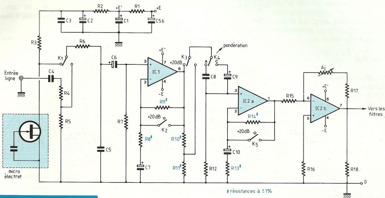
Fig. 14 : Préamplificateur d'entrée.
