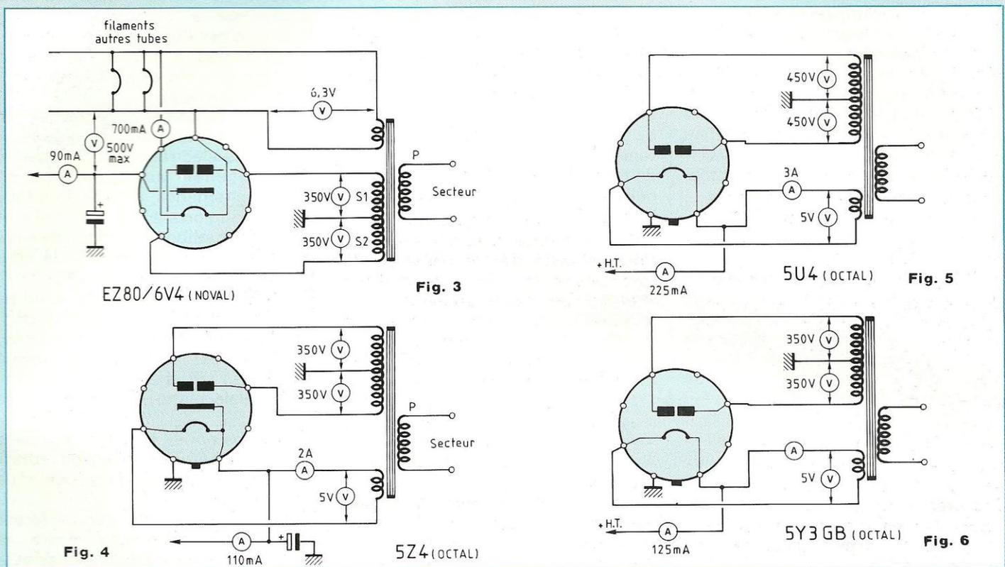
Précisons qu'aucun risque n'est encouru, à la seule condition de ne pas appliquer, entre anode et cathode de la diode redresseuse EZ 80, une tension (anodique) de grandeur supérieure à 350 volts, sinon ce serait l'irréremédiable claquage de la diode...
