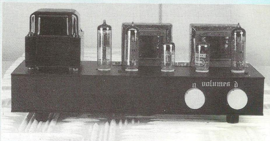
Bien que de puissance modeste, cette réalisation comblera les possesseurs d'enceintes à haut-rendement (98 à 102 dB/1 W/1 m) pour qui cette réserve de puissance, surtout lorsqu'elle est fournie par un amplificateur à tubes dynamique, est largement suffisante pour une écoute domestique confortable.
