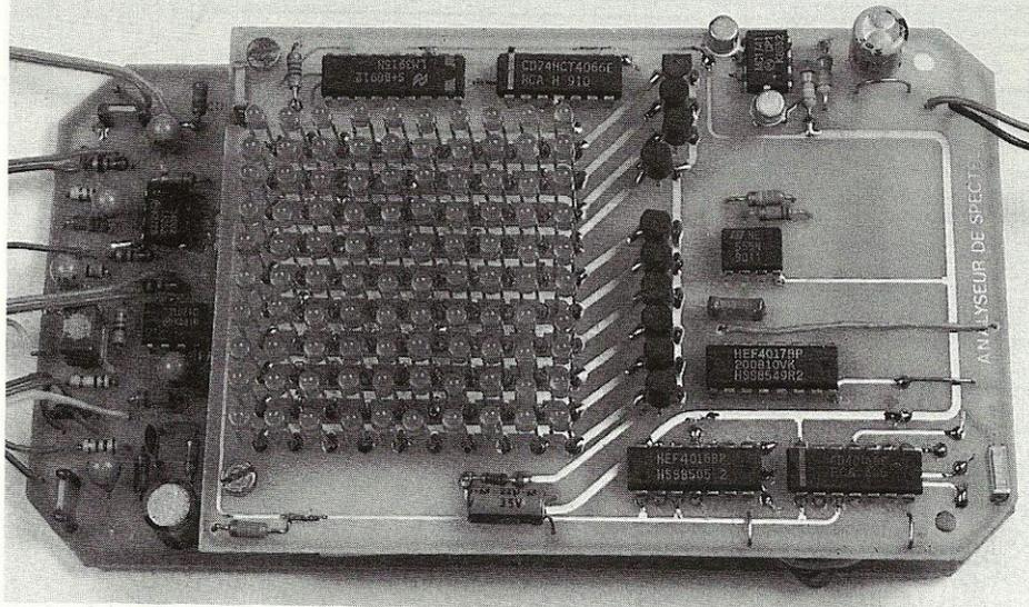
**Vue du circuit imprimé côté composants, l'alignement en hauteur des 100 LED exige beaucoup de soin.**
