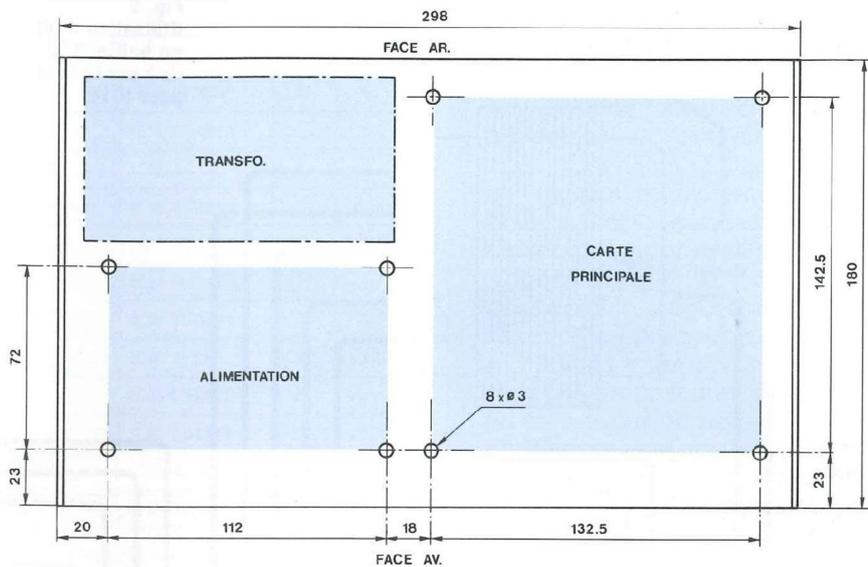
Fig. 2a : Plan de perçage de la face arrière (98 x 297 mm).
