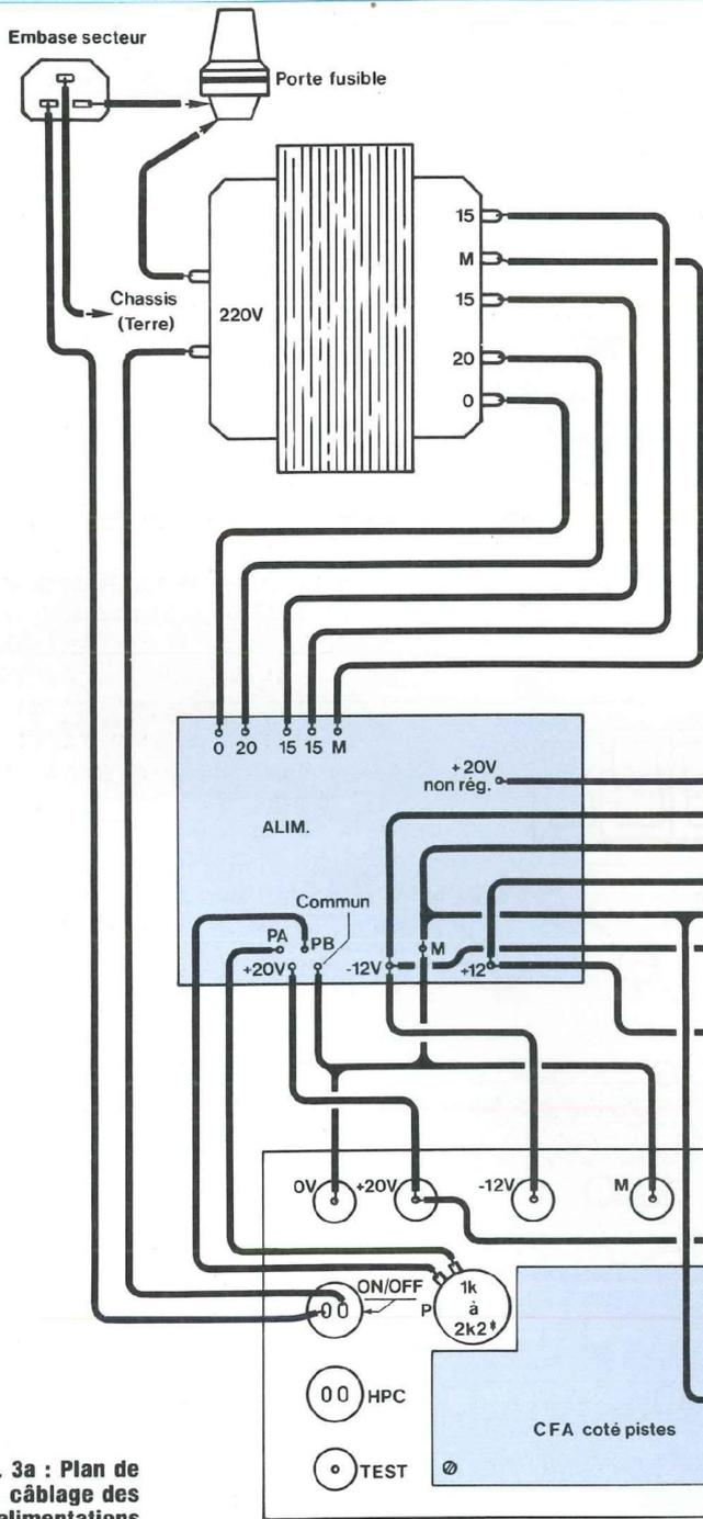
Fig. 3a : Plan de câblage des alimentations
