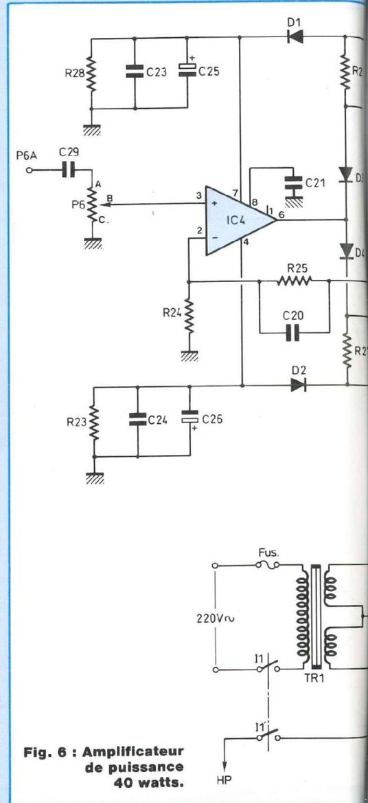
Fig. 6 : Amplificateur de puissance 40 watts.
