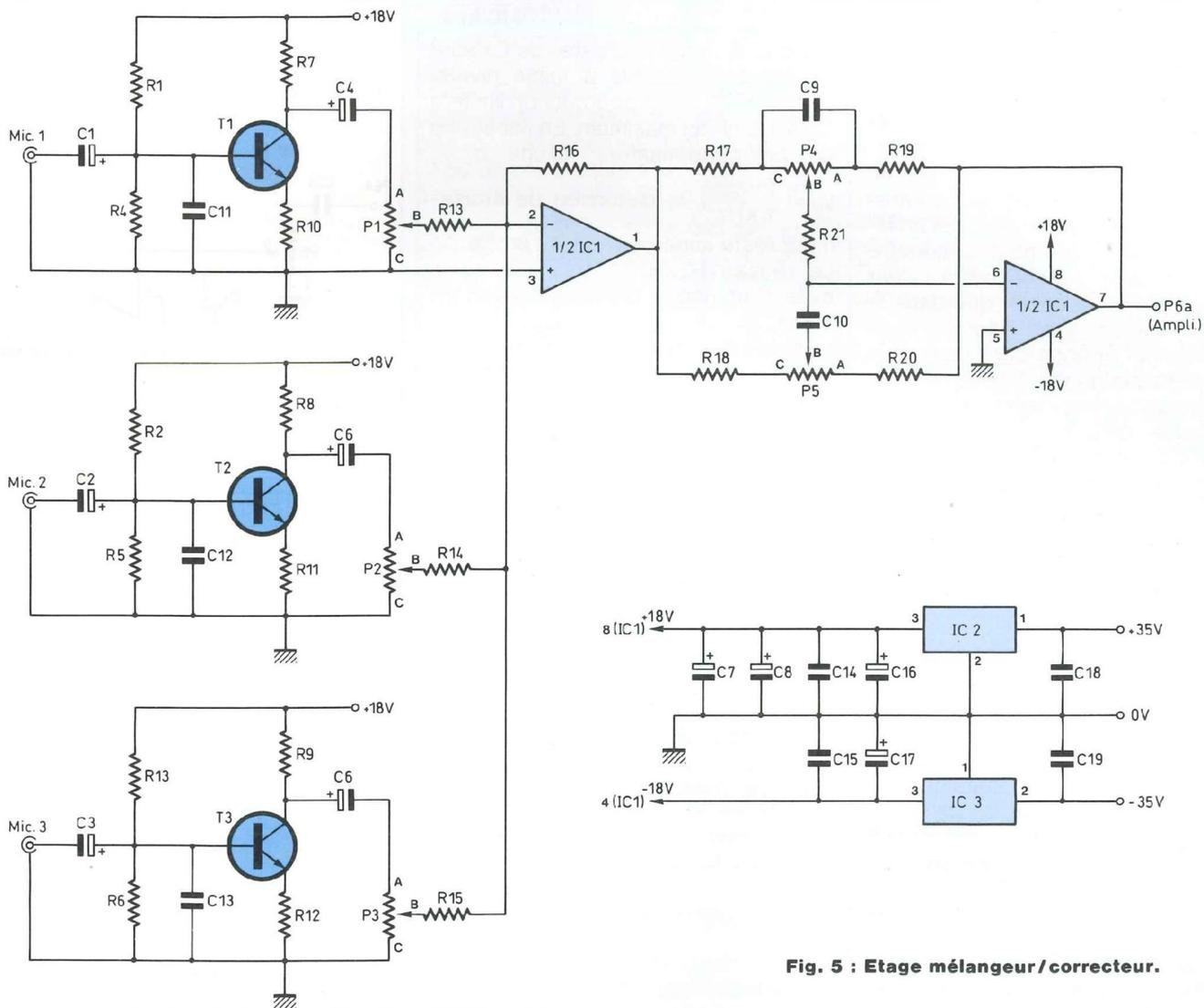
Fig. 5 : Etage mélangeur/correcteur.
