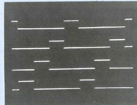
Photo 7 : Sorties  $D_0$  à  $D_3$  du 74C925 → multiplexage de l'affichage. Chaque afficheur est sélectionné 1 fois sur 4  $F_{MUX} = 1 \text{ kHz}$ .
