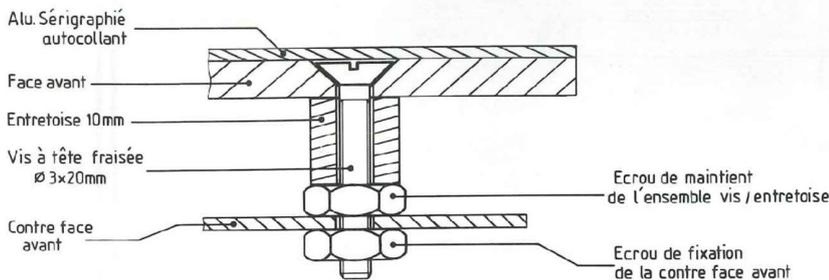
Fig. 6 : Détail de fixation de la contre-face avant.
