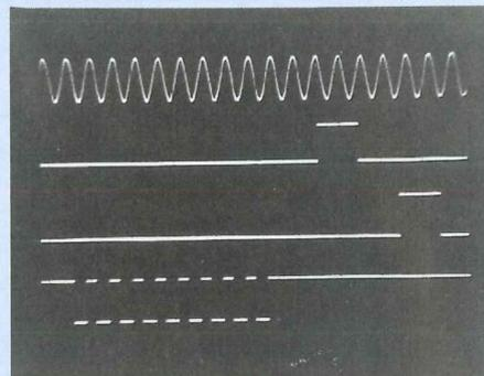
Photo 6 : Oscillogrammes de fonctionnement du 74C925.
