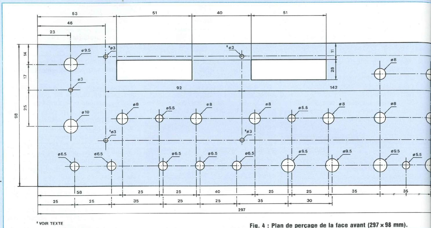
Fig. 4 : Plan de perçage de la face avant (297 x 98 mm).
