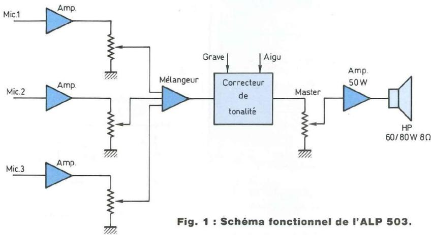
Fig. 1 : Schéma fonctionnel de l'ALP 503.
