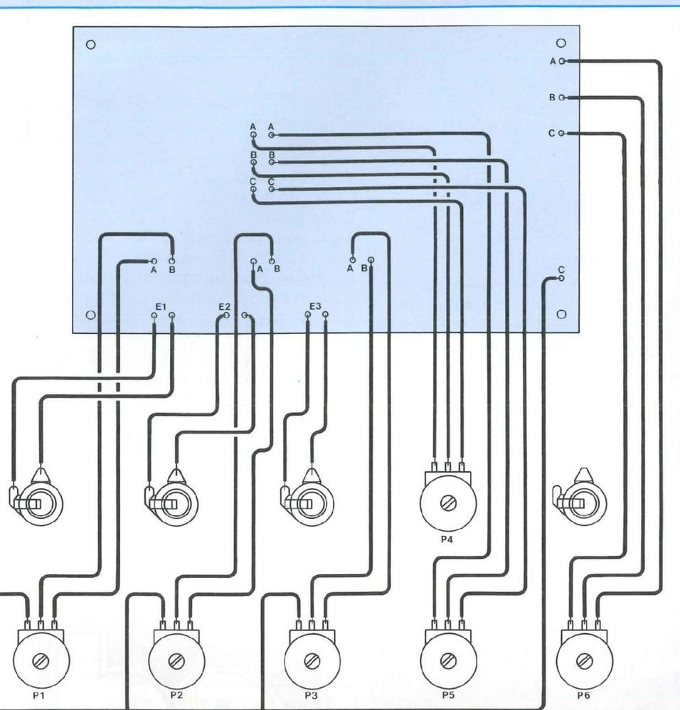
Fig. 10 : Plan de câblage de la face avant.
