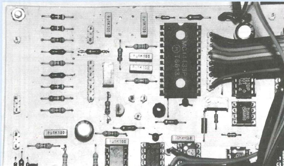
Photo du haut : Voltmètre numérique intégré et circuit d'entrée. (Résistances de précision/générateur de référence et, au milieu des câbles, redresseur RMS. On devine entre le GBF et le voltmètre, le circuit d'entrée du fréquencemètre. (Etage d'amplification, porte de validation et adaptateur de niveaux 12 V  $\rightarrow$  5 V).
