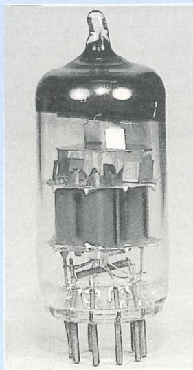
l'anode, il n'y a donc pas d'échange de charges élémentaires d'électricité entre la cathode et l'anode, la cathode fournissant des électrons se dirigeant vers l'anode et l'anode fournissant en contrepartie autant de lacunes (positives) se rendant à la cathode.
