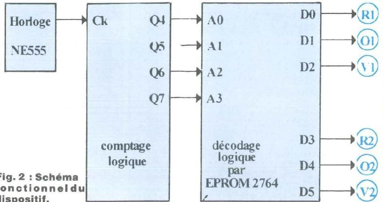
Fig. 2 : Schéma fonctionnel du dispositif.
