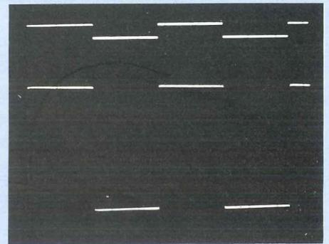
signal carré à cette même fréquence de 1 kHz. Le fait d'utiliser une double triode nous permet de prélever le signal amplifié en sortie en phase avec celui d'entrée.
