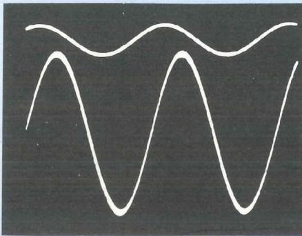
contre-réaction est linéaire (résistive), donc sans influence avec la fréquence du signal d'entrée injecté. A 1 kHz et pour un signal d'entrée sinusoïdal de 11 mV, celui en sortie est amplifié à 152 mV, soit un gain voisin de 14.
