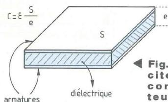
◀ Fig. 3 : Capacité d'un condensateur plan.
