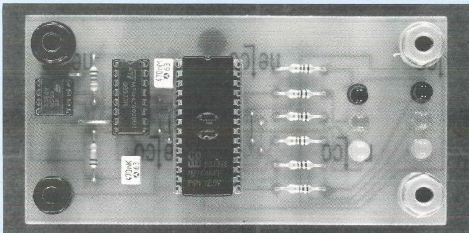
Cette réalisation s'adresse surtout au possesseur d'un programmeur d'EPROM (notamment PROGEMA 6456) dont le principal souci est de démarrer en douceur une réalisation basée sur la 2764. Ce montage assure donc la simulation du fonctionnement des feux tricolores situés au niveau d'un carrefour. La visualisation est assurée par des diodes électroluminescentes, afin d'obtenir les conditions de miniaturisation requises dans le domaine du modélisme.
