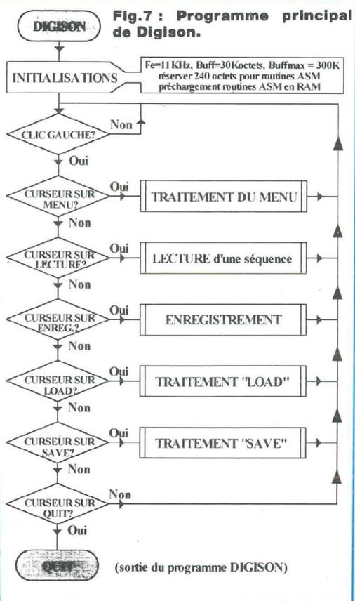
lon pointé par la souris dans la zone comprimée et la fréquence d'échantillonnage sélectionnée. Les fonctions accessibles directement sont la lecture, l'enregistrement, le chargement et la sauvegarde d'une séquence audio avec, bien sûr, la possibilité de quitter le programme. La fonction "menu", qui n'est pas très explicite, donne accès à une multitude de menus intermédiaires que vous pourriez compléter ultérieurement.
