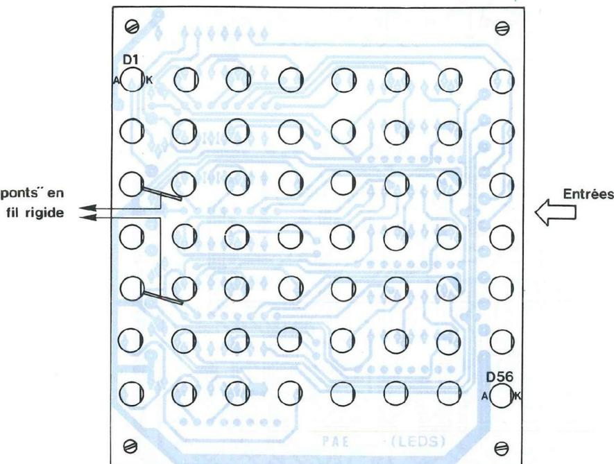
Fig. 12 : Implantation double face d'un module.
