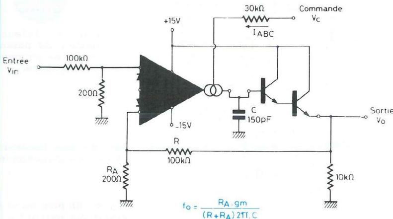
Fig. 2 : Filtre passe-bas commandé en tension.
