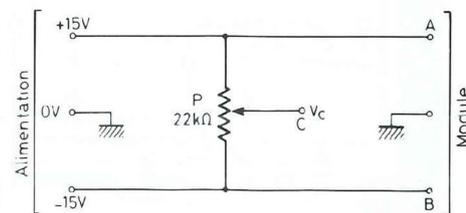
Fig. 4 : Tension de commande  $V_c$  à partir de la tension d'alimentation  $\pm 15$  V.
