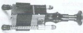
FLIP DIP Semi automatique. Les ressorts des guides latéraux extraient le C.I. quand tous les points sont en fusion.
