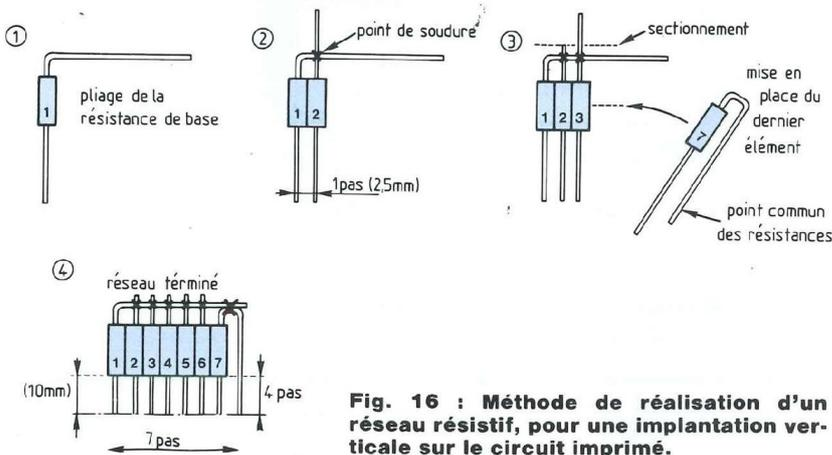
Fig. 16 : Méthode de réalisation d'un réseau résistif, pour une implantation verticale sur le circuit imprimé.
