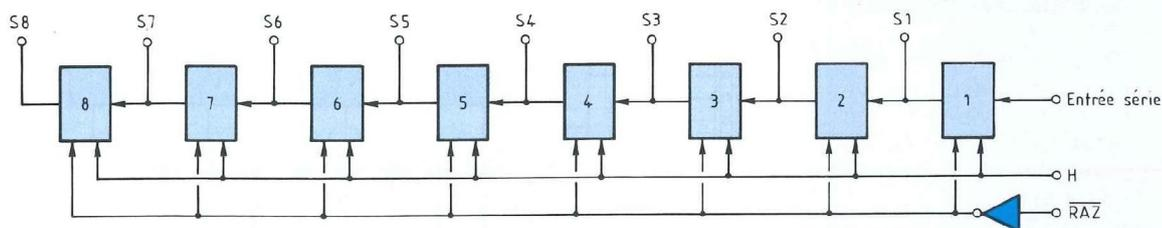
Fig. 9 : Constitution d'un registre à décalage (de 8 bits).
