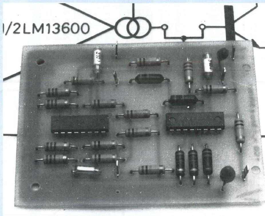
Le mini-générateur BF est basé sur l'utilisation de deux circuits intégrés LM 13700 montés en oscillateur et commandés en tension. Le LM 13700 est composé de deux amplificateurs à transconductances contrôlés en courant, chacun avec des entrées différentielles et un push pull de sortie.
