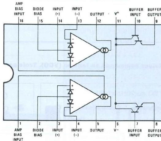
Fig. 1 : Structure interne du LM 13 700. Un boîtier contient deux amplificateurs à transconductance.
