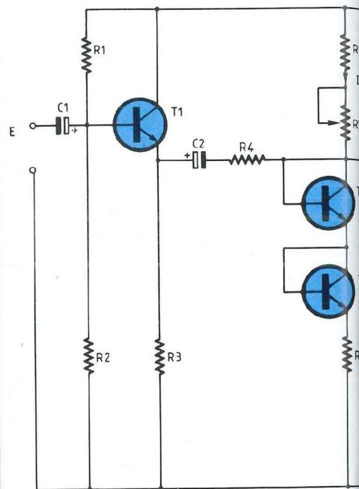
teur puisse sortir toute sa puissance avec les préamplificateurs actuels. 400 W représentent une tension crête de sortie de 80 V, donc avec un coefficient de 26,5, il faut 2,13 V<sub>eff</sub> en entrée. D'après le système utilisé en émetteur commun, on a calculé littéralement l'expression de la transmittance  $A_v$  et on aboutit au résultat suivant :
