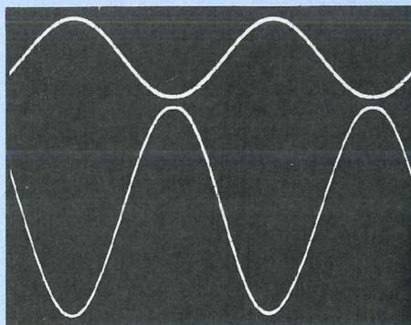
1. Signal à P<sub>max</sub> (1 kHz), amplitude de 165 V càc soit 425 Weff.
