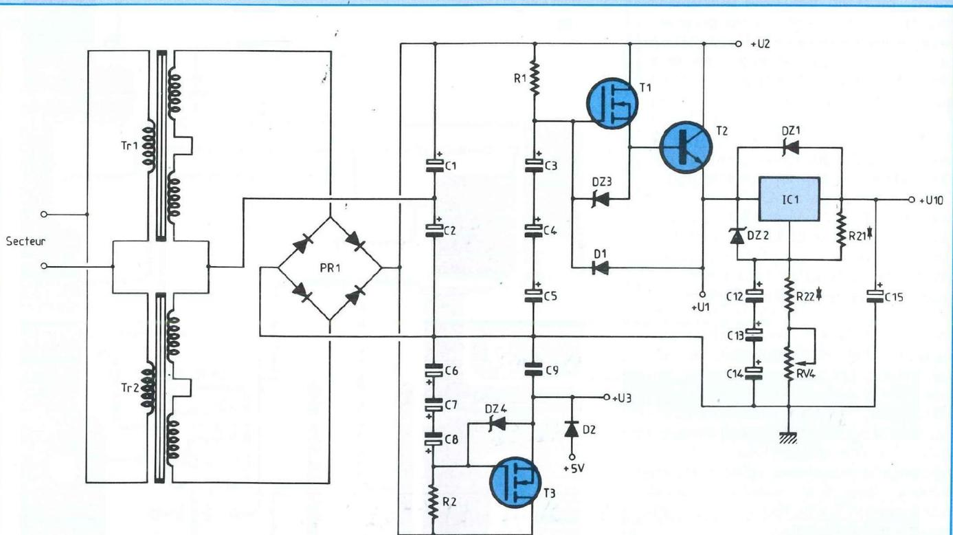
Fig. 4 : Une alimentation ayant recours à deux transformateurs 2 x 35 V/500 VA.
