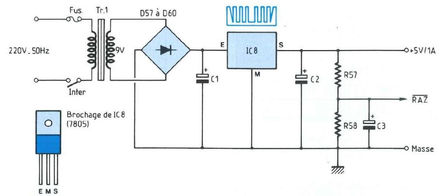
Fig. 21 : Schéma structurel de l'alimentation (Fp1).
