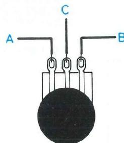
**Fig. 7 : Interconnexion du potentiomètre de commande en fréquence.**
