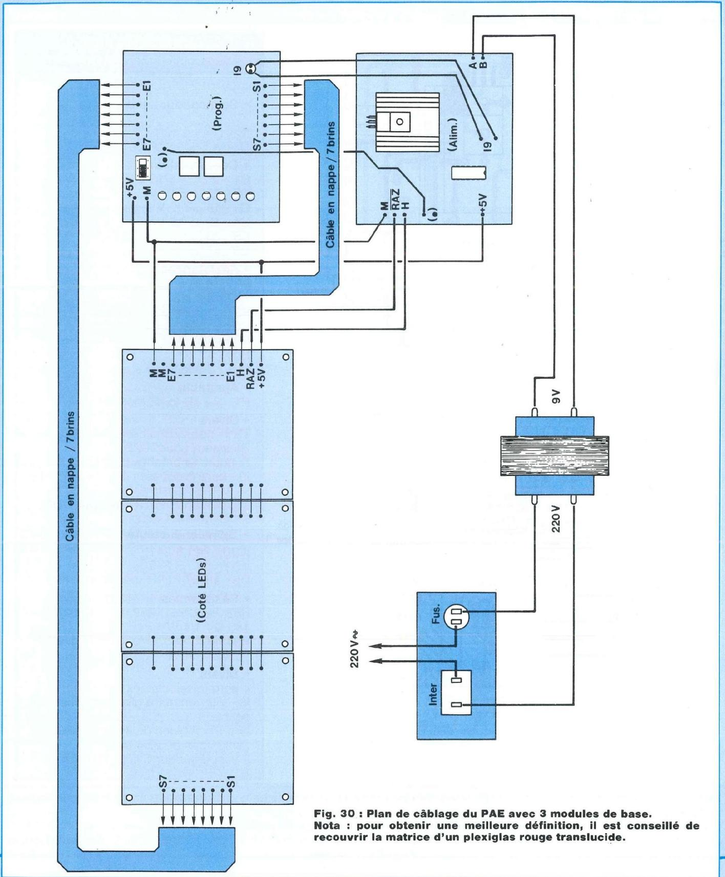
Fig. 30 : Plan de câblage du PAE avec 3 modules de base.
