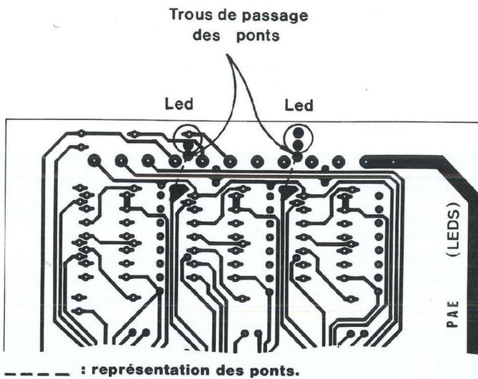
Fig. 17 : Emplacement des ponts de fil rigide (côté LEDES).
