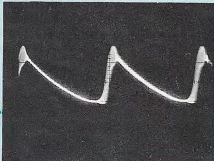
scope sur le point commun à L2 et R4 (sonde 1/10 afin de limiter la capacité parasite et surtout, de disposer de la bande passante maximale).
