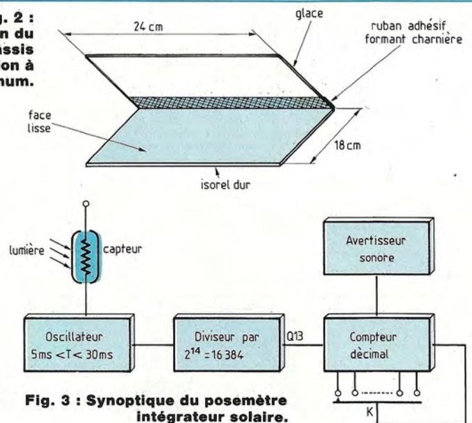
**Fig. 3 : Synoptique du posemètre intégrateur solaire.**
