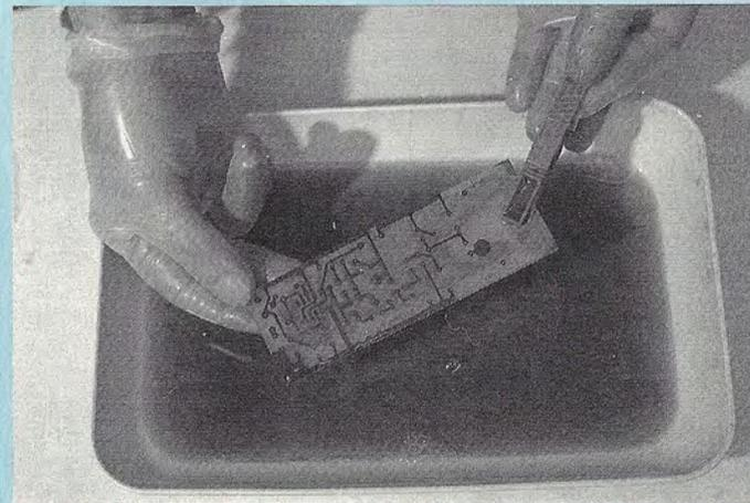
**F.** Pour l'attaque au perchlorure, il est impératif d'utiliser un bac en plastique ou en verre, à l'exclusion de tout récipient métallique. Il vaut mieux ne pas remplir à plus de 1,5 ou 2 cm de hauteur, ce qui facilite la surveillance du traitement, à l'agitation.
