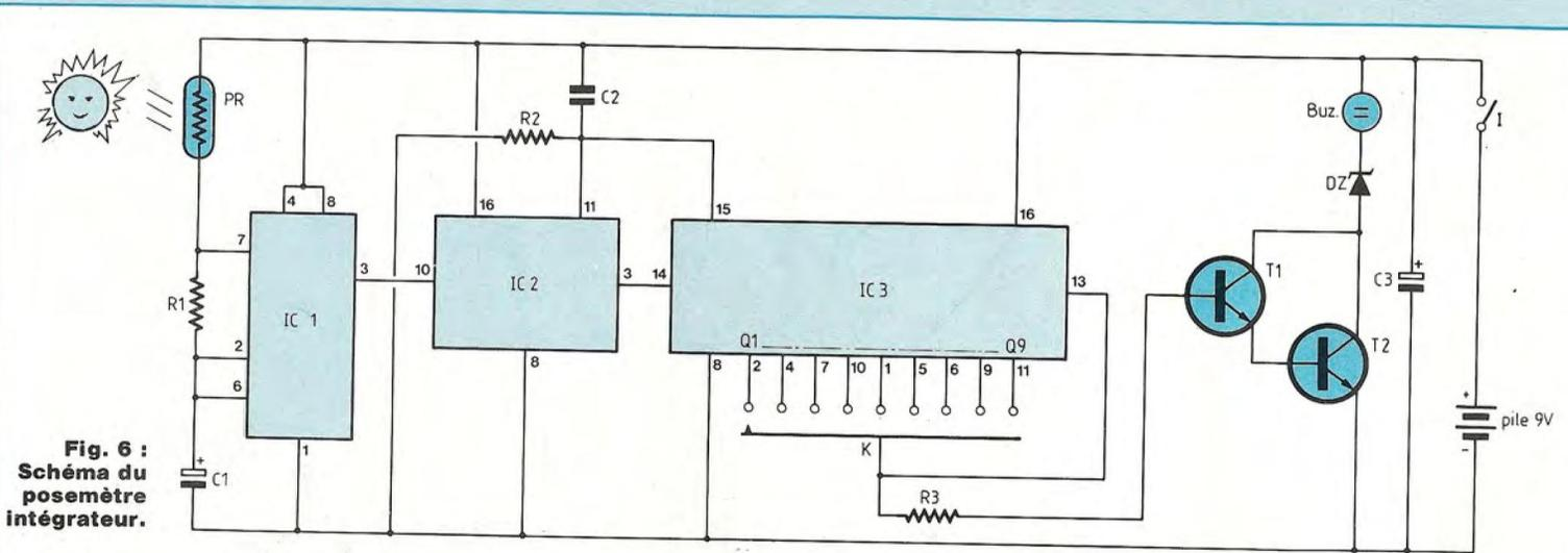
Fig. 6 : Schéma du posemètre intégrateur.
