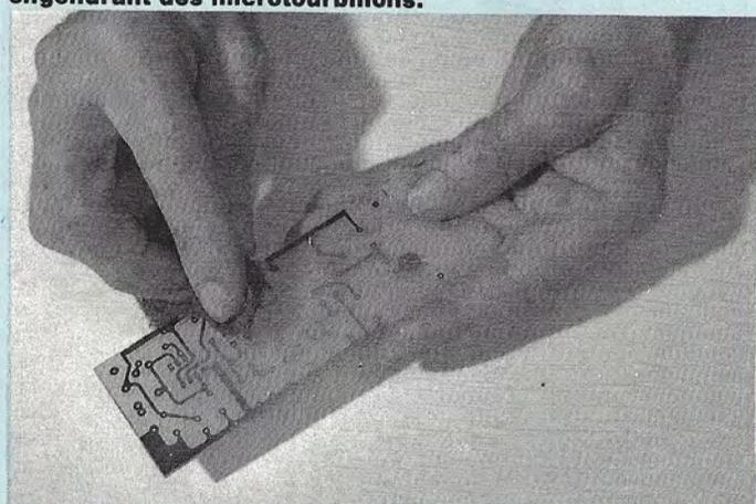
**J.** Pour éliminer la résine avant perçage et soudure des composants, on peut utiliser une éponge-grattoir (modèle en plastique vert) humide. Ne jamais employer de papier de verre, même très fin : les rayures résultantes constituent des amorces d'oxydation rapide du cuivre.
