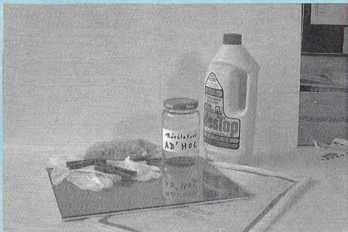
**A.** Autour du "châssis d'insulation", accompagné de son dispositif de verrouillage (les pinces à linge), on reconnaît l'essentiel de l'équipement : la bouteille de Destop et le flacon de révélateur ad hoc, obtenu par dilution ; le posemètre intégrateur ; un sachet de cristaux de perchlorure de fer ; des gants de protection.
