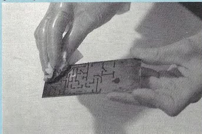
**C.** Il est commode d'étaler le révélateur à l'aide d'un papier essuie-tout. De cette façon, on conserve toujours dans le flacon un produit neuf, et d'efficacité constante, au lieu d'un bain dont l'action se montre de plus en plus lente.
