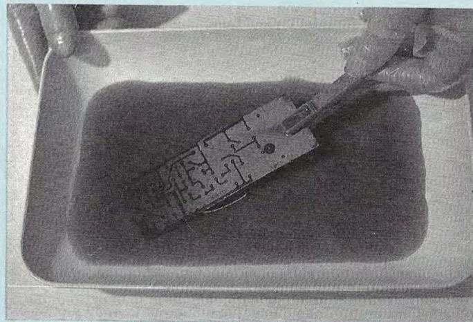
**H.** Conduire l'attaque jusqu'à disparition des dernières traces de cuivre. Celles-ci subsistent, généralement, au milieu des plages les plus larges, alors que l'élimination s'effectue plus rapidement au voisinage des pistes, ou de tout obstacle engendrant des microtourbillons.
