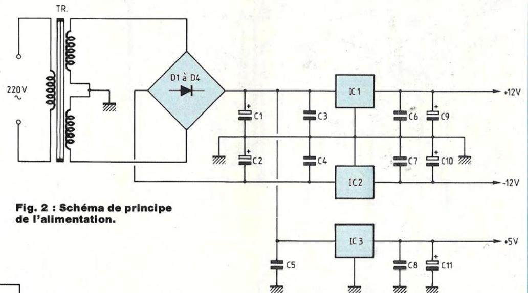
**Fig. 2 : Schéma de principe de l'alimentation.**
