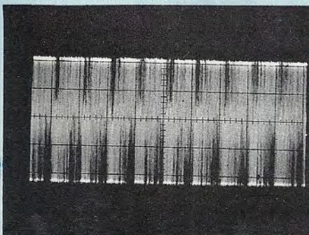
urbaine notamment, de capter les nombreux utilisateurs de la bande de 27 MHz (C.B. = Citizen Band). On s'en apercevra facilement par les perturbations introduites sur les créneaux du point test et dont l'oscillogramme I montre un exemple.
