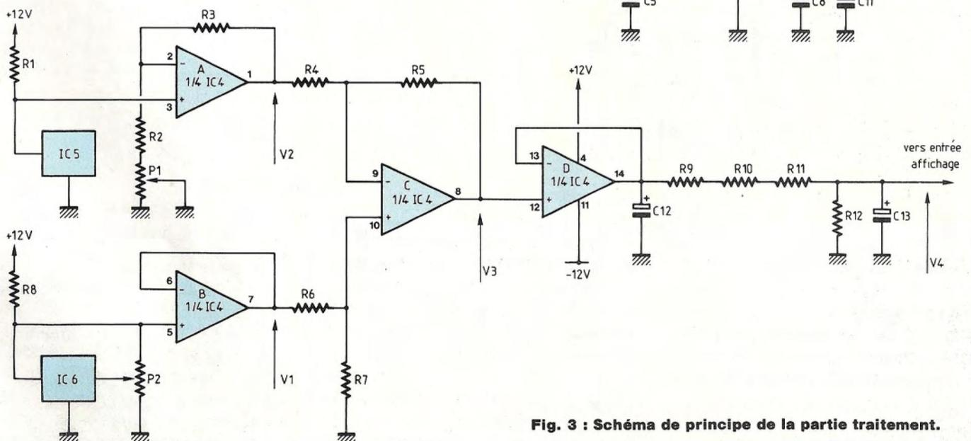
**Fig. 3 : Schéma de principe de la partie traitement.**
