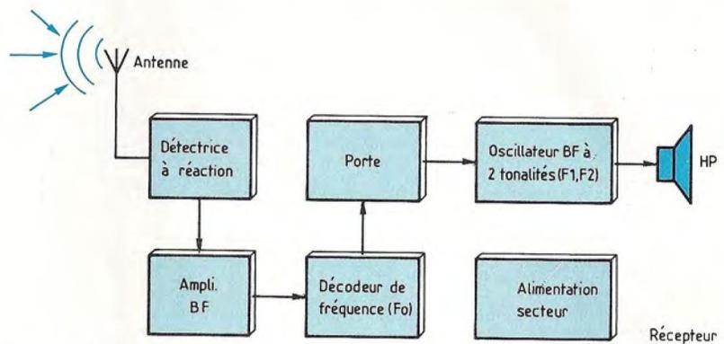
Fig 1 : Synoptique de l'ensemble émetteur/récepteur de la sonnette
