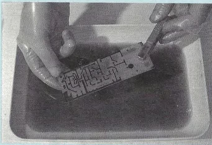
**G.** Dans un bain chauffé préalablement à 35 ou 40° C, le support de résine commence à apparaître au bout de 3 à 4 minutes. Le circuit, coupé légèrement plus long que ses dimensions finales, peut être tenu par une pince à linge, et remué doucement dans le perchlore.
