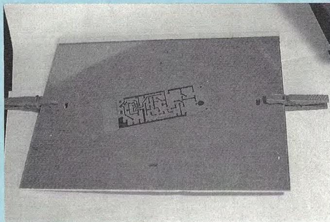
**B.** Le substrat présensibilisé, dépouillé à la dernière minute de ses plastiques protecteurs, est recouvert du film fourni par Led (attention à l'orientation...). Les pinces à linge pressent la vitre, donc le film contre le circuit : il faut un contact parfait.
