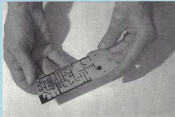
**D.** Au bout de quelques dizaines de secondes, le tracé commence à apparaître. Renouveler le révélateur deux ou trois fois, avec des morceaux d'essuie-tout propres, et en frottant très légèrement, pour ne pas rayer la résine.
