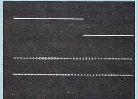
**Osc H :** L'oscillateur IC2, à très basse fréquence (en haut), module la fréquence audible de IC4.
