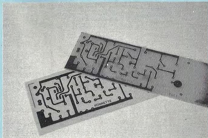
**E.** Complètement révélé, le circuit laisse voir, en dehors des pistes et pastilles, des plages de cuivre parfaitement à nu. Attention : des résidus de résine compromettraient l'attaque au perchlorure. Il reste à éliminer le révélateur par un rinçage abondant à l'eau courante.
