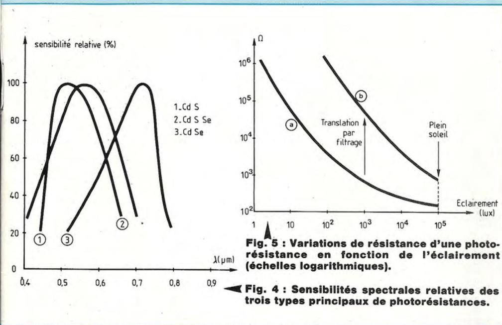
**Fig. 5 : Variations de résistance d'une photorésistance en fonction de l'éclairement (échelles logarithmiques).**
