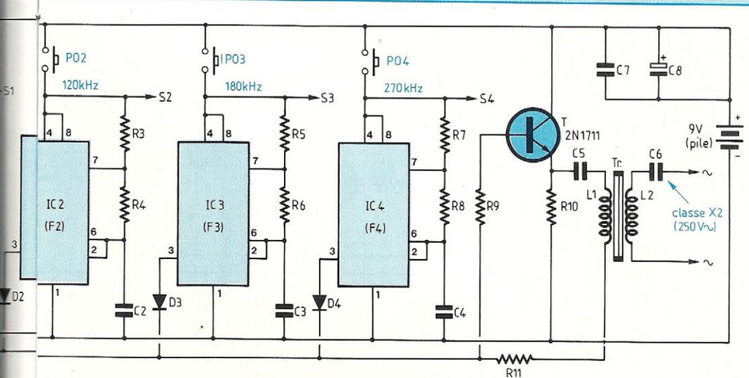
Fig. 5 : Schéma de l'émetteur à quatre canaux.
