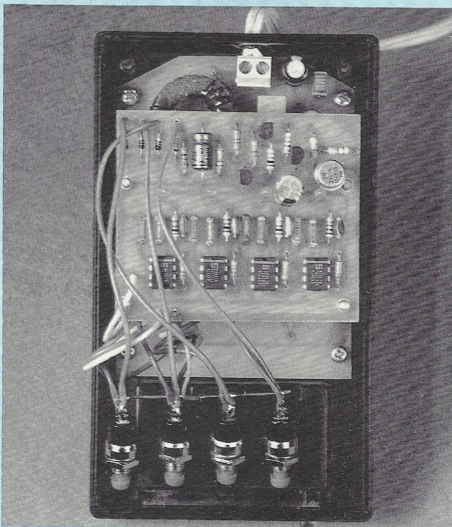
Associant un émetteur à quatre canaux et quatre récepteurs accordés sur des fréquences distinctes, l'ensemble décrit déclenche à distance, par les fils du secteur, la mise en marche ou l'arrêt d'autant d'appareils électriques d'une puissance unitaire maximale de 3 000 W environ. La commande s'étend à tout le volume d'une habitation desservie par le même compteur E.D.F.
