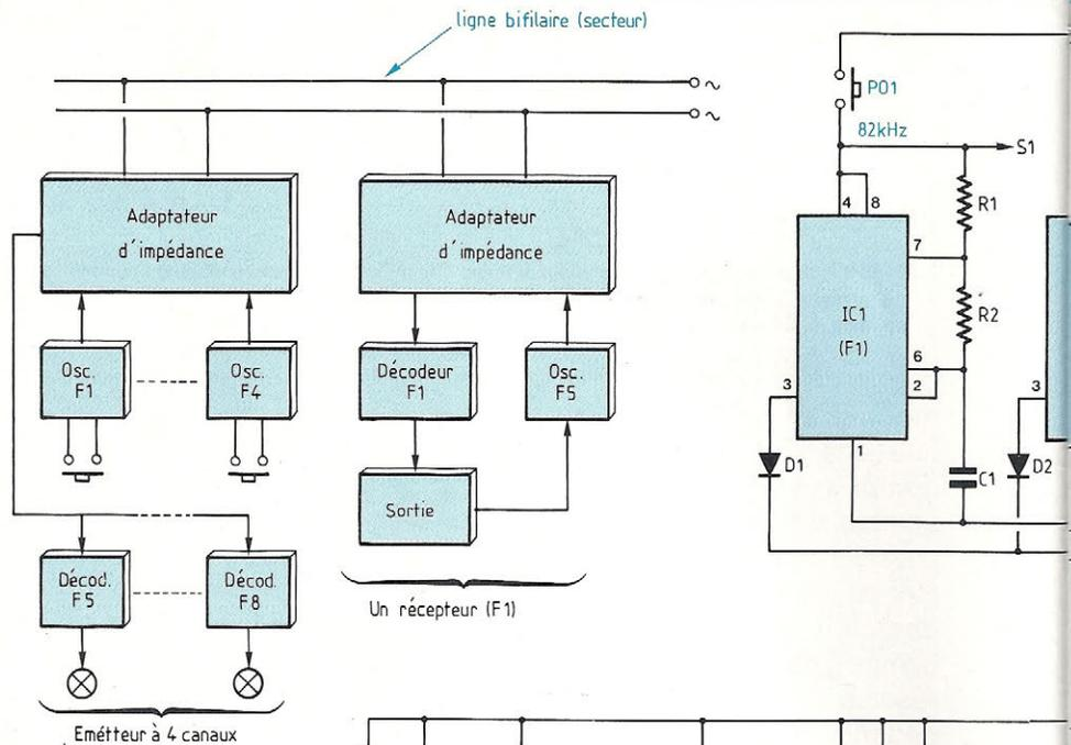
Fig. 4 : Structure de l'installation de télécommande.
