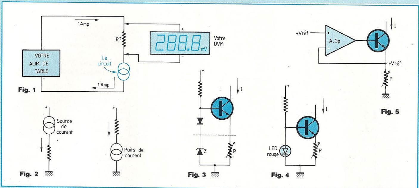
circuit de fonction conseillé, mais pas un circuit de mesureur. Un transistor NPN compare de lui-même les potentiels présents sur sa base et sur son émetteur et une simple diode couplée thermiquement au boîtier, minimisera l'action de la température. Celle-ci, en revanche, est totale sur la zener qui n'est stable que vers 6 à 8 V. C'est une perte de dynamique excessive.
