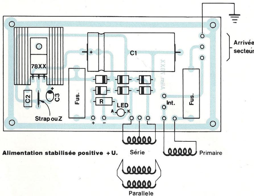
nous incite à équiper le régulateur 7805 (du projet) d'un dissipateur thermique du type ML 26, de  $R_{th} 15^{\circ}C/W$ , un modèle très courant, peu encombrant, que nous tenons toujours approvisionné ...
