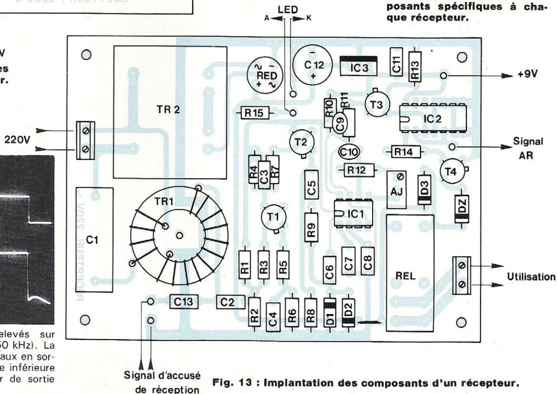
Fig. 13 : Implantation des composants d'un récepteur.
