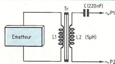
**Fig. 3 :** Le diviseur de tension C, L<sub>2</sub>, presque "transparent" pour les fréquences élevées, atténué très fortement le 50 Hz.
