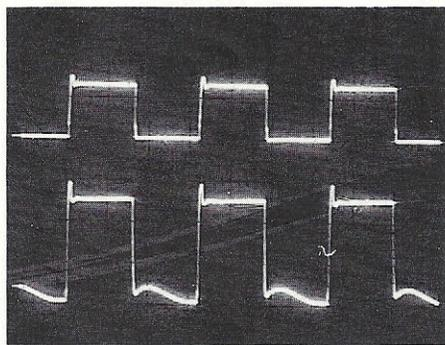
Oscillogramme A : Signaux relevés sur l'émetteur, pour le canal F<sub>3</sub> (150 kHz). La trace supérieure montre les crêteaux en sortie de l'oscillateur IC<sub>3</sub>, et la trace inférieure ceux de l'émetteur du transistor de sortie (appareil relié au secteur).
