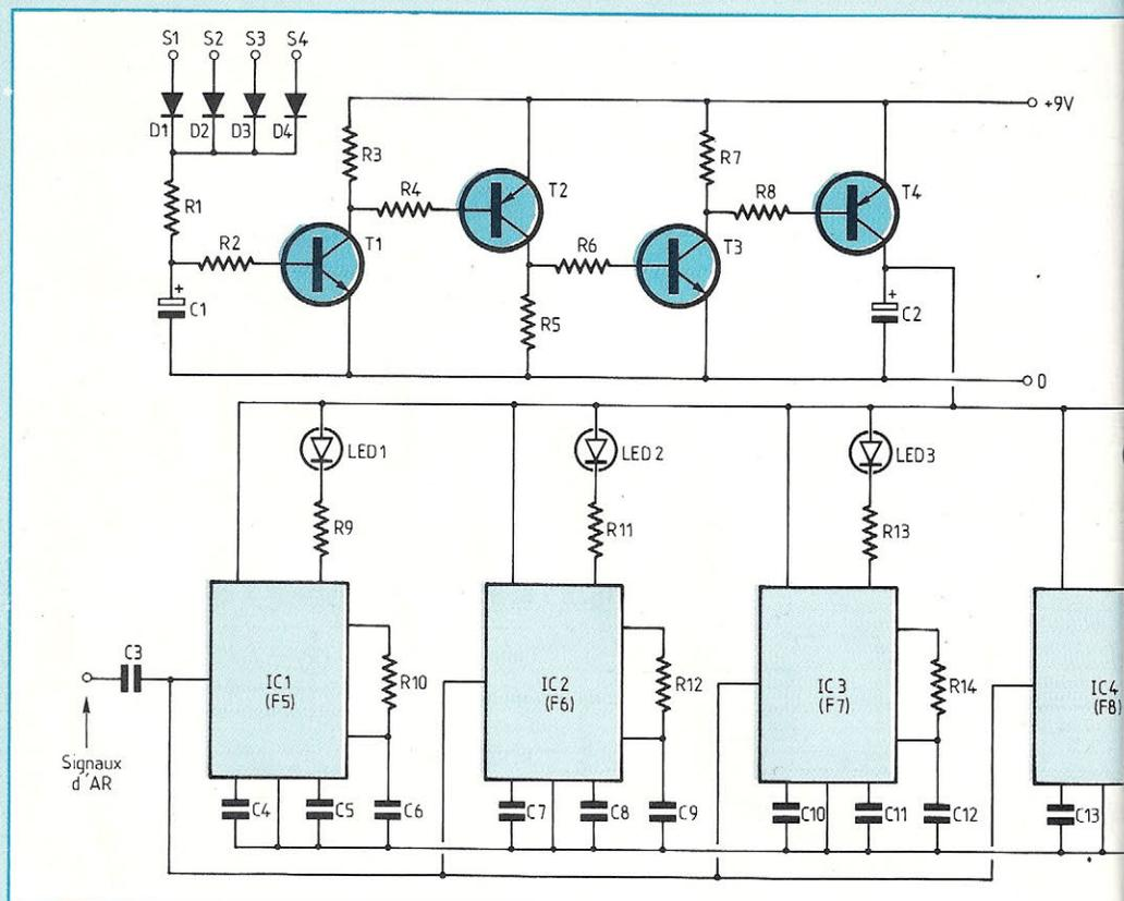
et  $\bar{Q}$  s'inverse à chaque impulsion d'entrée, donc à chaque ordre de l'émetteur. Lorsque la sortie Q se trouve à l'état bas, T4 se bloque et les contacts du relais REL sont ouverts. Ils se ferment, au contraire, lorsque Q passe à l'état haut et sature T4. Nous verrons plus loin comment la sortie  $\bar{Q}$  est utilisée pour commander l'envoi d'un signal d'accusé de réception.
