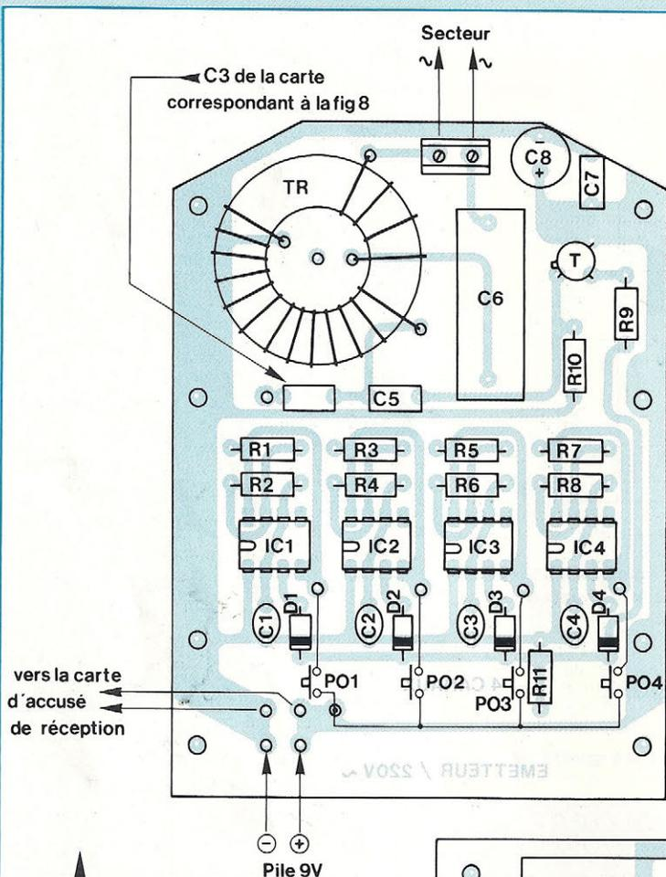
Fig. 12 : Implantation des composants de l'émetteur.
