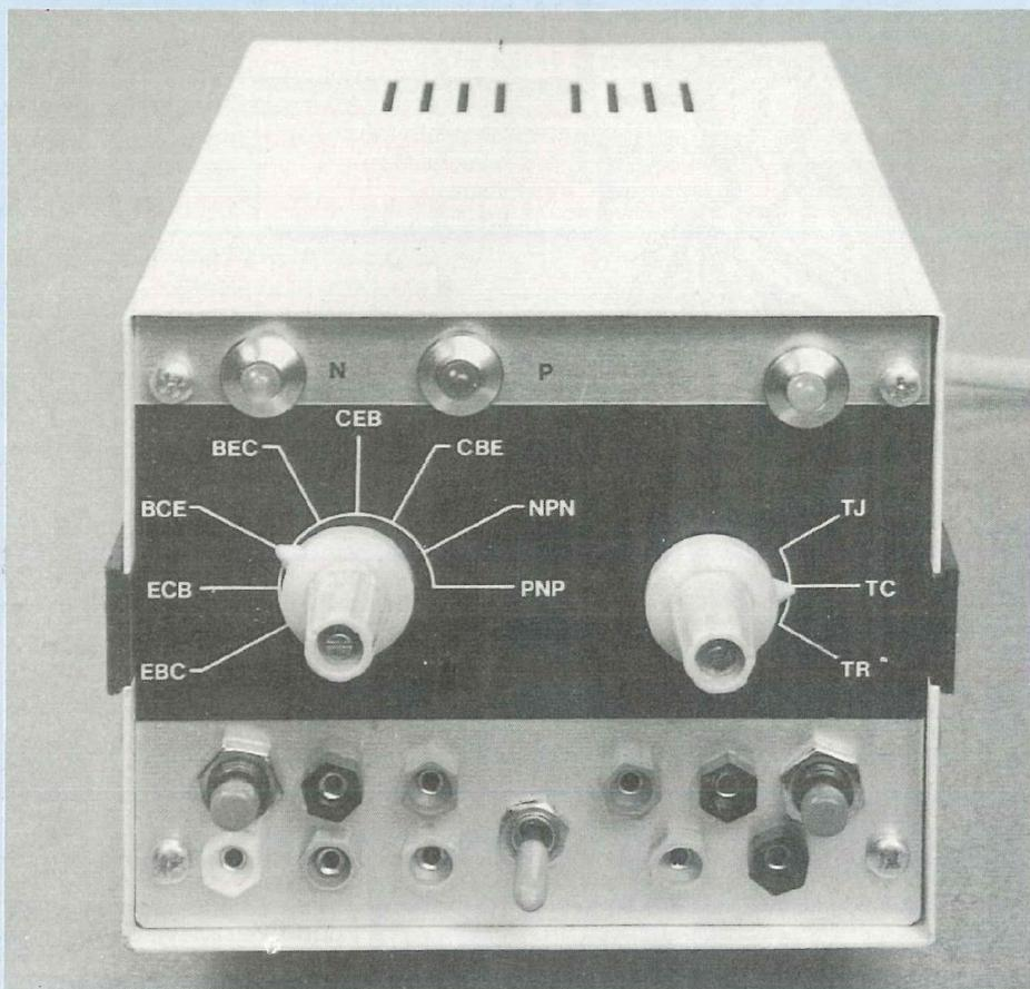
Son nom l'indique : il nous renseigne instantanément sur l'état de fonctionnement, "bon" ou "mauvais", de pratiquement n'importe quel type de semiconducteur : diode de redressement, de commutation, diode électroluminescente, de stabilisation de tension (diode zéner).
