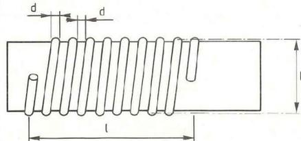
Fig. 7 : Bobinage à surtension élevée (Q).
