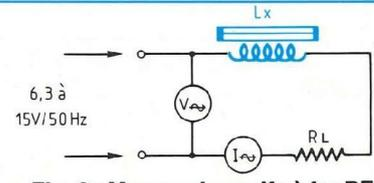
Fig. 3 : Mesure des selfs à fer BF de forte valeur  $\geq 1$  H.
