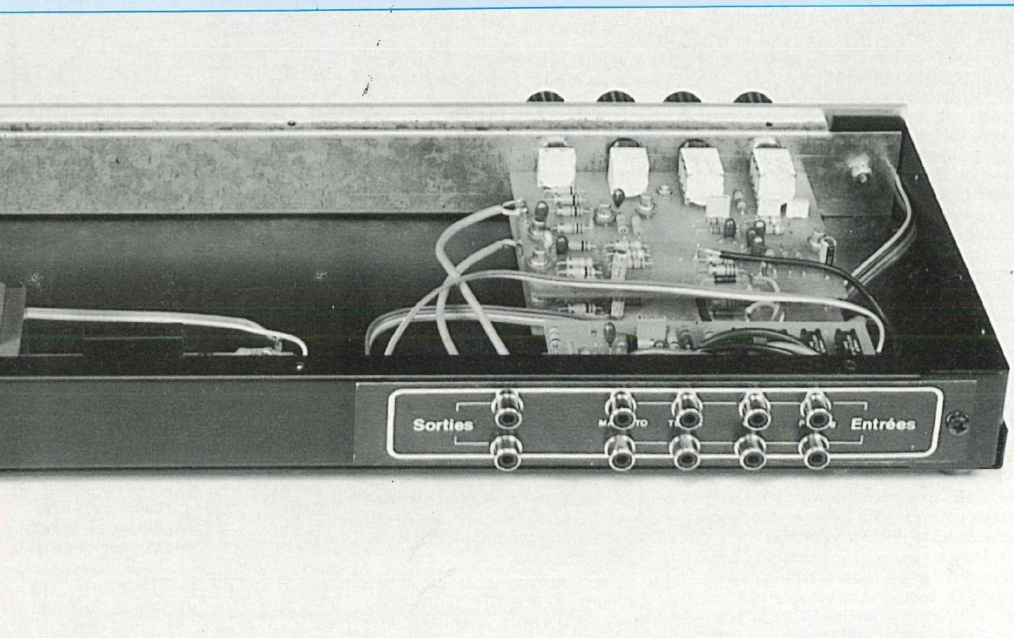
— Approcher la face arrière contre le fond du coffret mais en laissant celle-ci à l'horizontale, sinon les interconnexions ne pourront être effectuées aisément.
