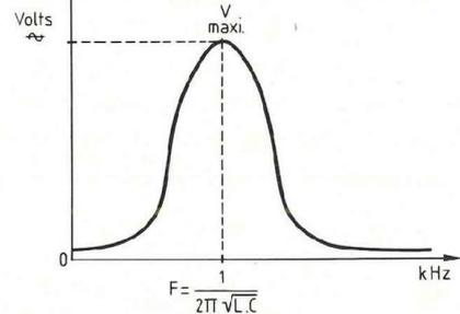
Fig. 5 : Réponse du circuit oscillant LC au balayage en fréquence.
