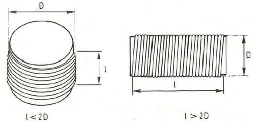
Fig. 8 : Géométries de bobinages se calculant autrement.
