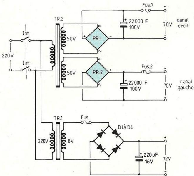
Fig. 3 : Alimentations de l'Amplificateur pure classe A.
