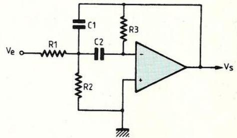
Fig. 15 : Filtre passe-bande à structure de Rauch.
