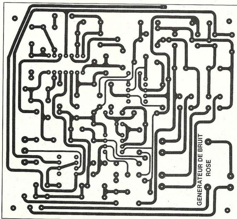
Fig. 11 : Circuit imprimé à l'échelle 1.
