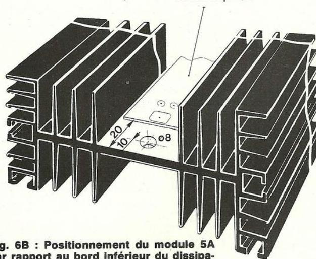
Fig. 6B : Positionnement du module 5A par rapport au bord inférieur du dissipateur.
