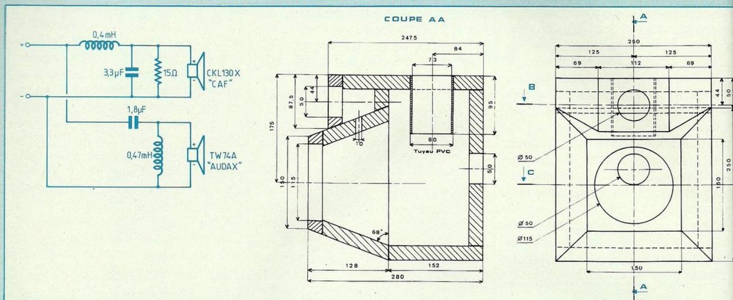
vent pas être trop raides. Une pente de 12 dB/octave semble raisonnable. Premièrement, nous trouvons la cellule passe-bas (0,4 mH, 3,3 µF) et une résistance de puissance de valeur 15 Ω. La bande passante de cette cellule se limite à 5 kHz.
