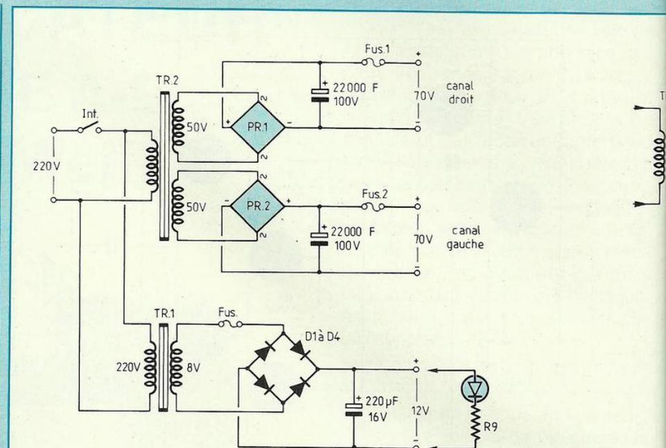
Fig. 2 : Alimentations de l'Amplificateur classe AB.
