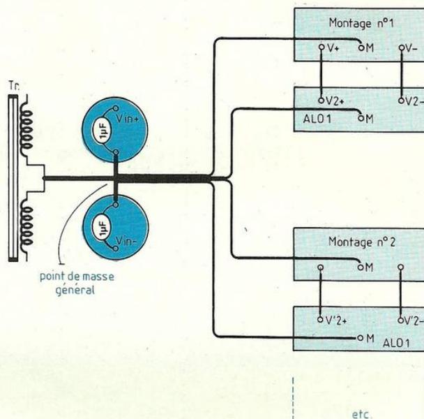
Fig. 9 : Raccordement des masses en étoile.
