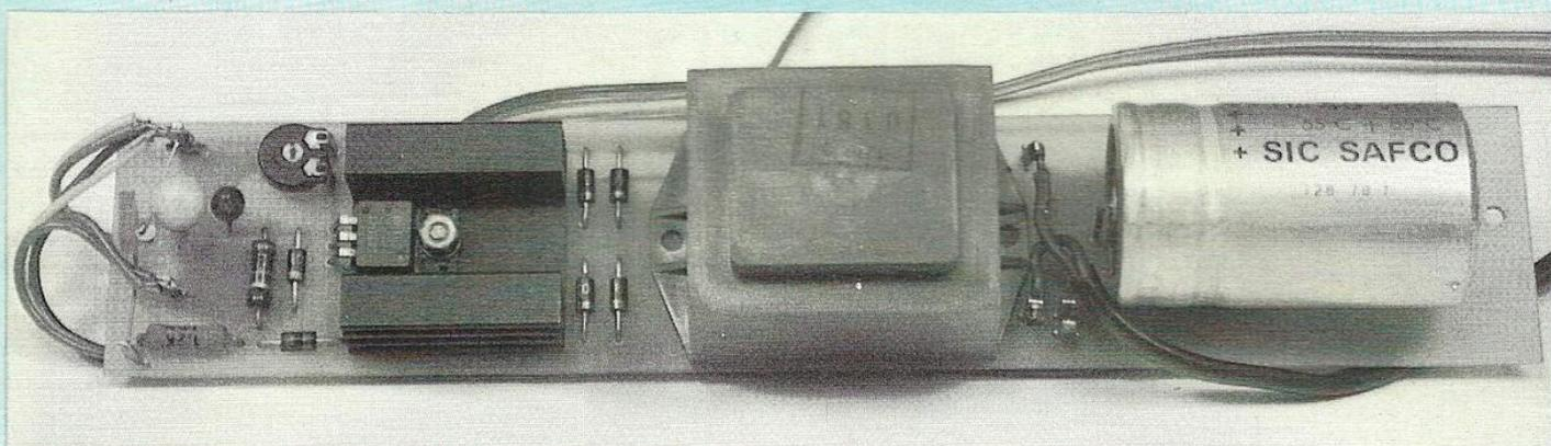
Les deux plaquettes du préamplificateur "haut niveau", ne sont pas identiques, car une seule reçoit les potentiomètres : graves, aigus, volumes, balance.
