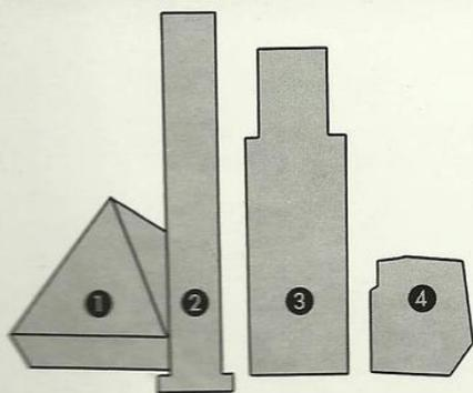
❶ **BACCARA SYSTEME TRIPHONIQUE.** Caisson de graves à charge symétrique, fonctionne en doublet acoustique. Bande passante 38 à 180 Hz à - 3 dB. Puissance programme admissible 100 W. Rendement 90 dB 1 W 1 m. Forme pyramidale. Dim. : base 496 x hauteur 520 mm.
