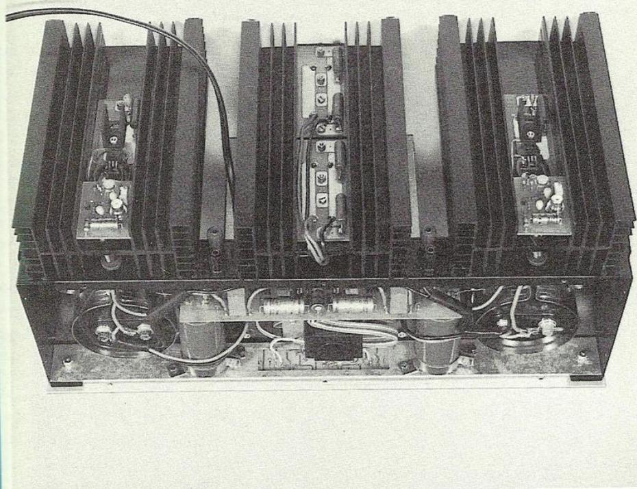
Fig. 14 : Interconnexions du classe A. Utiliser des fils de forte section et de différentes couleurs.
