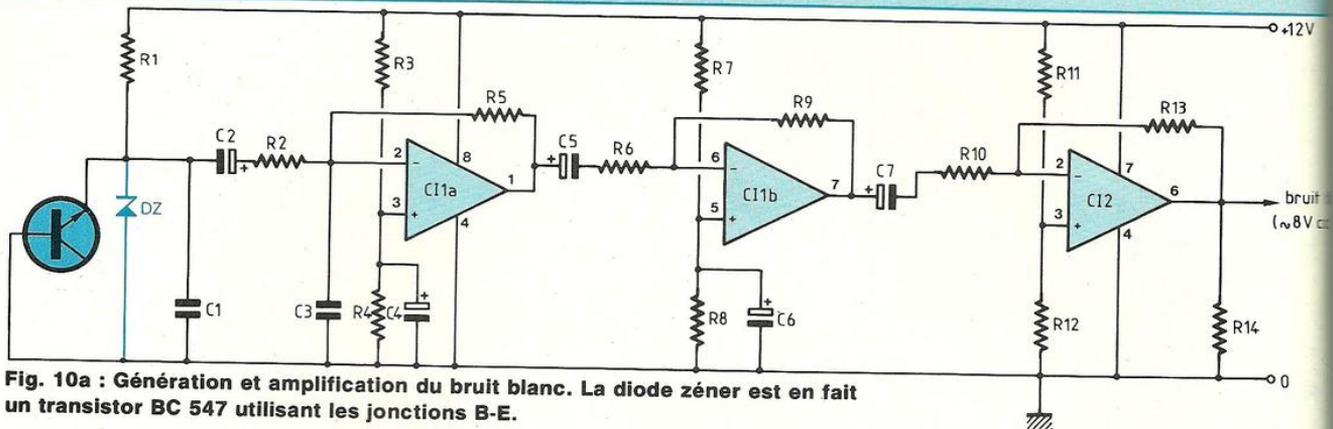
Fig. 10a : Génération et amplification du bruit blanc. La diode zéner est en fait un transistor BC 547 utilisant les jonctions B-E.
