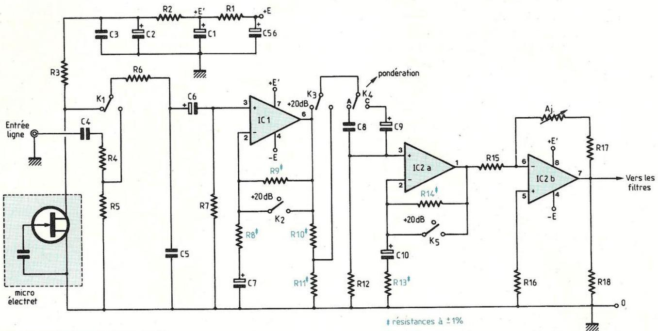
Fig. 14 : Préamplificateur d'entrée.
