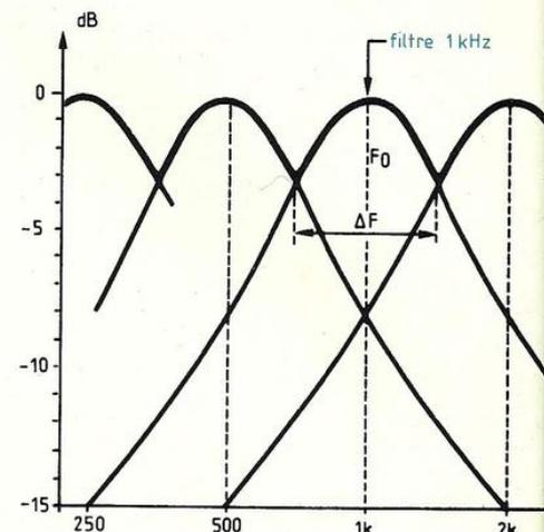
Fig. 16 : Réponse des filtres passe-bande.
