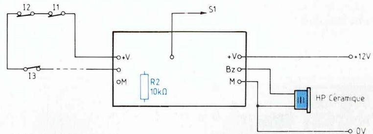
Fig. 8 : Détecteur de rupture de contact.
