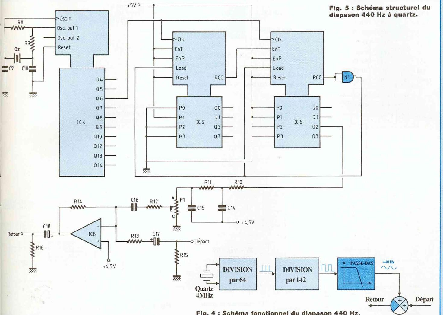
Fig. 4 : Schéma fonctionnel du diapason 440 Hz.
