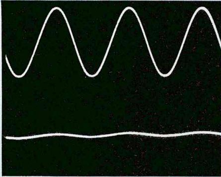
A. En haut, signal d'entrée à 1 kHz et de 100 mV d'amplitude. En bas, signal de sortie du passe-haut.
