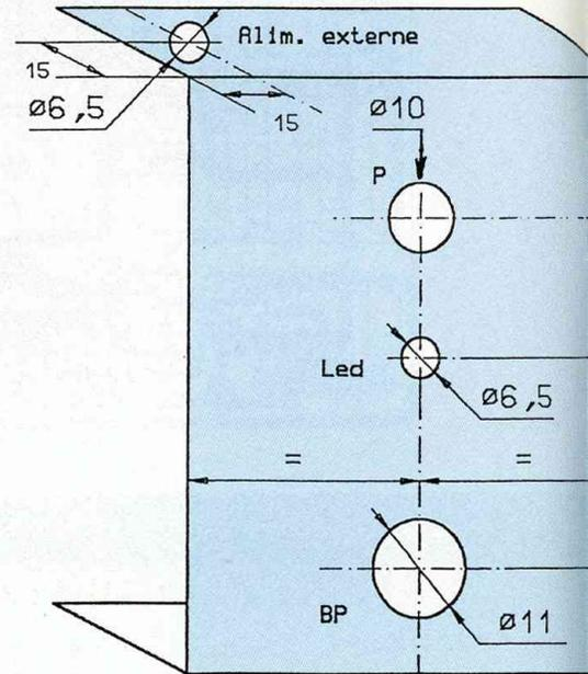
**Fig. 8b : Perçage de la face avant.**
