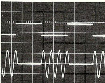
C. Les créneaux TTL de la trace supérieure (1 kHz) découpent la sinusoïde à 6 kHz de la trace inférieure.
