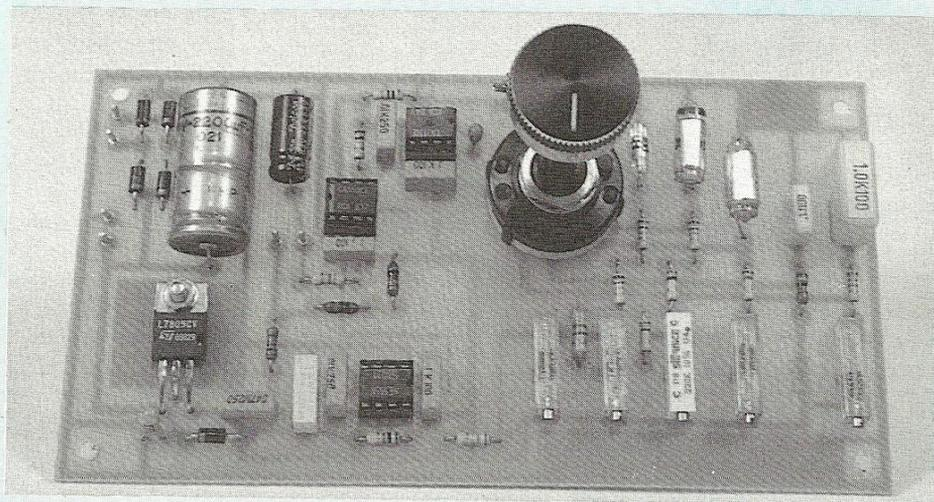
Si votre multimètre n'assume pas la fonction utile, de capacimètre, nous vous invitons à construire cet adaptateur. Vous pourrez ainsi mesurer la valeur de capacités comprises entre 1 picofarad et 25 microfarads, avec une grande précision qui ne doit rien à bon nombre d'instruments, toute prétention écartée.
