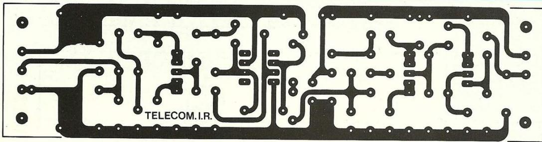
Fig. 12 : Circuit imprimé de la tête réceptrice.
