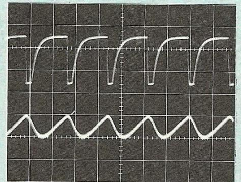
D. Les impulsions légèrement intégrées au collecteur de T4 (trace supérieure, 5V/division) sont mises en forme quasi-sinusoidale à la sortie (200 mV/division). Leur amplitude est alors parfaitement adaptée à la commande des décodeurs.
