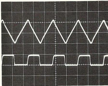
F. A 2 MHz, malgré quelques accidents aux inversions de pente, les triangles de la sortie principale conservent encore bonne allure.
