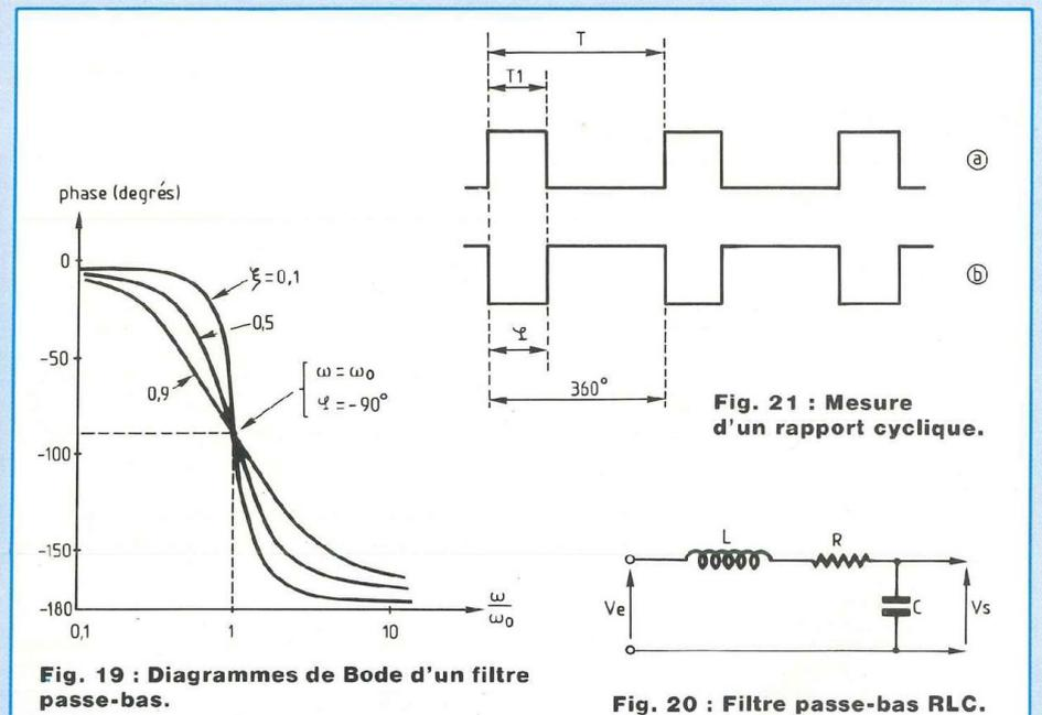
Fig. 19 : Diagrammes de Bode d'un filtre passe-bas.
