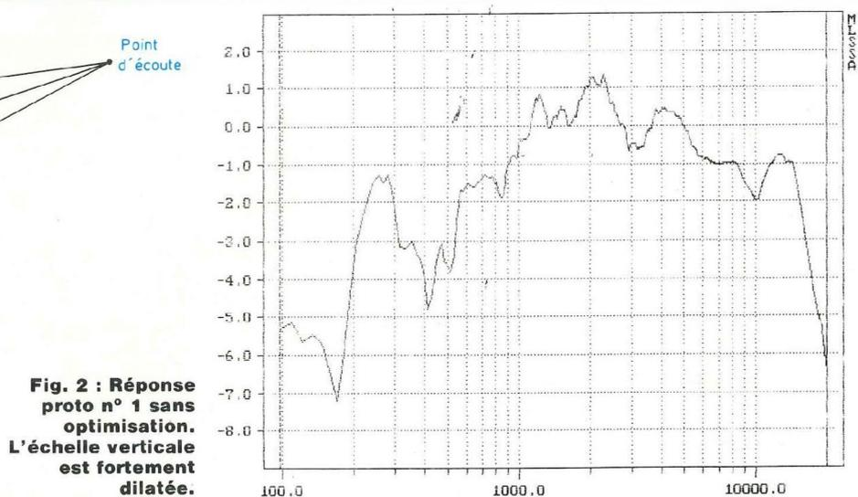
Pour le grave-médium, il fallait trouver un haut-parleur capable de descendre aussi bas que 50 Hz avec du niveau, dans un faible volume, de monter au-delà de 5 kHz sans directivité prononcée, avec un temps de montée court, une absence de coloration et un bon rendement, ce n'était pas évident. Le mouton à cinq pattes (enfin à 4 pattes et demie car il faudra le modifier légèrement) est donc le Focal 5K013L.
