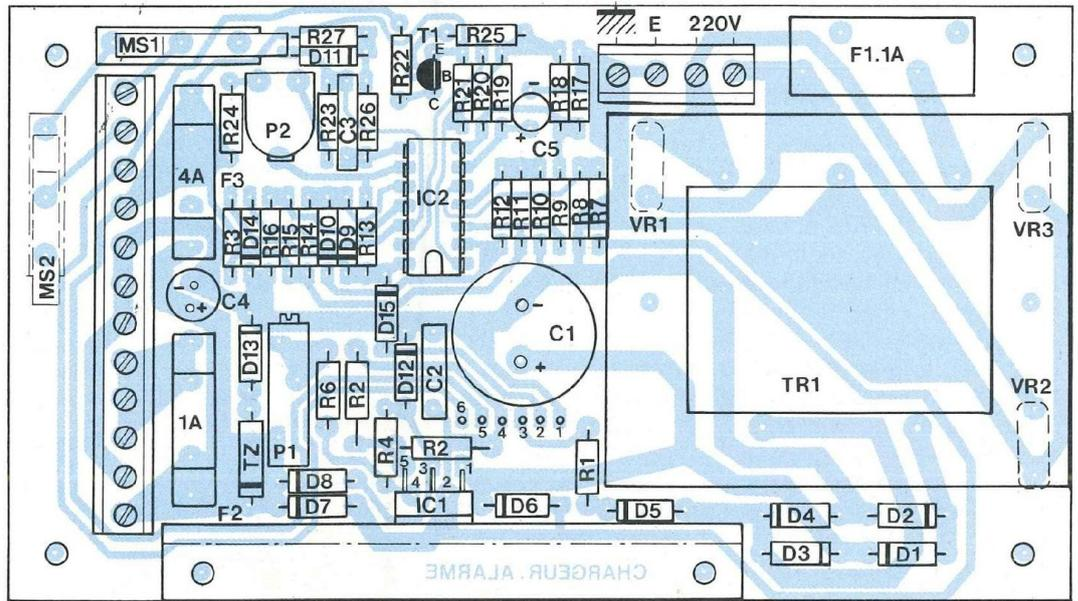
Interconnexions au bornier à 12 points au pas de 5,08 mm.
