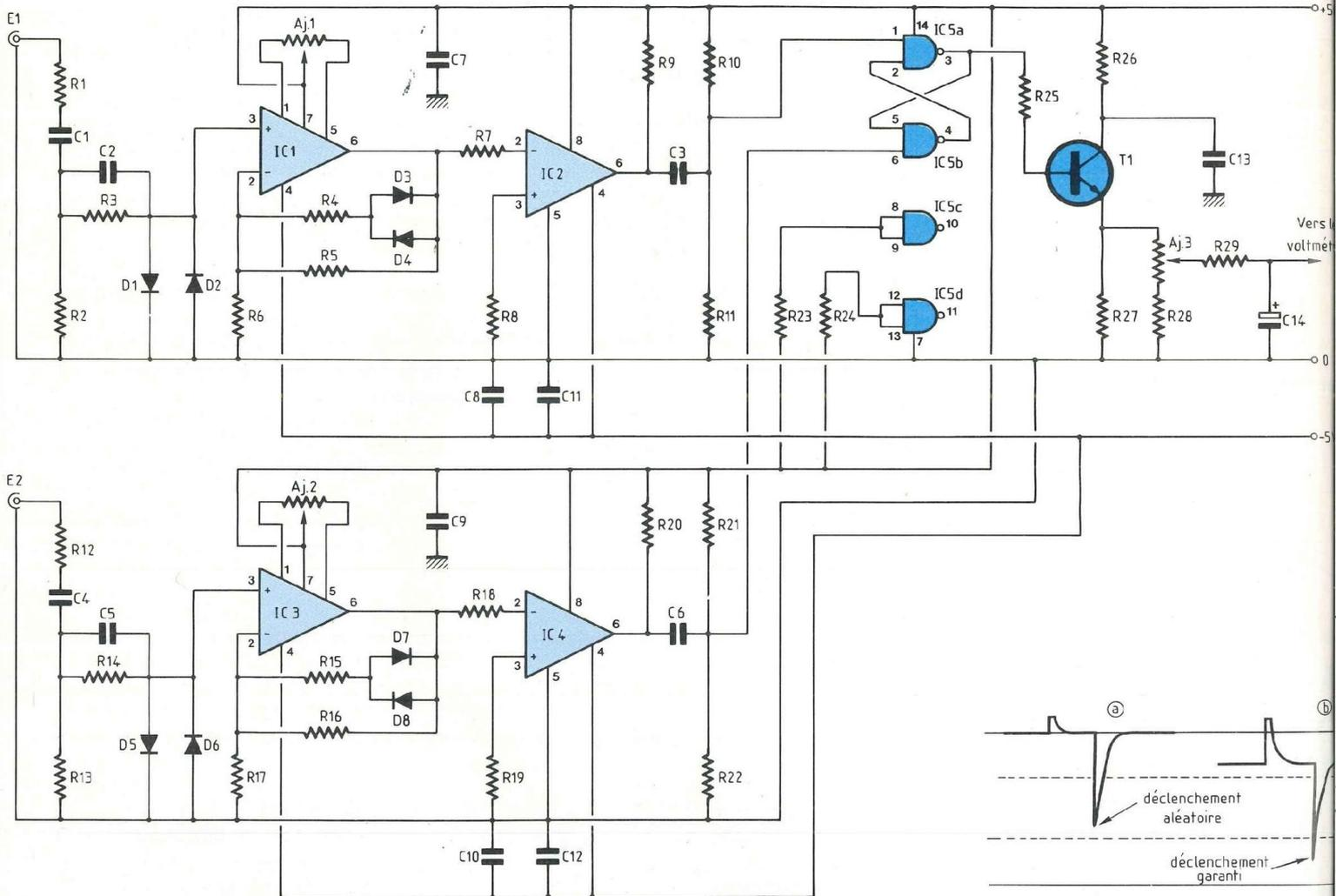
Fig. 9 : Etages d'entrée et bascule RS.
