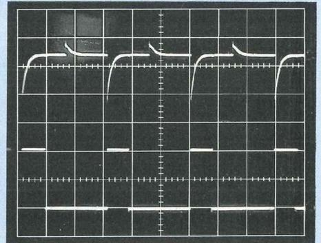
G. En haut, impulsions du canal E1. En bas, impulsions en sortie de la bascule RS, après réaligement au niveau zéro par le transistor T1 (5 V/division).
