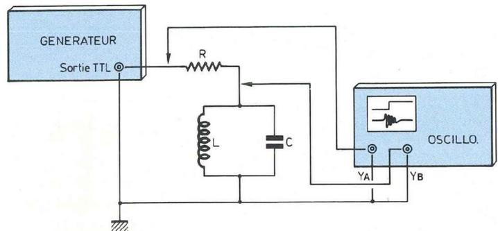
Fig. 3 : Mesure de la période et de l'amortissement.
