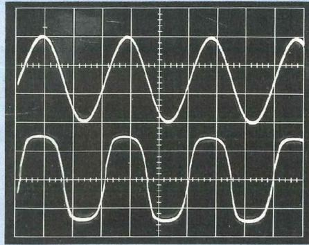
C. Mécanisme de limitation du gain sur les amplis. En haut, la sinusoïde d'entrée (500 mV/division). En bas, signal en sortie de IC1 (2 V/division) ; on distingue, au voisinage du zéro, la zone à gain élevé.
