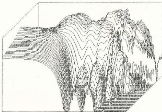
Fig. 4A : Courbe amplitude-fréquence-temps d'une enceinte acoustique réalisée par ordinateur.
