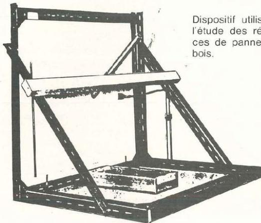
Dispositif utilisé pour l'étude des résonances de panneaux en bois.
