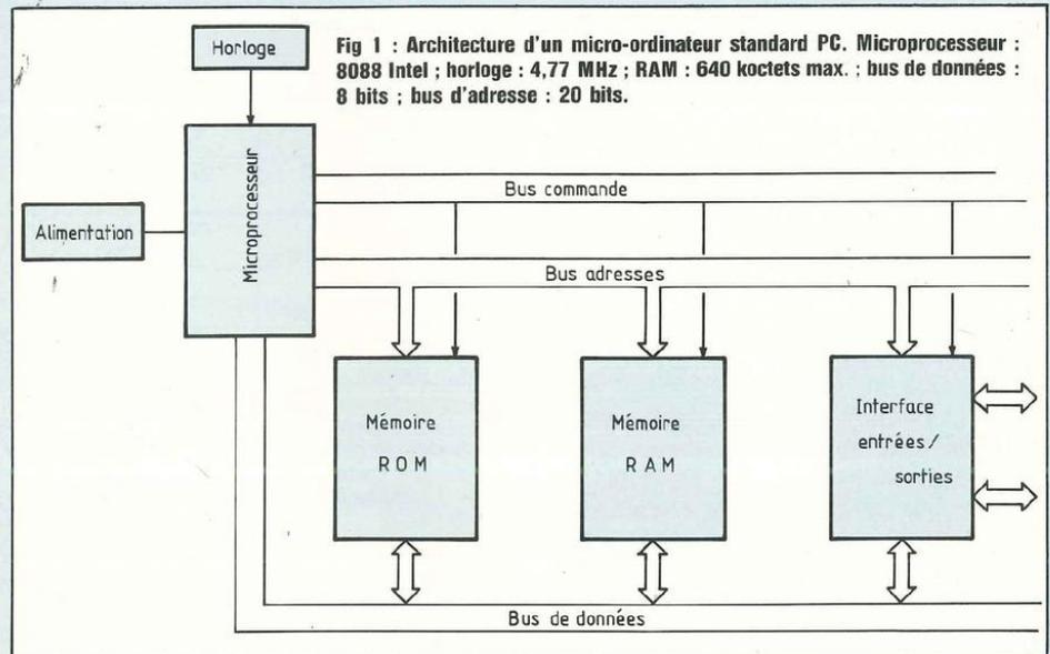
Sous forme de circuits intégrés : mémoire centrale ou de périphériques : mémoire de masse, la mémoire a pour fonction de stocker les informations traitées par le microprocesseur. Dans le cas de la mémoire centrale, on trouve deux types de composants, les RAM (Random Access Memory ou Mémoire à accès aléatoire) et les ROM (Read Only Memory ou mémoire à lecture seule).
