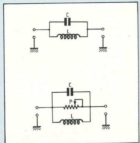
Ce circuit est placé en série avec la cellule de filtrage (P.H., P.B.).
