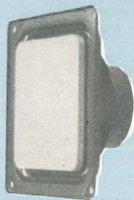
15 cm de côté est réalisée dans un matériau composite constitué de deux feuilles d'aluminium prenant en sandwich une structure de type nid d'abeilles entièrement amortie par de la mousse polymère. Ces haut-parleurs se caractérisent par une bonne réponse transitoire (légèreté du diaphragme), un minimum de distorsion (fonctionnement en piston sans déformation).
