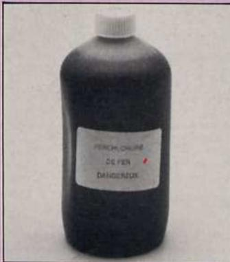
**Perchlorure de fer, pour gravure des circuits imprimés.**
