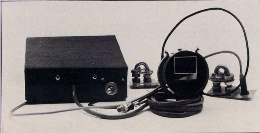
**L**e montage permet de lire sur 2 afficheurs 7 segments la vitesse en kilomètres/heure ou la distance parcourue en kilomètres pour bicyclette avec roues de 680 ou 610 mm.
