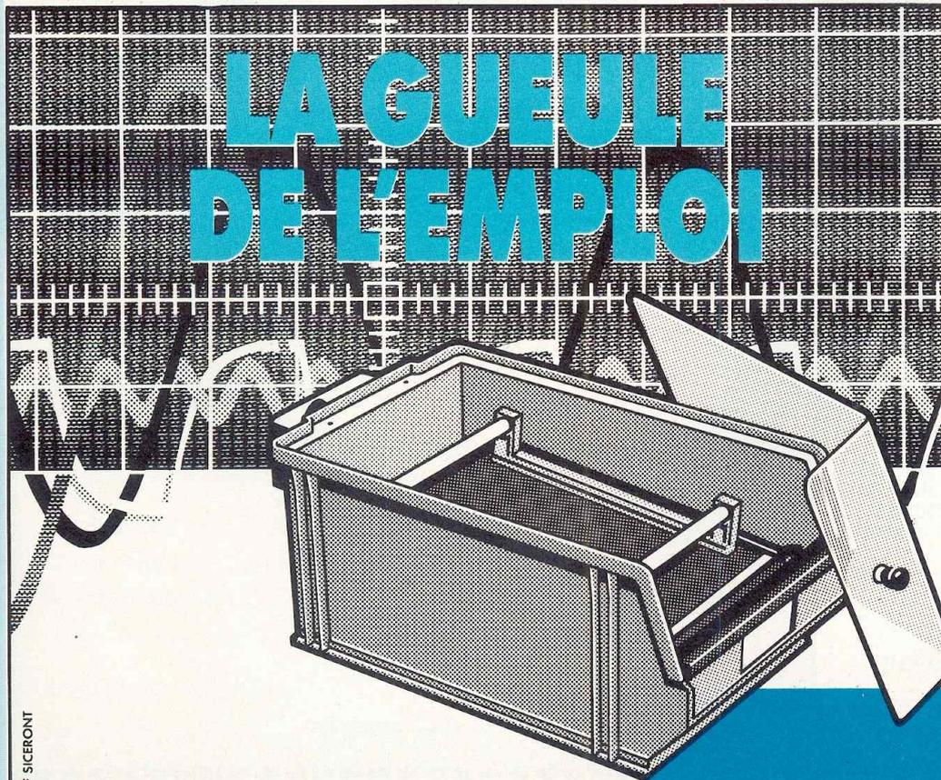
**L**es Graves Vite 1 et 2 sont des machines à graver les circuits imprimés simple et double face.
