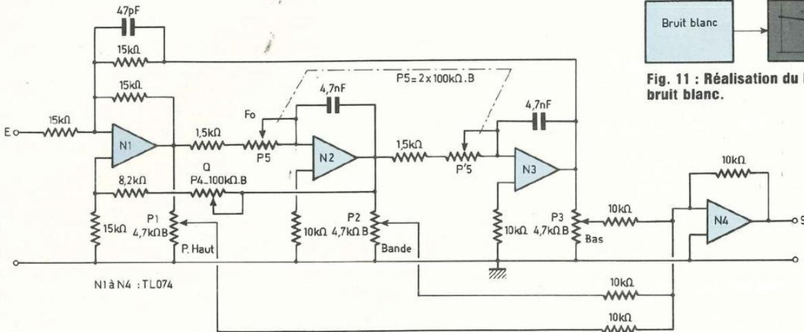
Fig. 10 : Schéma d'un égaliseur paramétrique à trois sorties.
