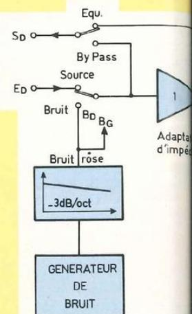
Fig. 1 : Schéma de principe de l'égaliseur (voie droite).
