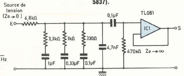
Fig. 13 : Filtre de bruit rose à -3 dB/octave.
