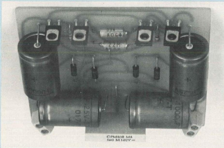
La réalisation que nous proposons permet d'obtenir une tension d'alimentation symétrique négative de  $-12\text{ V}$  par rapport à une référence unique  $0\text{ V}$ . On voit donc qu'en utilisant à l'entrée une source positive de  $+12\text{ V}$ , soit une batterie ordinaire, on bénéficie en sortie d'une double tension de  $\pm 12\text{ V}$  par rapport à la masse.
