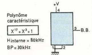
Fig. 12c : GPA intégré de National Semiconductor (MM 5837).
