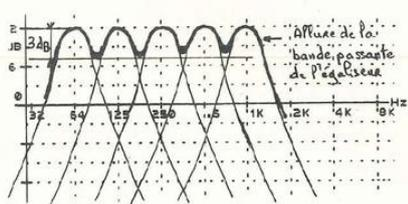
Fig. 9b : Réponse des filtres à bandes étroites.
