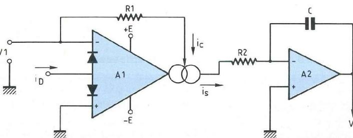
Fig. 17 : Elévation au carré et intégration.
