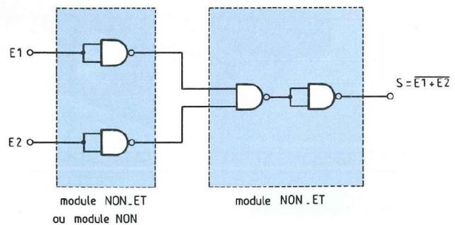
Fig. 3 : Construction de la fonction logique NON-OU.
