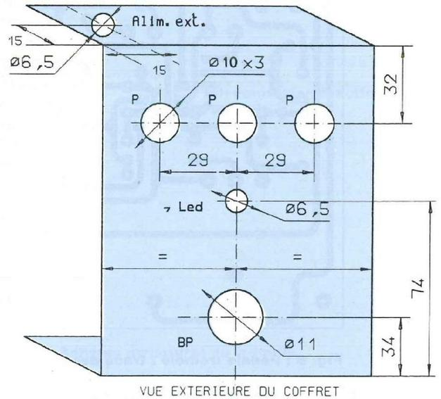
Fig. 8b : Perçage de la face avant.
