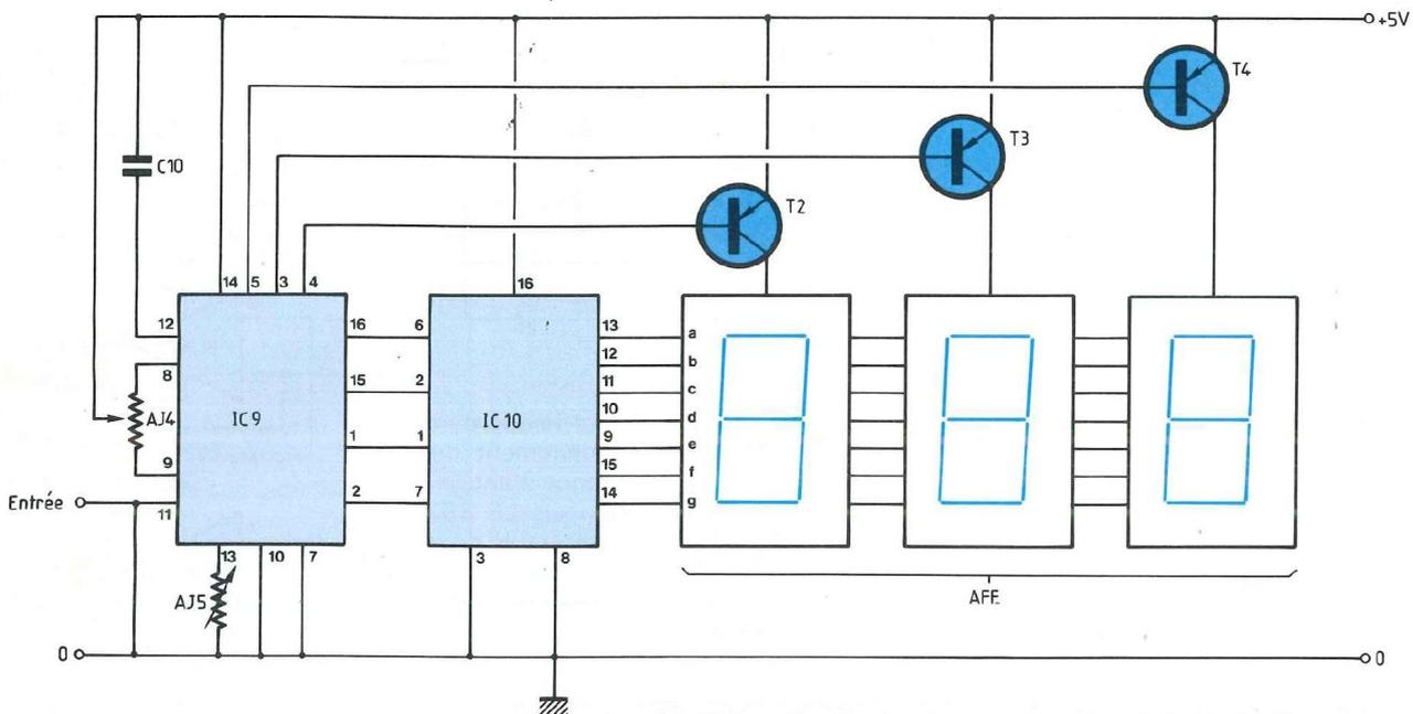
Fig. 22 : Section voltmètre.
