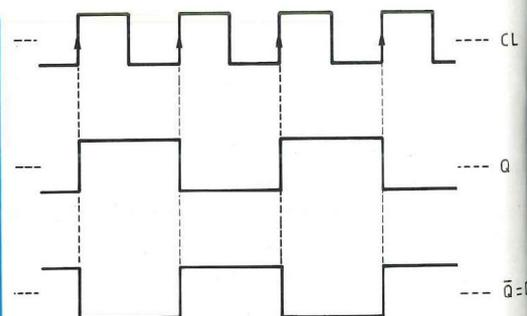
Fig. 4 : Diagrammes du fonctionnement en diviseur par 2.
