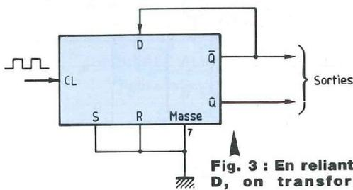
**Fig. 3 : En reliant la sortie  $\bar{Q}$  à l'entrée D, on transforme la bascule en compteur/diviseur par 2 ( $R = S = 0$ ).**
