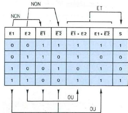
Fig. 6 : Construction, pas à pas, de la table de vérité du montage de la figure 5.
