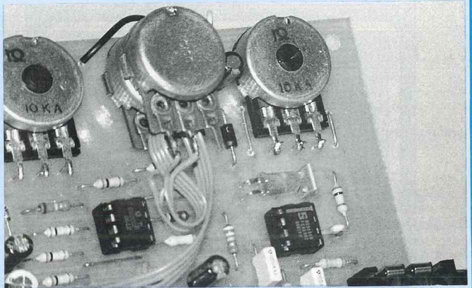
**Détail du couplage optique entre la LED et la LDR07. Pour faire des essais du module hors boîtier, il faut nécessairement isoler ces composants par du chaterton noir et coller une bande de chaterton noir du côté des pistes (l'époxy est translucide... et laisse passer la lumière !!).**
