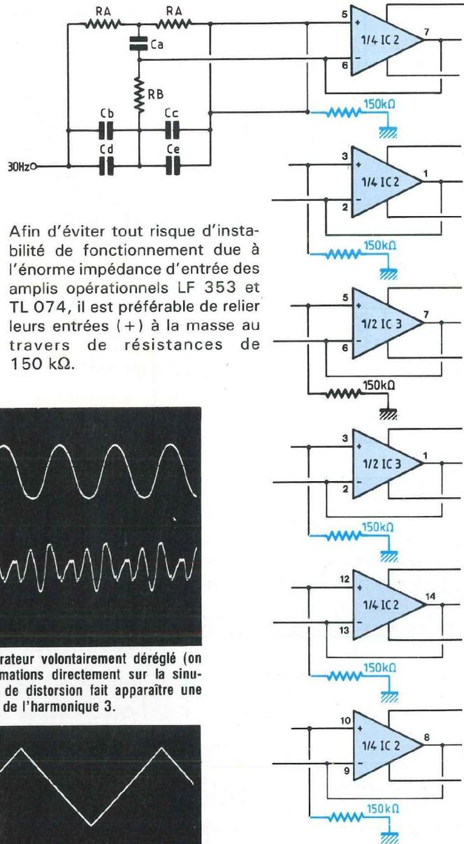
Afin d'éviter tout risque d'instabilité de fonctionnement due à l'énorme impédance d'entrée des amplis opérationnels LF 353 et TL 074, il est préférable de relier leurs entrées (+) à la masse au travers de résistances de 150 kΩ.
