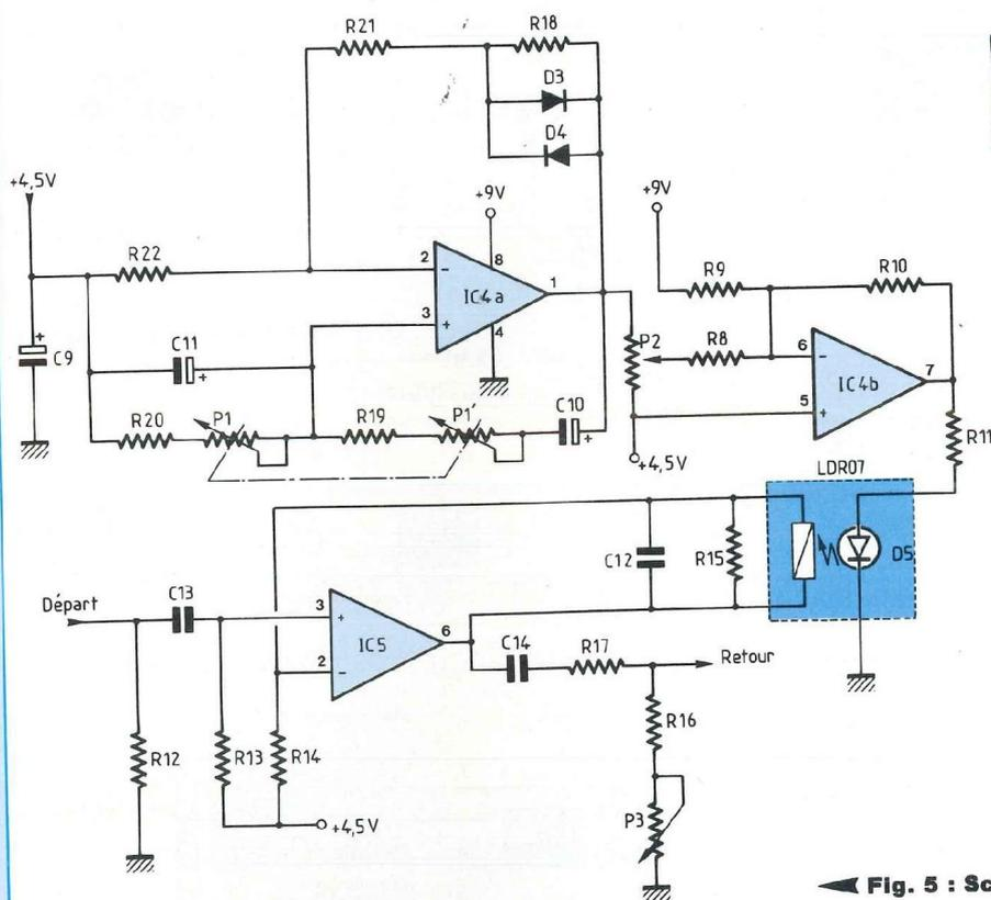
◀ Fig. 5 : Schéma structurel du trémolo.
