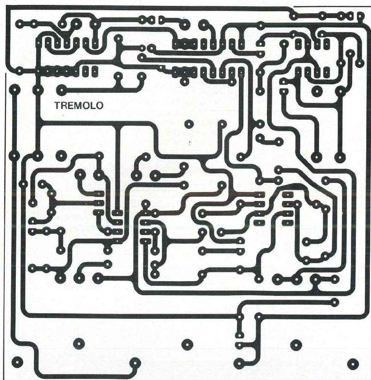
Fig. 6 : Pédale trémolo : tracé des pistes.
