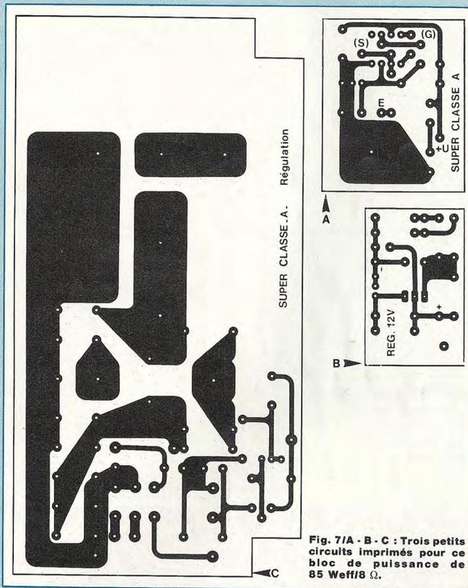
Fig. 7/A - B - C : Trois petits circuits imprimés pour ce bloc de puissance de  $85 \text{ W eff.}/8 \Omega$ .
