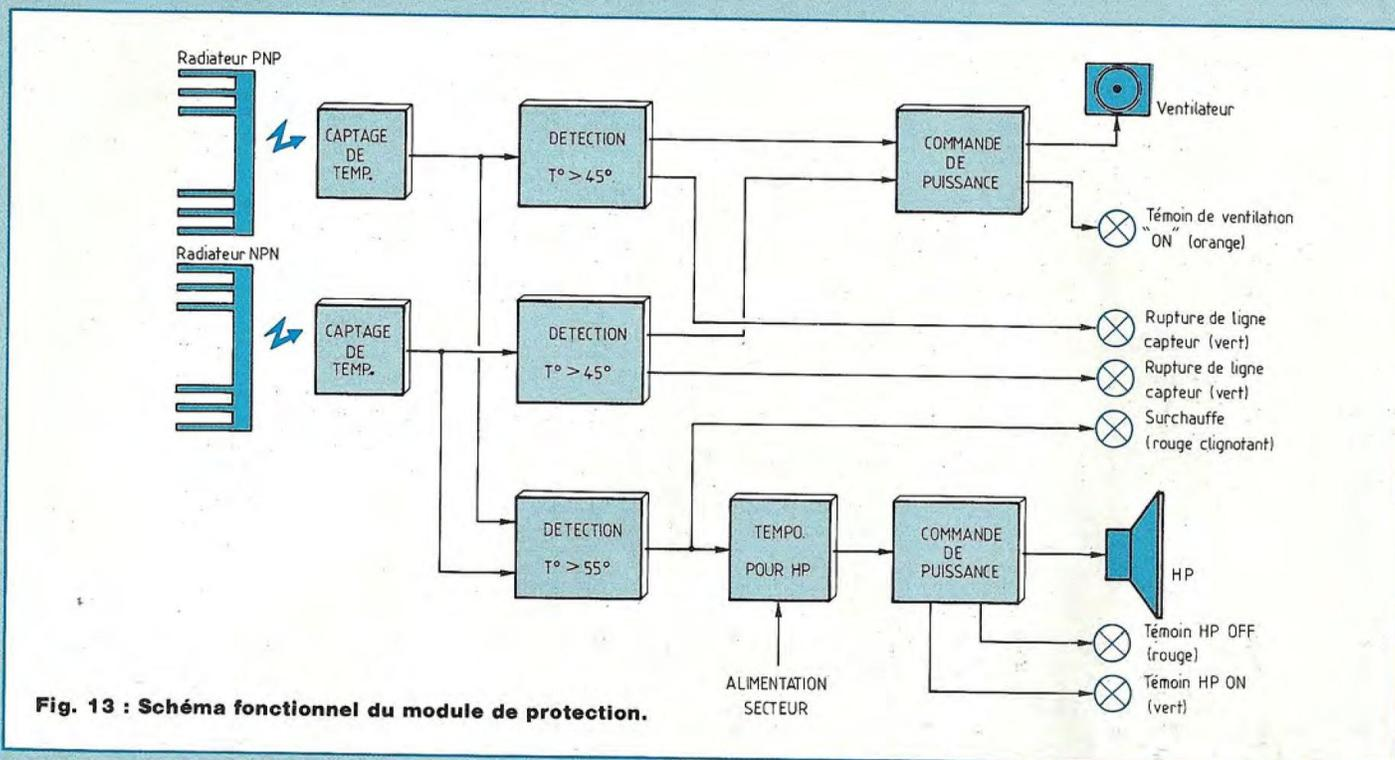
Fig. 13 : Schéma fonctionnel du module de protection.
