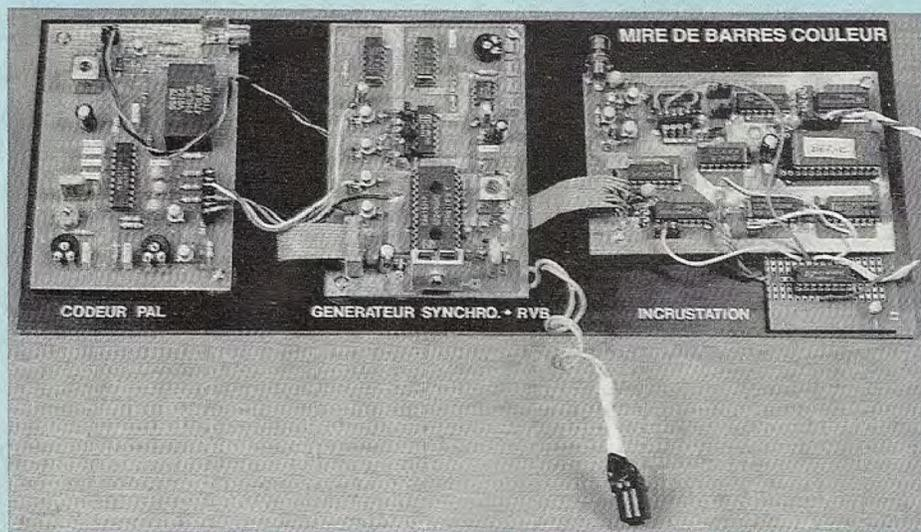
Notre mire de barres couleur (PAL) est composée de deux platines : Générateur de synchro et signaux RVB et Codeur PAL. L'ensemble de ces deux modules permet d'obtenir une mire de 8 barres couleur avec un minimum de composants.
