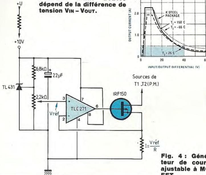
**Fig. 4 : Générateur de courant ajustable à MOSFET.**
