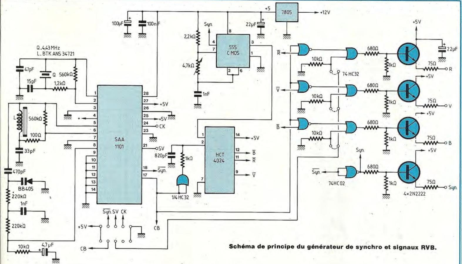
Schéma de principe du générateur de synchro et signaux RVB.
