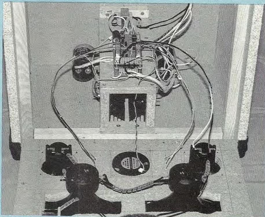
**Association et câblage du panneau frontal. On peut voir les deux vis de fixation du couloir de ventilation devant les radiateurs. L'un des orifices de passage du tour-nevis permet de faire passer les câbles du ventilateur.**
