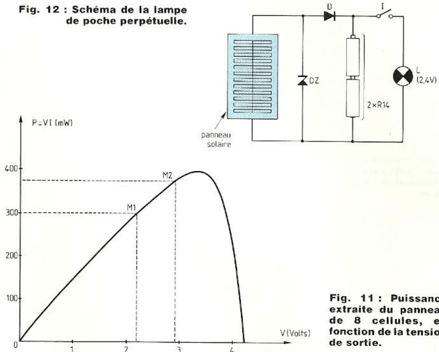
Fig. 11 : Puissance extraite du panneau de 8 cellules, en fonction de la tension de sortie.
