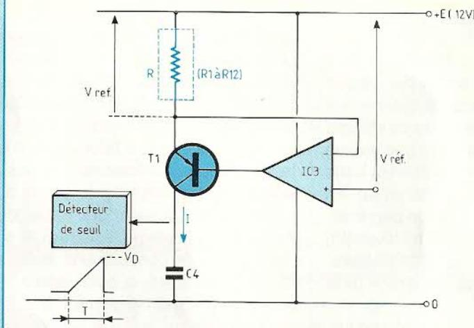
**Fig. 4 :** Le condensateur de temporisation  $C_4$  se charge à courant constant à travers le générateur constitué par  $T1$  et  $IC3$ . L'intensité  $I$ , donc la temporisation, dépend du choix des résistances  $R1$  à  $R12$ .
