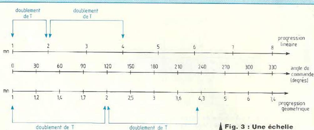
**Fig. 3 :** Une échelle linéaire des temporisations conduit à une imprécision des faibles durées. La précision reste au contraire constante si on adopte une progression géométrique.
