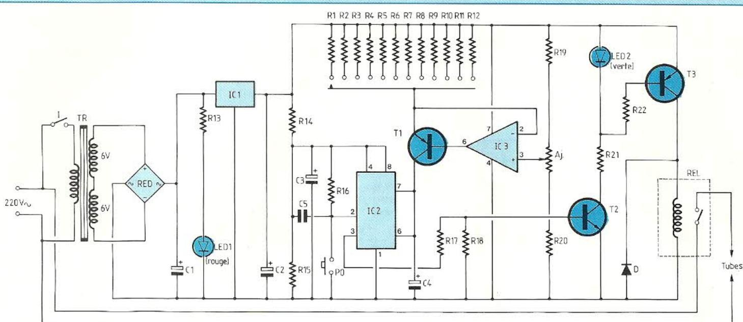
Fig. 5 : Schéma complet de la minuterie.
