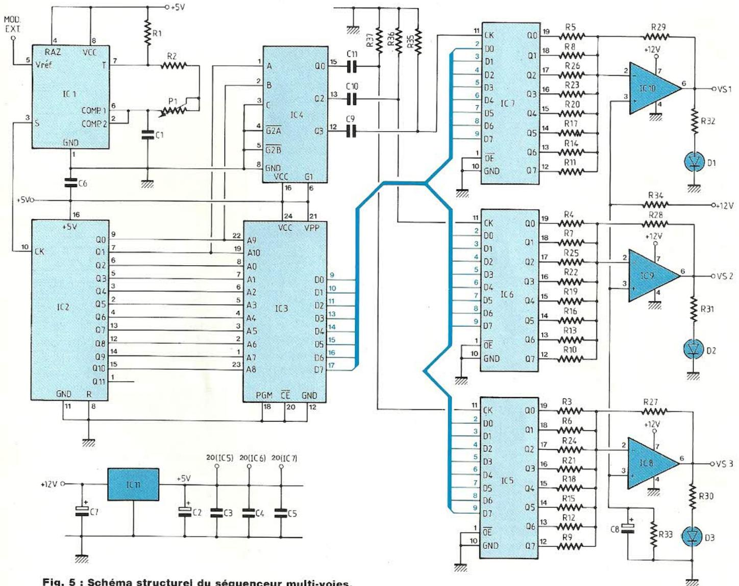
Fig. 5 : Schéma structurel du séquenceur multi-voies.
