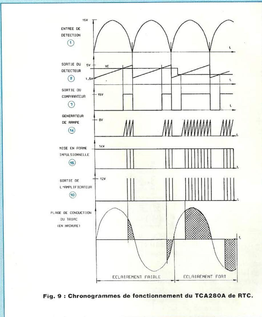
Fig. 9 : Chronogrammes de fonctionnement du TCA280A de RTC.
