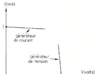
**Fig. 6 :** Caractéristiques d'un générateur de tension et d'un générateur de courant. Les intensités  $I$  (ordonnées) sont représentées en fonction des tensions  $V$  (abscisses).
