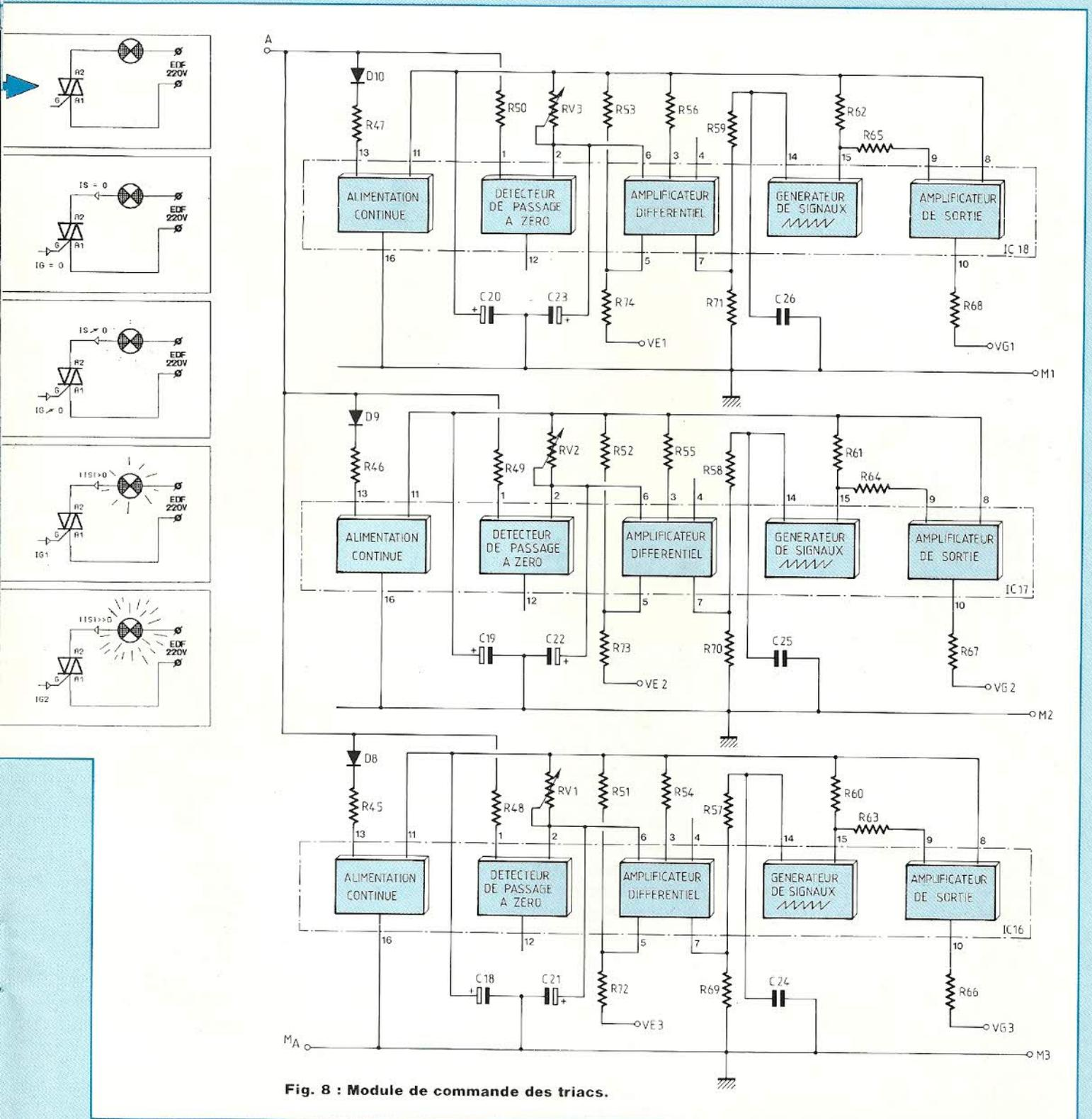
Fig. 8 : Module de commande des triacs.
