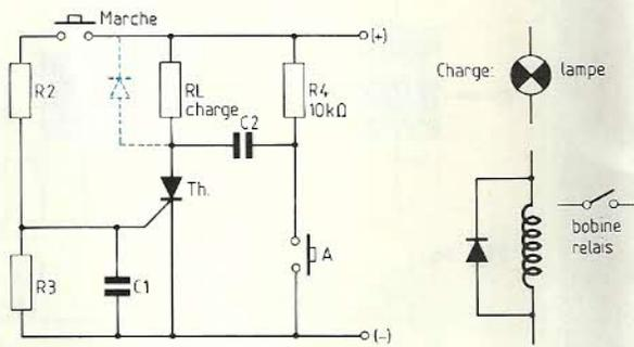
potentiel positif dépassant le seuil de déclenchement, le thyristor s'amorce. Une brève impulsion suffit (quelques microsecondes).
