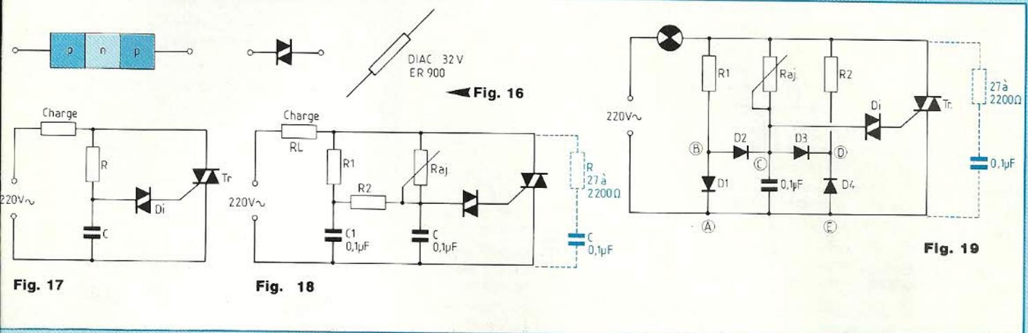
rupteur unilatéral au silicium, fonctionne en interrupteur commandé en tension mais dont la tension seuil de déclenchement est stabilisée par une diode Zener.
