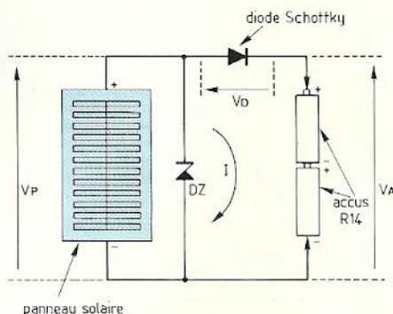
**Fig. 10 :** Circuit minimum pour la charge d'accumulateurs.
