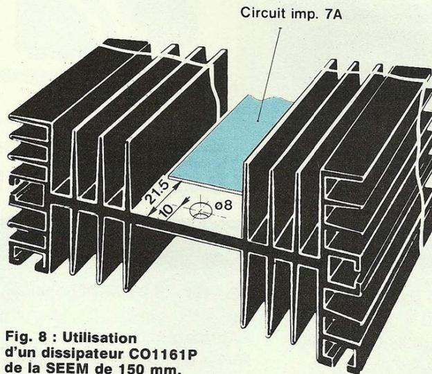
**Fig. 8 :** Utilisation d'un dissipateur CO1161P de la SEEM de 150 mm.
