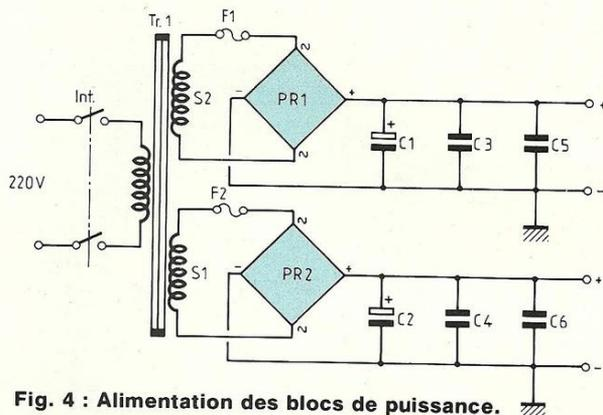
Fig. 4 : Alimentation des blocs de puissance.
