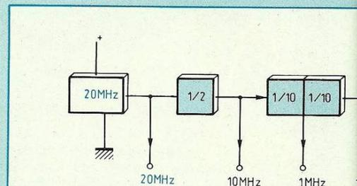
Fig. 1 : Synoptique de l'étalon de fréquence.
