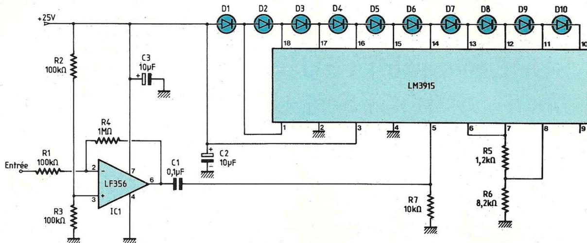
Fig. 1 : Schéma de principe faisant appel au LM 3915 de National Semiconductor.
