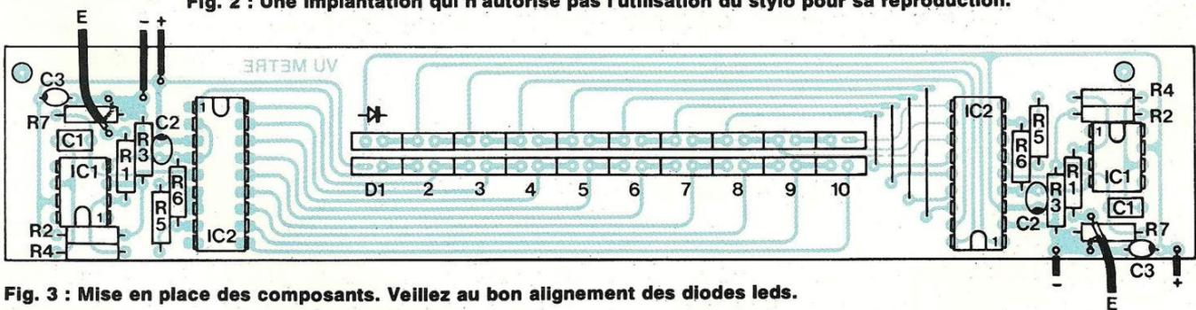
Fig. 3 : Mise en place des composants. Veillez au bon alignement des diodes leds.
