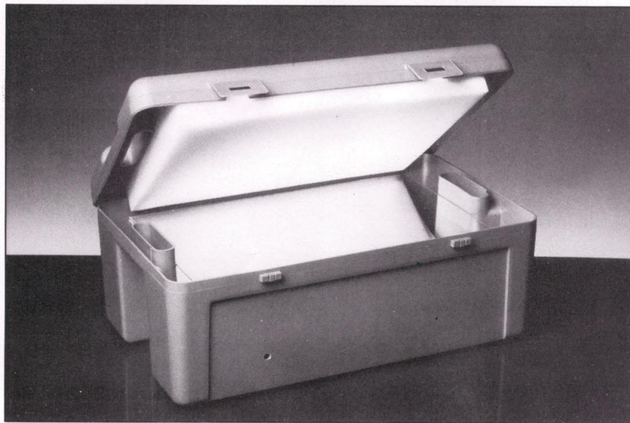
Le dernier-né des bancs à insoler, livré en kit. La gamme 500. Coffret en plastique, avec fermetures, contenant les pièces et fils nécessaires au montage. La minuterie, les starters, les deux tubes actiniques et les douilles se placent et se câblent facilement et rapidement.. Surface d'insolation 270 \times 400 mm, minuterie temporisée de 0 à 7 minutes. Les tubes s'allument et s'éteignent automatiquement à la fin du temps d'insolation choisi. Simple à monter, simple à utiliser.
