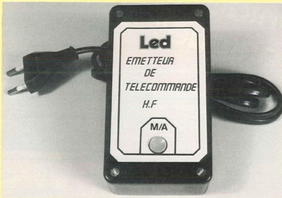
L'ensemble dont nous proposons séparément les réalisations s'appelle plus communément une télécommande secteur. De quoi s'agit-il ? Le principe, très simple, consiste à superposer à la fréquence secteur 50 Hz une haute fréquence de l'ordre de 100 kHz qui véhicule l'information, donc uniquement support et ne perturbe pas le fonctionnement de tous les appareils connectés sur la ligne.
