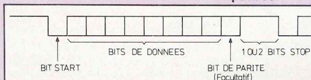
Fig. 1 : Format de transfert d'une liaison série asynchrone.
