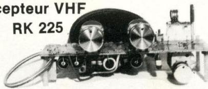
Couvre de 70 à 200 MHz par selfs interchangeables très faciles à réaliser, sensibilité élevée (1- $\mu$ V). Stabilité parfaite, montage à 2 transistors et 1 circuit intégré, recherche des stations par varicap, circuit imprimé fourni, livret très détaillé.
