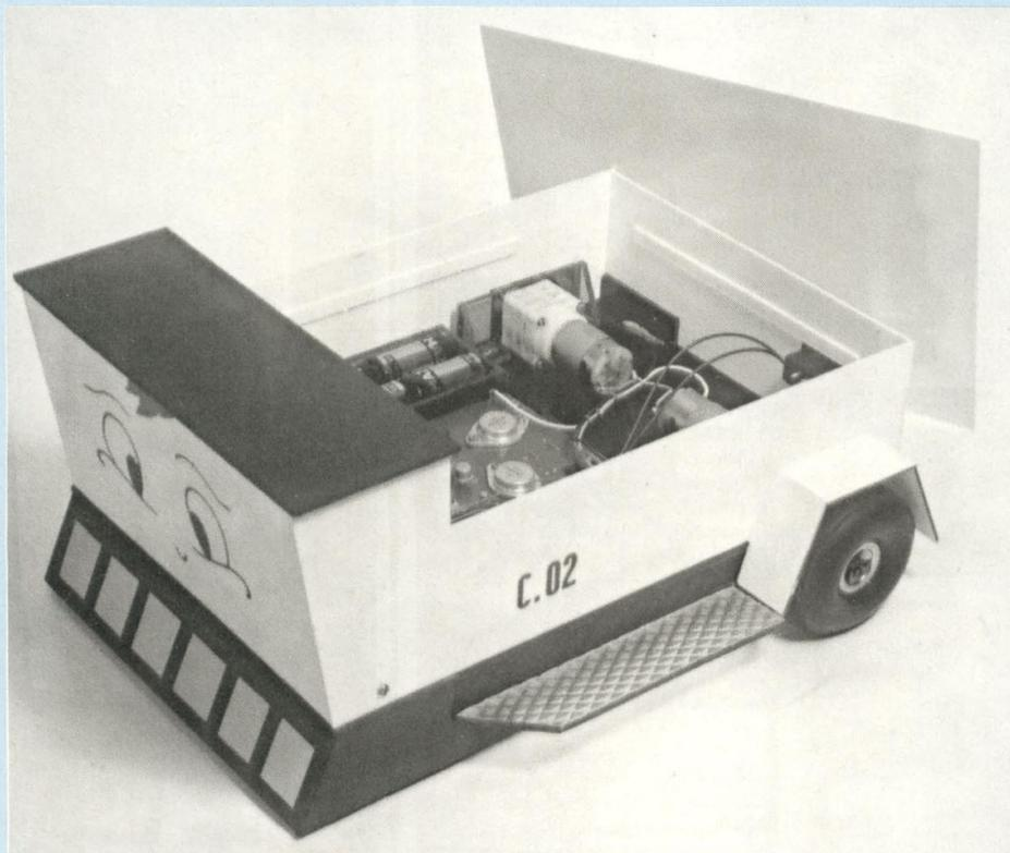
Le premier robot dont nous allons entreprendre la réalisation peut suivre, grâce à son système de vision très particulier, une ligne blanche tracée sur un sol foncé, parcourant ainsi un itinéraire conçu par vos soins et modifiable à volonté. Ce principe est utilisé dans l'industrie pour le guidage de certains engins autonomes de manutention.
