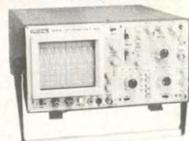
2 x 20 MHz. Sensibilité verticale 5 mV/div. Ligne à retard. Testeur de composants. Recherche automatique de la trace. Deux sondes (x 1, x 10)
