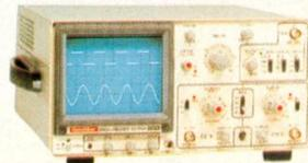
Bande passante 2 x 20 MHz, sensibilité 1 mV/div, entrée maxi 500 vpp ou 300 v, special tv sync, rise time à moins de 17,5 n sec, modes trigger auto, norm, tv-v ou tv-h, coupleur AC, HF, LF, DC. GARANTI 1 AN
