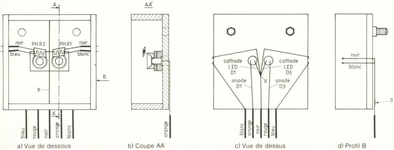
Fig. 6 : Montage des capteurs et câblage.
