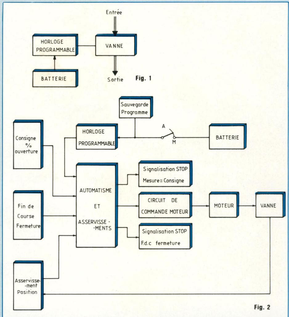
deux sens de rotation, par l'intermédiaire d'ordres émis par l'électronique de mesure et d'asservissement.
