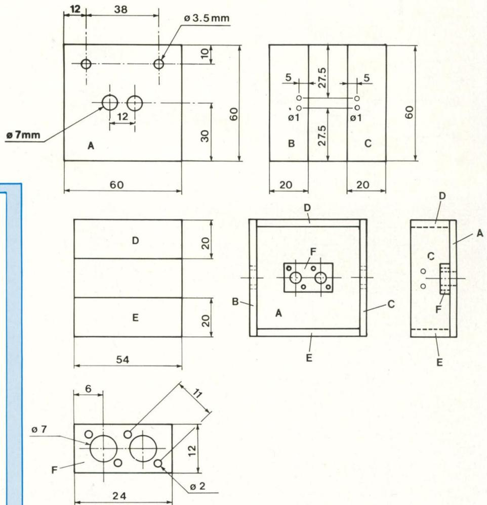
Fig. 5 : Réalisation du boîtier système de vision. Plexiglass noir 3 mm ép.
