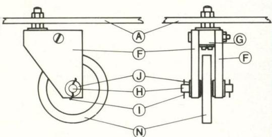
Fig. 15 : Montage des roues avant (échelle 1/2).
