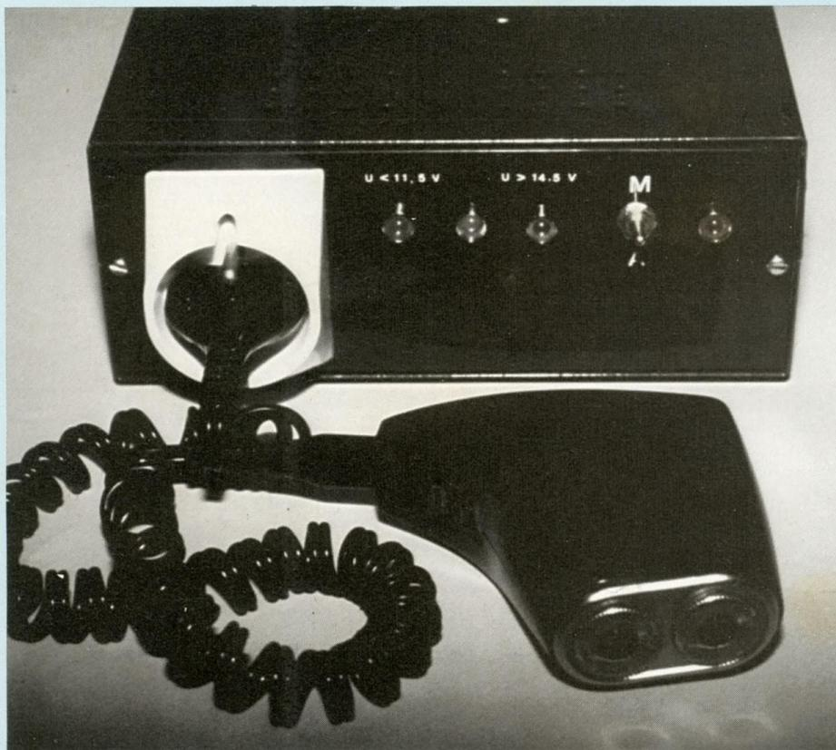
Transformer le réseau 220 volts alternatif en une tension continue se réalise facilement : c'est l'alimentation. Malheureusement cet appareil n'est pas réversible et la transformation inverse continu-alternatif, beaucoup plus délicate, nécessite un dispositif électronique appelé : convertisseur, onduleur ou inverter en anglais.
