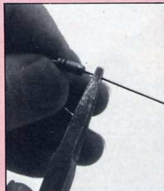
Pliage d'une résistance à l'aide d'une pince plate.
