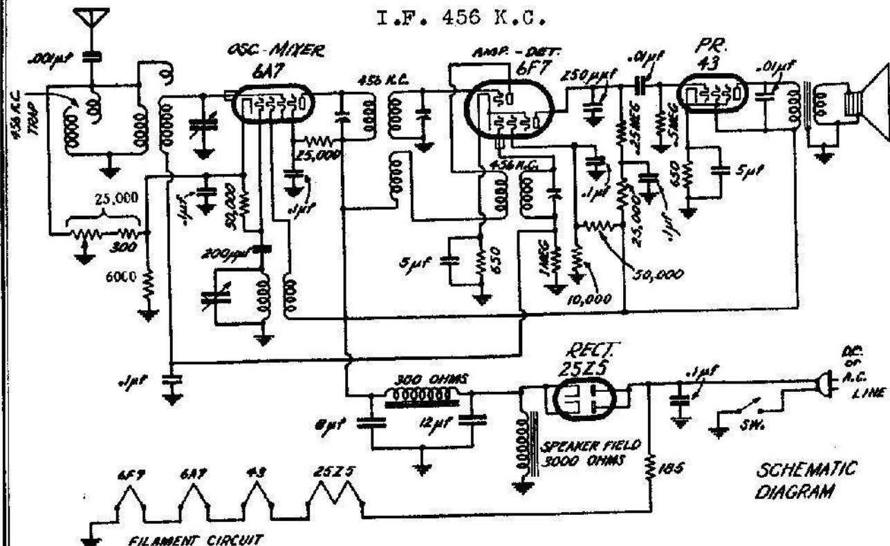
**CAUTION — UNDER NO CIRCUMSTANCE ALLOW A GROUND WIRE TO COME IN CONTACT WITH THE METAL PARTS OF THIS RECEIVER.**
