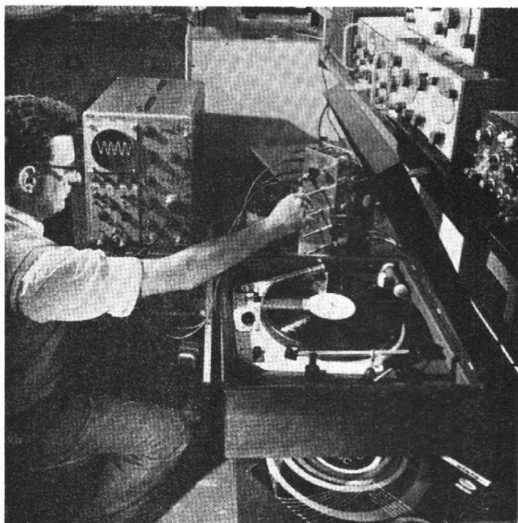
Contrôle d'un amplificateur basse fréquence à circuits intégrés.
