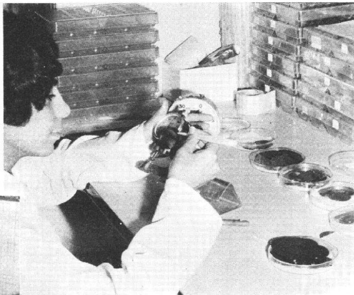
*Leur épaisseur est soigneusement mesurée au micromètre.*
