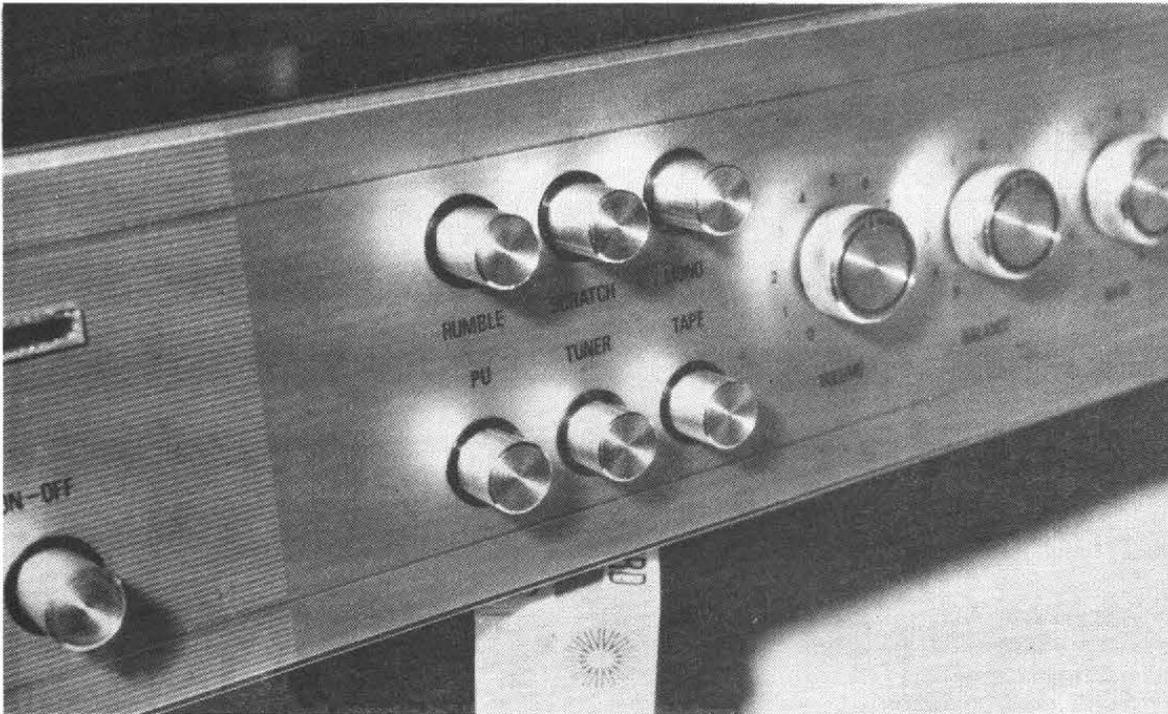
Trois boutons poussoirs permettent de sélectionner les entrées, deux autres de mettre en service des filtres, le dernier de fonctionner en monaural.
