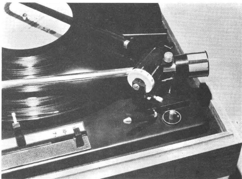
L'axe supportant le bras tubulaire est incliné à 45°. Cette disposition permet au tourne-disque de fonctionner même s'il n'est pas placé rigoureusement à l'horizontale.
