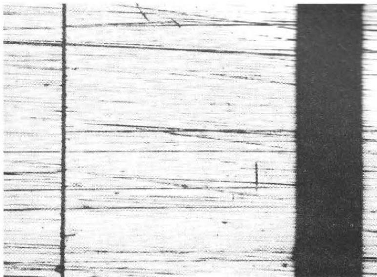
Plus fine qu'un cheveu... telle est la largeur de l'entrefer de la tête magnétique d'un magnétophone. Cette microphoto magnétique montre un entrefer. La « poutre » épaisse et foncée (à droite) est un cheveu, placé ici à titre de comparaison.
