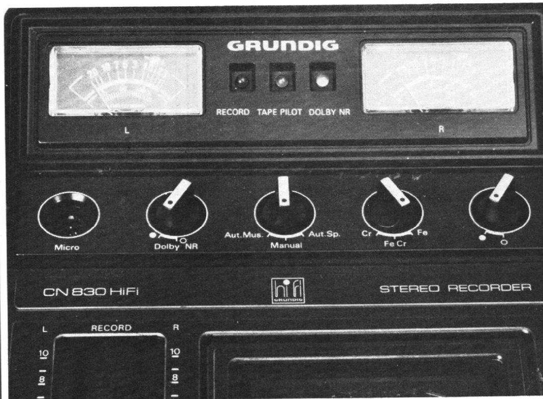
Photo 7. - Les commandes du magnétophone, les boutons servent à choisir divers paramètres d'enregistrement.
