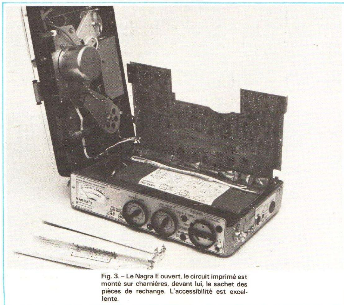
Fig. 3. - Le Nagra E ouvert, le circuit imprimé est monté sur charnières, devant lui, le sachet des pièces de rechange. L'accessibilité est excellente.
