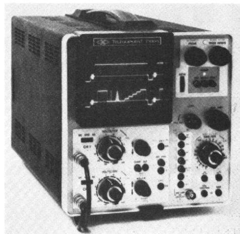
Il bénéficie, par rapport au D66, d'un déclenchement plus performant, d'un panneau avant redessiné et identique à celui du D67A avec un nombre de commandes réduit facilitant ainsi l'utilisation.
