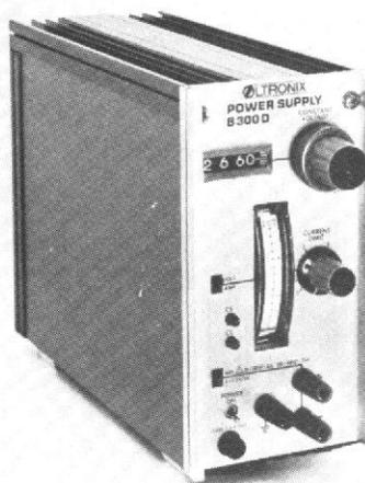
Une nouveauté réside dans le fait que ces alimentations peuvent être surchargées. En effet, deux circuits de limitation de courant, l'un ajusté par l'utilisateur, l'autre commandé en fonction de l'élévation de température du boîtier, permettent jusqu'à 100 % de surcharge momentanée. Cela est très utile surtout pour des charges pulsées qui, avec une limitation de courant conventionnelle, peuvent provoquer des chutes de la tension de sortie.
