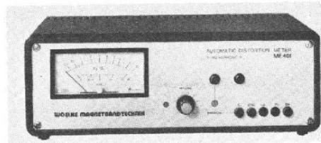
Le ME 401 est un nouveau distorsiomètre automatique à lecture directe (harmonique 3), pour le réglage des magnétophones et magnétocassettes. Le ME 401 a été réalisé pour satisfaire aux besoins exprimés par les plates-formes d'essais et les ateliers de réparation. Il est d'utilisation universelle, maniable et léger.
