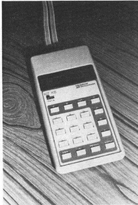
Photo 8. - Ce clavier de calculatrice et 8 heures de wrapping remplacent avantageusement le téléimprimeur sur lequel on s'interrogeait dans le précédent article. De cette manière « l'introkit » est remplacé par un « télékit » (chez National Semiconductor).
