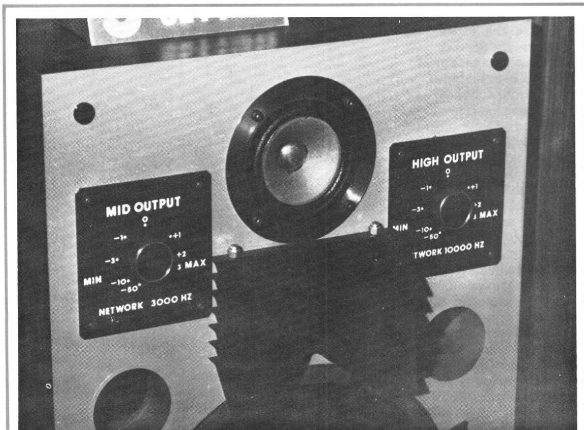
Photo 1. - Prototype d'enceinte Setton. Utilisation d'une lentille acoustique.
