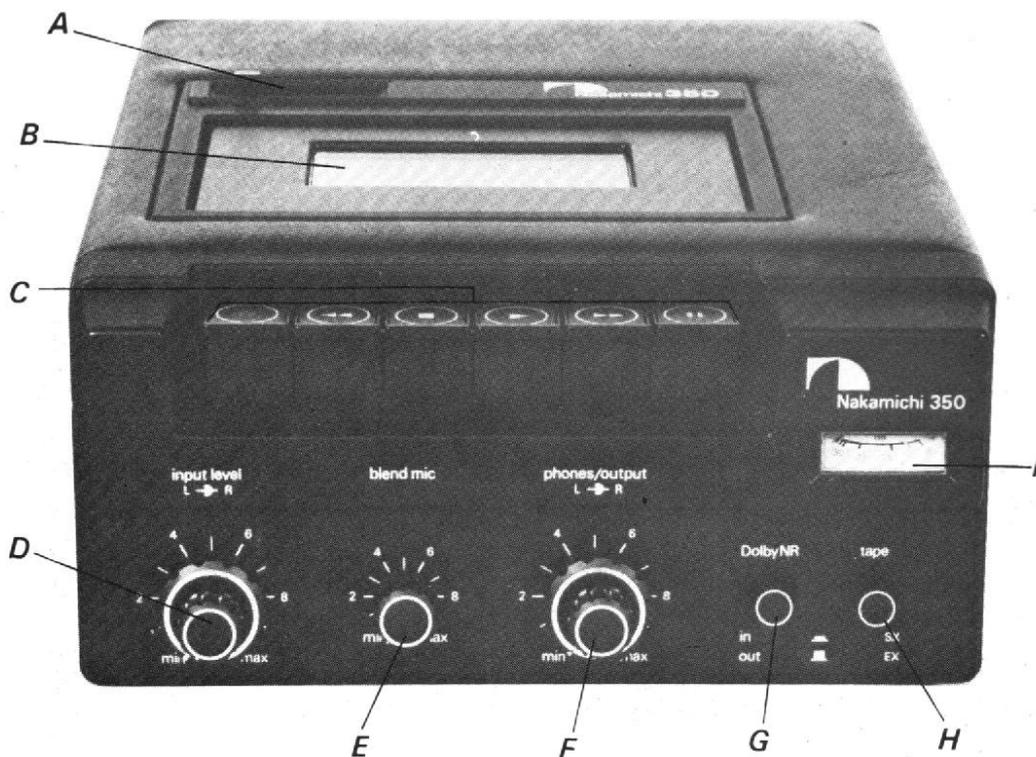
Photo C. a) compteur et bouton de remise à zéro. b) logement de la cassette. c) clavier de défilement. d) niveau d'entrée et niveau du micro central. f) niveau de sortie. g) Dolby, touche marche-arrêt. h) type de bande. i) indicateur de modulation.
