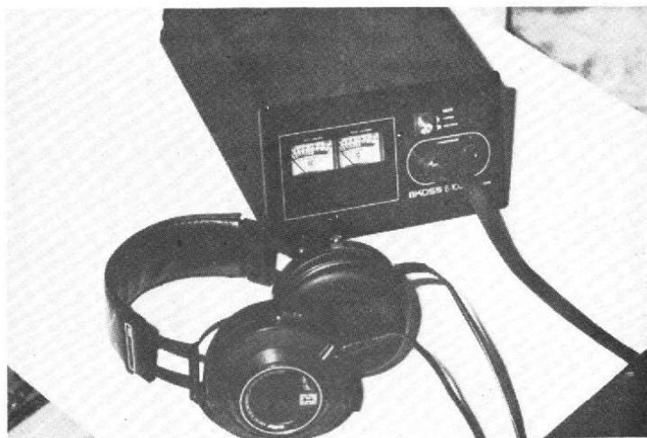
Photo 9. - Nouveau casque électrostatique de Koss, le boîtier est équipé de deux indicateurs de modulation et d'un voyant de surcharge. Casque portant la signature de John Koss.
