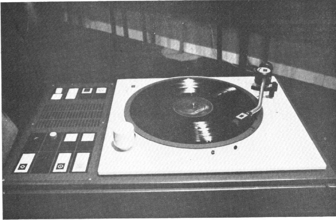
Photo 1. - Table de lecture de disques EMT 950. Plateau léger, asservissement de la vitesse, moteur pour entraînement direct. Les commandes sont rassemblées sur la gauche, elles peuvent être placées à proximité de la console de mélange.
