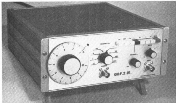
Photo H. - Le générateur GBF 2.01 de CHAUVIN ARNOUX, est équipé d'un dispositif de décalage de la tension de sortie.
