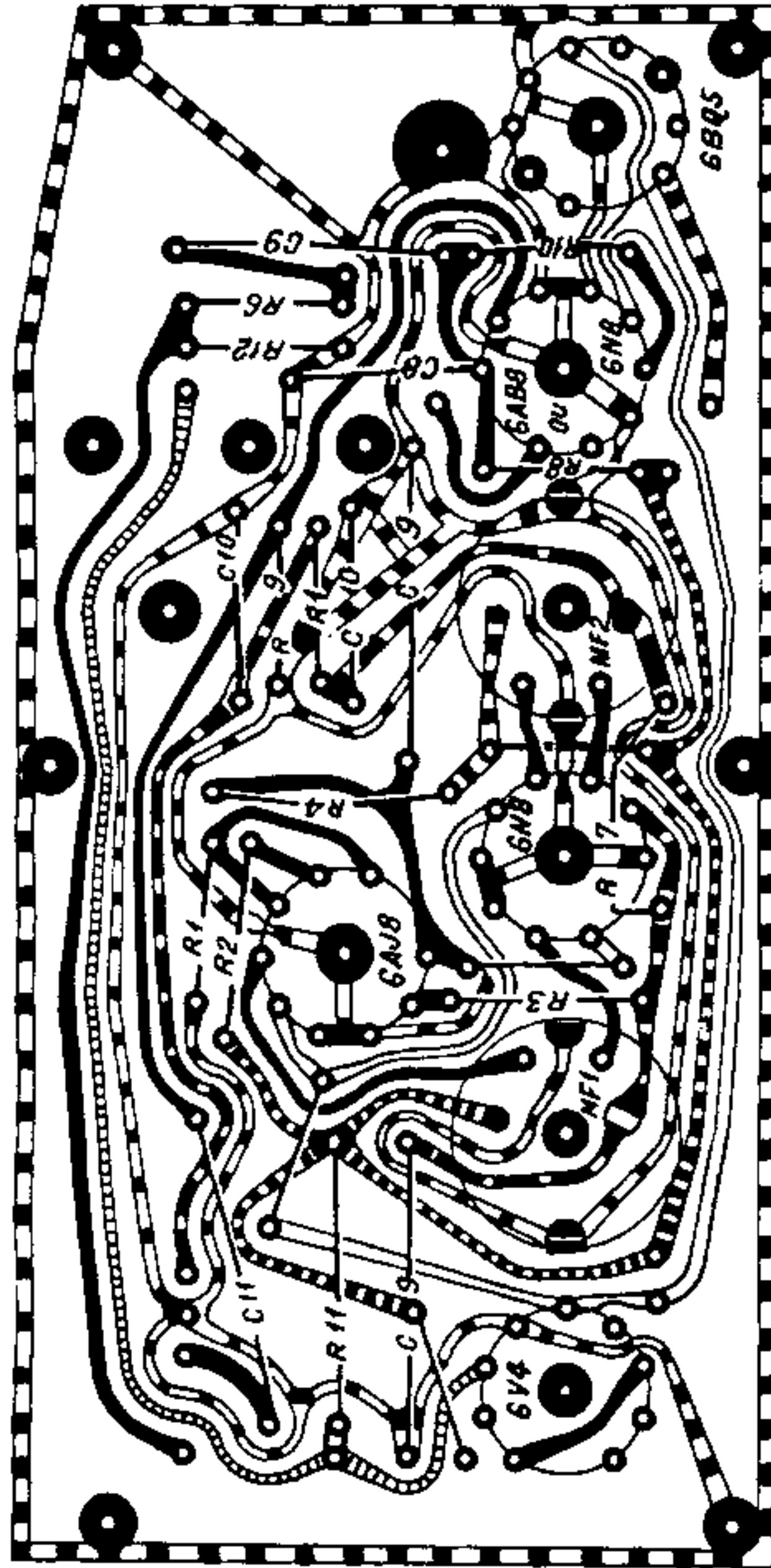
**Plaque à câblage imprimé du récepteur « Sirius ».**
