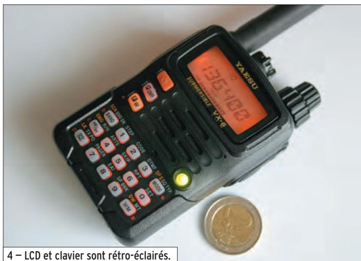
4 – LCD et clavier sont rétro-éclairés.
