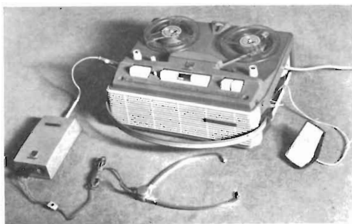
Photo 14 La reproduction de bandes stéréo est possible en montant un pré- amplificateur séparé sur un magnétophone adéquat.
