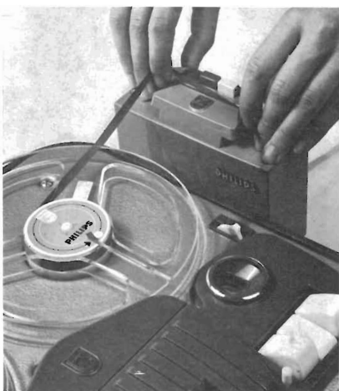
Photo 13 Introduction de la bande dans le Synchro- dia, monté proche du magnétophone.
