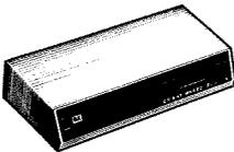
Quand il vous est impossible d'intervenir au niveau même de votre antenne (déjà au maximum d'éléments) ou que l'antenne collective de votre immeuble vous fournit un signal bien trop faible pour 1 ou 2 téléviseurs, cet ampli s'installe près du téléviseur, se alimente en 220 V, gain 26 à 24 dB entre 40 et 890 MHz (tous canaux + FM), impéd. d'entrée et sortie 75 ohms, niveau maxi. 100 dB/μV. Dim. 224 x 52 x 110 mm. Réf. DX ..... 385 F
