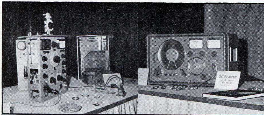
A gauche, banc d'essai pour radar de 3 cm, 890 A. — A droite, générateur UHF-VHF, 801 B.
