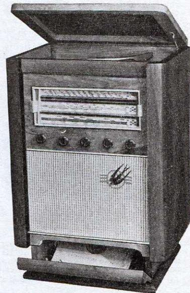
de commande. Il permet, dans les immeubles où la réception est rendue difficile par la présence de nombreux parasites, une audition remarquablement pure. Un étage d'amplification haute fréquence confère au récepteur une sensibilité moyenne utilisable de l'ordre de 10  $\mu$ V et permet, sur les gammes O.C. et B.E. de fonctionner avec une antenne incorporée.
