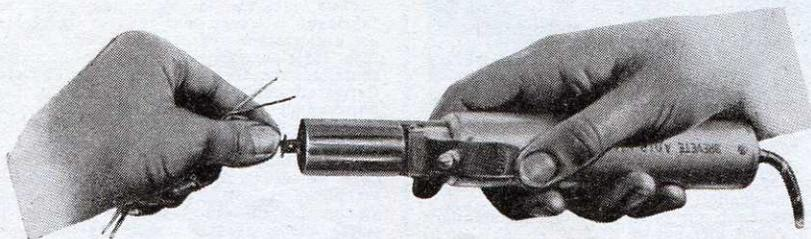
couches soie ou coton ou recouverts de caoutchouc, de gutta ou d'isolant synthétique. Le conducteur peut être unique ou formé de plusieurs brins. Elle ne permet pas le décapage du fil à brins multiples émaillé (Litzendraht) utilisé dans la fabrication des bobinages radioélectriques H.F. et M.F.
