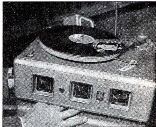
Grâce à son bras flexible et à son tampon de feutre plaqué contre le disque, ce tourne-disques BOUYER peut lire un microsillon... même à bord d'une « Jeep ».
