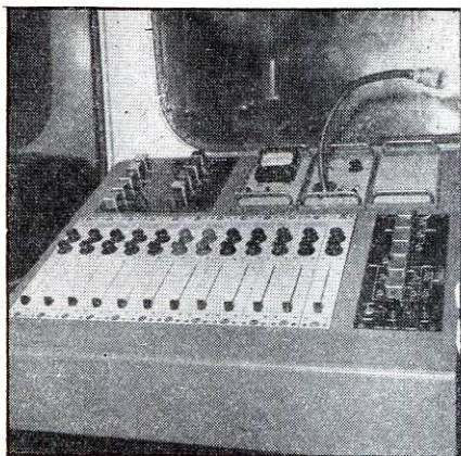
Fig. 3. — Le pupitre de commande comportant les répartiteurs, les réglages de niveaux, les 12 amplificateurs et le Vu-mètre.
