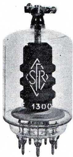
Deux tubes professionnels S.F.R. : le nouveau Carcinotron et la triode E 1300, à refroidissement naturel, pour chauffage H.F. (diélectrique et induction) jusqu'à 3 kW.
