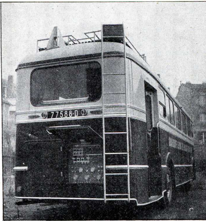
Fig. 1. — Le panneau de raccordement des câbles d'arrivée et de départ de la modulation et de la video-fréquence.
