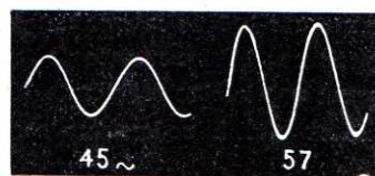
Fig. 26. — Puissance modulée 1 W. Le haut-parleur de 30 cm est monté dans un « Helmholtz Resonator » d'enceinte de 250 dm 3 , à parois bourrées de sable sec. La forme d'onde du rayonnement frontal est ici la meilleure de toutes celles enregistrées lors de nos expériences. Incidemment, c'est dans cette enceinte que le haut-parleur donne les meilleurs résultats subjectifs au-dessous de 60 Hz.
