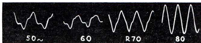
Fig. 23. — Puissance modulée 1 W. Le haut-parleur de 30 cm est monté sur le baffle plan (75×90 cm) placé dans une encoignure du local d'écoute. On remarquera que la forme d'onde aux environs de 50 Hz est plutôt meilleure à l'intérieur du local qu'en plein air. L'influence des déphasages et réflexions multiples est en dehors du cadre de cet article, mais il est bon de noter que ces phénomènes affectent notablement la tension de sortie du microphone suivant sa position.
