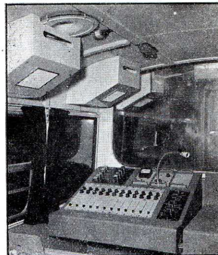
Fig. 9. — Le pupitre de commande de l'opérateur de prise de son. Au-dessus, les haut-parleurs de contrôle de la modulation.
